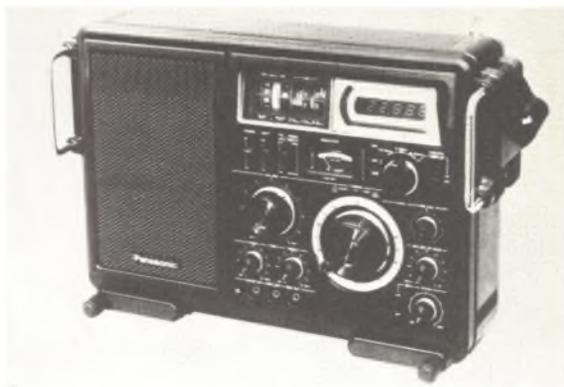
Il ricevitore portatile a transistori mod. RF-2800, prodotto dalla Panasonic, fornisce una copertura continua delle bande delle onde corte da 3,2 MHz a 30 MHz, su cinque diverse gamme commutabili; esso riceve inoltre le bande delle radiodiffusioni in MA ed in MF.
