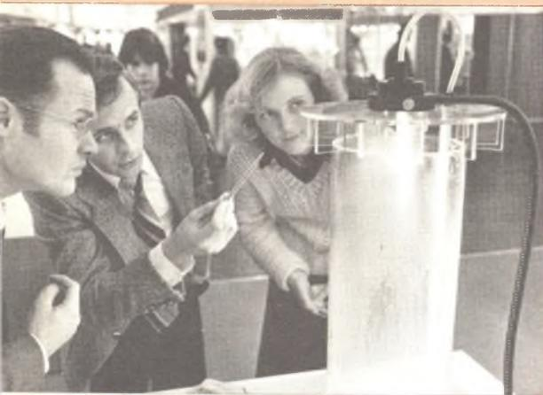
Nebulizzatori piezoceramici prodotti dalla Siemens sono in grado di dissolvere liquidi di ogni genere in una nebbia finissima, purché la loro viscosità non sia superiore ad un certo valore. Il modello visibile nella foto dissolve l'acqua in una pioggia così fine che solo dopo lungo tempo comincia a notarsi la formazione di goccioline sulle pareti di un recipiente di vetro.
