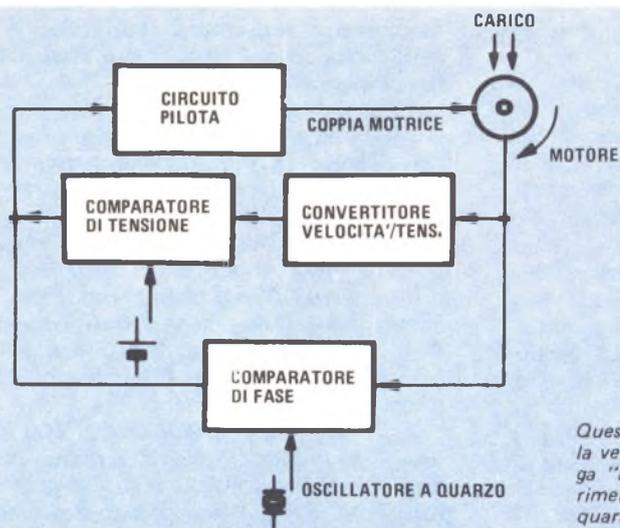
Questo schema a blocchi mostra come la velocità di rotazione del motore venga "agganciata" alla frequenza di riferimento generata da un oscillatore a quarzo.
