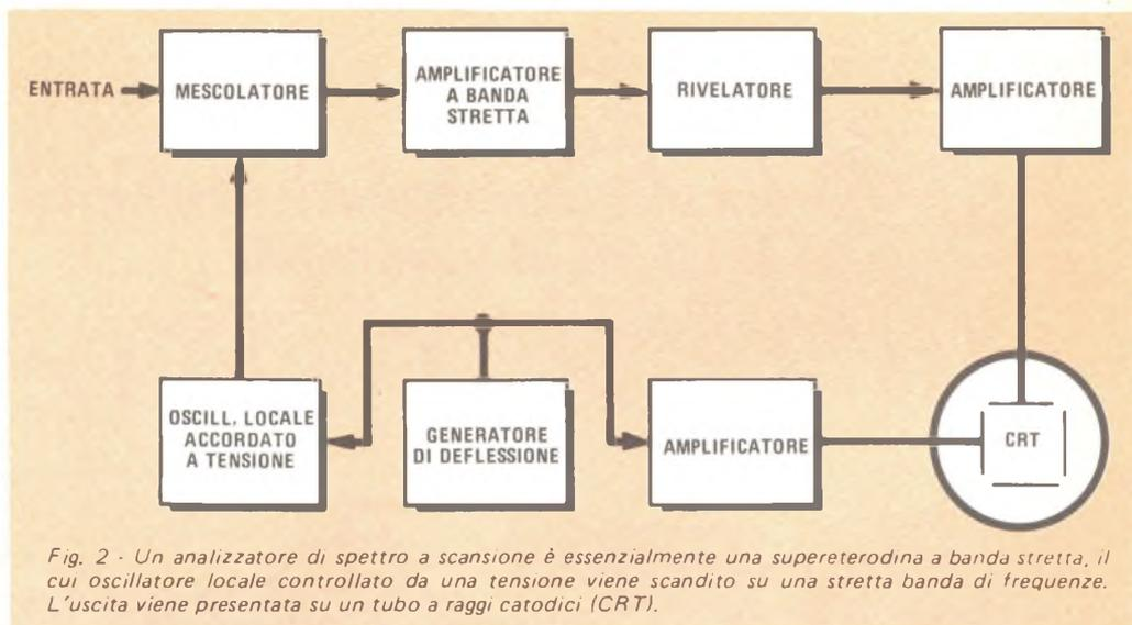
Fig. 2 - Un analizzatore di spettro a scansione è essenzialmente una supereterodina a banda stretta, il cui oscillatore locale controllato da una tensione viene scandito su una stretta banda di frequenze. L'uscita viene presentata su un tubo a raggi catodici (CRT).
