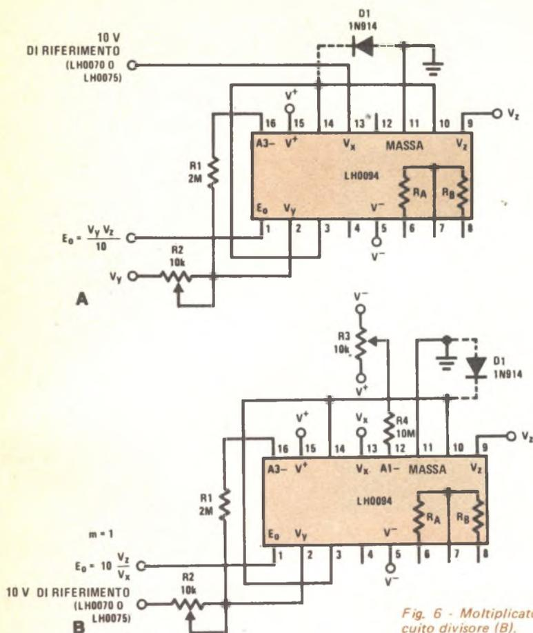
Fig. 6 - Moltiplicatore di precisione (A) e circuito dividente (B).
