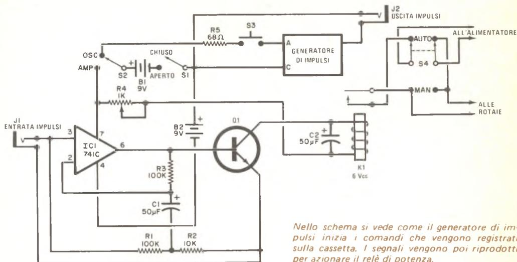
*Nello schema si vede come il generatore di impulsi inizia i comandi che vengono registrati sulla cassetta. I segnali vengono poi riprodotti per azionare il relè di potenza.*
