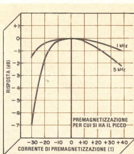
Fig. 1 - Il massimo più acuto che si ottiene lavorando con 5 kHz rende più definito il livello ottimo di premagnetizzazione; questa frequenza è perciò conveniente per regolare la premagnetizzazione.
