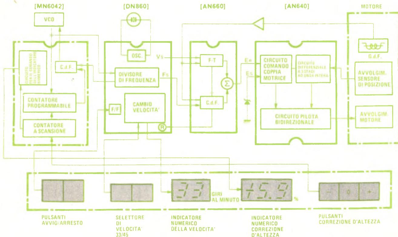
*I principali componenti circuitali del sistema ad aggancio di fase sono contenuti in quattro circuiti integrati. In questo schema a blocchi sono mostrati anche il motore a trazione diretta e l'insieme dei comandi e degli indicatori.*
