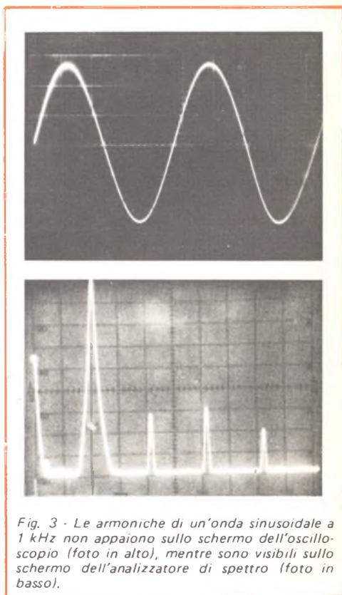
*Fig. 3 - Le armoniche di un'onda sinusoidale a 1 kHz non appaiono sullo schermo dell'oscilloscopio (foto in alto), mentre sono visibili sullo schermo dell'analizzatore di spettro (foto in basso).*
