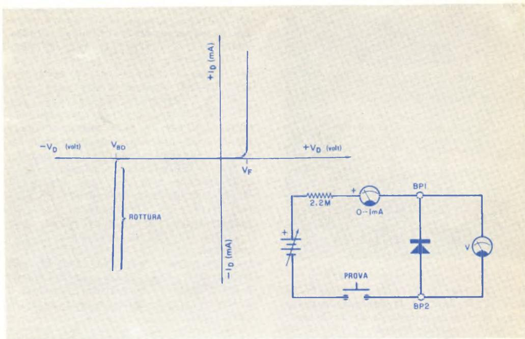
sua tensione inversa di picco (PIV), che specifica la tensione inversa che il diodo può sopportare senza condurre a valanga. I diodi previsti come raddrizzatori di potenza hanno generalmente una PIV caratteristica maggiore di 50 V; alcuni vengono specificati a 1.000 V o più. I diodi al silicio di commutazione e di segnale invece hanno valori di PIV inferiori, dell'ordine di circa 35 V.
