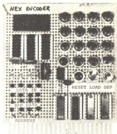
Sul numero di Radiorama di marzo del corrente anno, a pag. 34, è stato descritto un codificatore esadecimale a tastiera, progettato con un multiplexer 1 di 16 tipo 74150. Quel codificatore può essere usato per caricare gruppi di 4 bit in una linea di microcomputer a 4 bit e per scrivere dati in una RAM a 4 bit come il tipo TTL 7489. Questo circuito integrato è stato descritto ampiamente negli articoli di luglio/agosto e di ottobre 1979, rispettivamente a pag. 37 ed a pag. 33.
