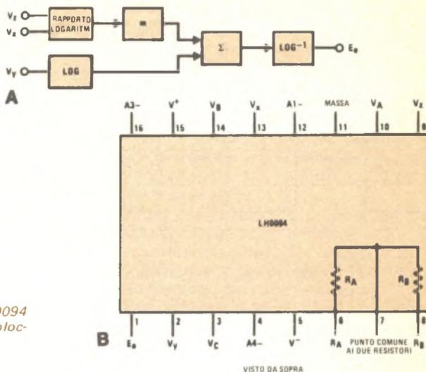
Fig. 5 - Convertitore a molte funzioni LH0094 della National: (A) schema funzionale a blocchi; (B) collegamenti ai piedini.
