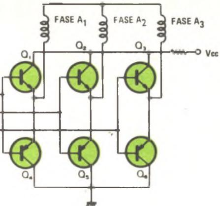
*Il circuito pilota bidirezionale, contenuto nel circuito integrato AN640, fornisce il segnale a due file di sensori di posizione (A). La commutazione indirizza la corrente su due diversi gruppi di avvolgimenti del motore (B) in modo da realizzare un comando ad onda intera e quindi quasi uniforme.*
