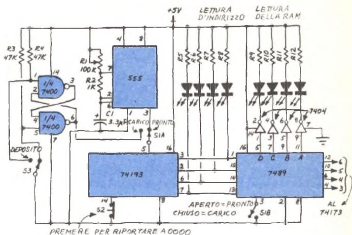
del gruppo finale, il commutatore di "Deposito" non viene più commutato; si porta invece S1 nella posizione "Pronto": ciò conserva i dati nell'indirizzo 1111 ed evita che sul gruppo dell'indirizzo 0000 vengano inavvertitamente trascritti i dati dell'indirizzo 1111.
