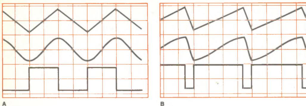
Fig. 3 - Tipiche forme d'onda con cicli di lavoro del 50% (A) e dell'80% (B).
