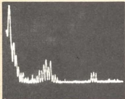
Fig. 8 - Analisi di un sintonizzatore MF con segnale di modulazione di 1 kHz: sono visibili le armoniche, la portante a 19 kHz, ed il segnale a 38 kHz.
