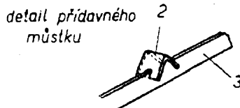
Obr. 61. Umístění klávesových kontaktů a ladicích potenciometrických trimrů pod příklopkou akordeonu. 1 – klávesové kontakty, 2 – hliníkový můstek (dosedá na spodní kontaktní pružinu a při stisknutí klávesy ji stlačí nahoru), 3 – rameno klapky, 4 – klapky jazýčků, 5 – držák kontaktní lišty, 6 – pertinaxové pásy, 7 – hliníkový nosník profilu U, 8 – šrouby, 9 – ladicí potenciometrické trimry, 10 – příklopka nástroje, 11 – klávesnice, 12 – tělo nástroje
