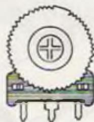
TRIM - POT USADO NO AJUSTE DO RECEPTOR
