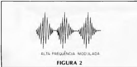
Em rádio controle utiliza-se um sistema de diversos canais em que o sinal do transmissor é modulado por sinais de frequências mais baixas porém diferentes. Cada sinal corresponde então a um tom, geralmente entre 100 e 2000Hz, que depois de recebido no objeto controlado pode ser separado para acionar dispositivos diferentes.
