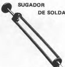
A ferramenta do técnico moderno. Imprescindível na remoção e substituição de qualquer componente eletrônico.
