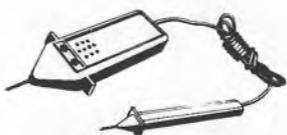
Teste voltagem e continuidade. Ele testa se o componente está bom ou não. Se estiver bom ele emite um zumbido.
