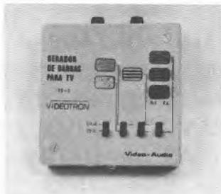
Para testes, ajustes e rápida localização de defeitos em aparelhos de TV em cores e preto e branco, desde o seletor de canais, F.I. (som e vídeo), amplificadores de vídeo e som, ajuste de convergência, foco, linearidade, etc. O único aparelho que permite o teste direto no estúdio e no componente defeituoso.
