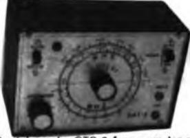
O minigerador GST-2 é um gerador e injetor de sinais completo, projetado para ser usado em rádio, FM e TV em cores (circuito de crominância). Seu manejo fácil e rápido, aliado ao pequeno tamanho, permite considerável economia de tempo na operação de calibragem e injeção de sinais frequências.
