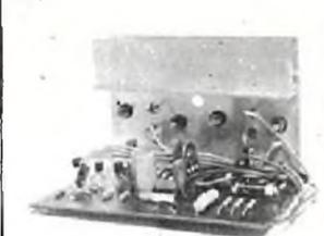
Características: Potência 50 a 130 watts RMS; Pot. 100 a 220 watts; Pot. Musical 65 a 180 watts, sensível. 900mW RMS; Sinal áudio maior que 80db; Resposta em frequência 20 a 80 KHz; Dist. Harm. Inf. a 0,07%; Imp. Entrada 27k, Imp. Saída 8 ohms. Alimentação: 30 + 30 volts com 3,5A de corrente. Não acompanha Fonte.
