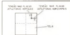
Fig. 12 — Combinando tensões em X e Y.
