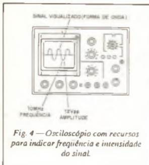
Fig. 4 — Osciloscópio com recursos para indicar frequência e intensidade do sinal.
