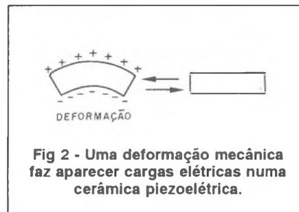
Fig 2 - Uma deformação mecânica faz aparecer cargas elétricas numa cerâmica piezoelétrica.
