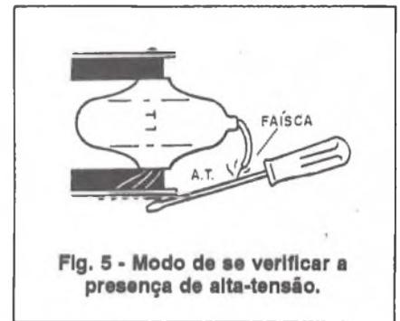
Fig. 5 - Modo de se verificar a presença de alta-tensão.
