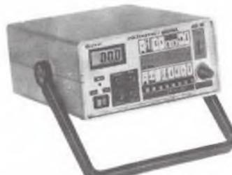
Tensão c.c. 1000 V - precisão 1%, tensão c.a. - 750 V, resistores 20 MΩ, Corrente c.c./c.a. - 20 A, ganho de transistores hfe, diodos. Ajuste de zero externo para medir com alta precisão valores abaixo de 20 Ω.
