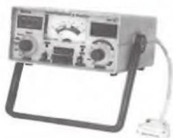
Permite verificar a emissão de cada canhão do cinescópio em prova e reativá-lo, possui galvanômetro com precisão de 1% e mede MAT até 30 kV.
