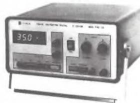
Fonte digital continuamente variável de 0 a 35 V, corrente máx. de saída 2 A, proteção sobrecarga. Voltímetro eletrônico de 0,1-1000 Vc.c/ impedância de entrada 10 MΩ, precisão de 1%.
