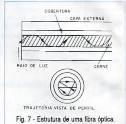
Fig. 7 - Estrutura de uma fibra óptica.
