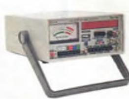
Possui sete instrumentos em um: freqüencímetro até 100 MHz, gerador de barras, saída de FI 45 75 MHz, Conversor de videocassete, teste de cabeça de vídeo, rastreador de som, remoto.
