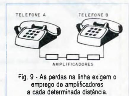
Fig. 9 - As perdas na linha exigem o emprego de amplificadores a cada determinada distância.
