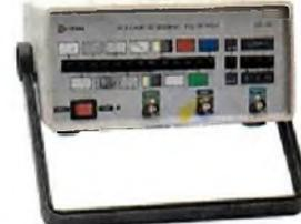
Gera padrões: círculo, pontos, quadriculas, círculo com quadriculas, linhas verticais, linhas horizontais, escala de cinzas, barras de cores, cores cortadas, vermelho, verde, azul, branco, fase PALM/NTSC puros com cristal, saída de FI, saída de sincronismo, saída de RF canais 2 e 3.
