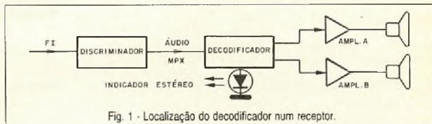
Fig. 1 - Localização do decodificador num receptor.
