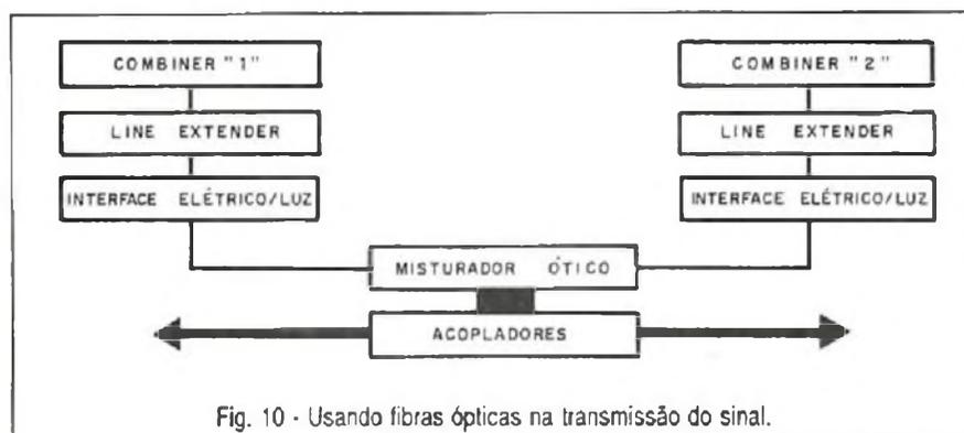
Fig. 10 - Usando fibras ópticas na transmissão do sinal.
