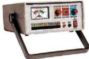
Mede FLYBACK/YOKE estático quando se tem acesso ao enrolamento. Mede FLYBACK encapsulado através de uma ponta MAT. Mede capacitores eletrolíticos no circuito e VPP.....
