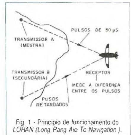
Fig. 1 - Princípio de funcionamento do LORAN (Long Rang Aio To Navigation ).
