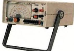
Sete escalas de frequências: A -100 a 250 kHz, B -250 a 650 kHz, C - 650 a 1700 kHz, D -1, 7 a 4 MHz, E - 4 a 10 MHz, F - 10 a 30 MHz, G - 85 a 120 MHz, modulação interna e externa.
