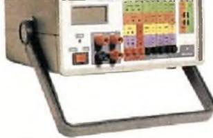
Tensão c.c. 1000V - precisão 0,5 %, tensão c.a. 750V, resistores 20 MΩ, corrente DC AC - 10A ganho de transistores, hfe, diodos. Mede capacitores nas escalas 2n, 20n, 200n, 2000n, 20µF.
