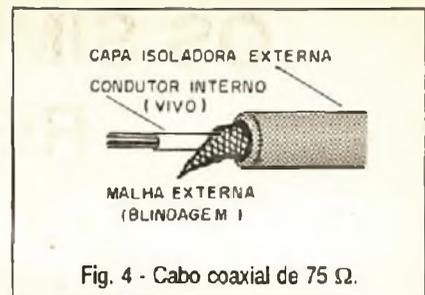
Fig. 4 - Cabo coaxial de 75 Ω.
