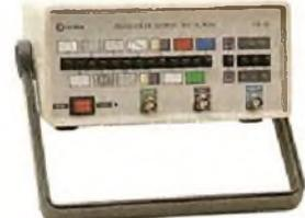
Gera padrões: círculo, pontos, quadrículas, círculo com quadrículas, linhas verticais, linhas horizontais, escala de cinzas, barras de cores, cores cortadas, vermelho, verde, azul, branco, fase. PAL/NTSC puros com cristal, saída de FI, saída de sincronismo, saída de RF canais 2 e 3.
