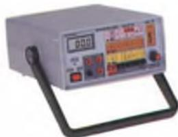
Tensão c.c. 1000 V - precisão 1%, tensão c.a. - 750 V, resistores 20 M $\Omega$ , Corrente c.c./c.a. - 20 A ganho de transistores hfe, diodos. Ajuste de zero externo para medir com alta precisão valores abaixo de 20  $\Omega$ .
