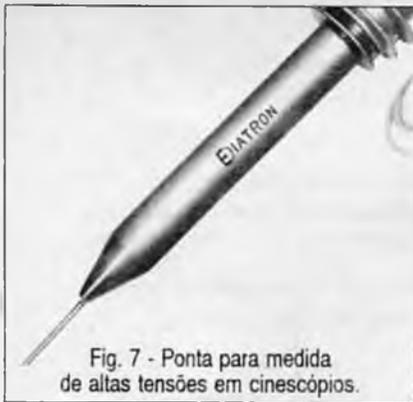
Fig. 7 - Ponta para medida de altas tensões em cinescópios.
