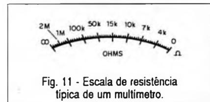
Fig. 11 - Escala de resistência típica de um multímetro.
