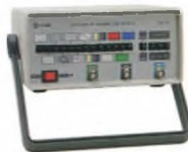
Gera padrões: círculo, pontos, quadrículas, círculo com quadrículas, linhas verticais, linhas horizontais, escala de cinzas, barras de cores, cores cortadas, vermelho, verde, azul, branco, fase PALM/NTSC puros com cristal, saída de FI, saída de sincronismo, saída de RF canais 2 e 3.
