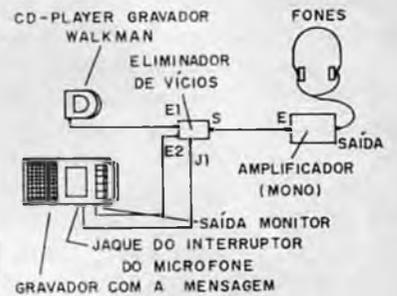
Fig. 8 - Ligação do aparelho aos periféricos.
