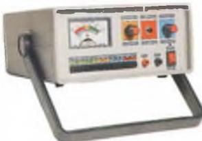
Mede FLYBACK/YOKE estático quando se tem acesso ao enrolamento. Mede FLYBACK encapsulado através de uma ponta MAT. Mede capacitores eletrolíticos no circuito e VPP.....
