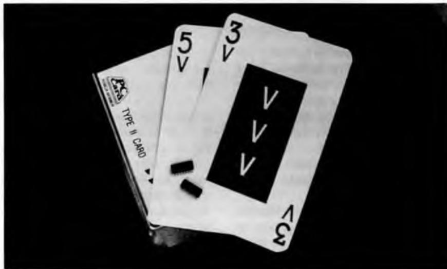
O Si9712DY da Siliconix, Interface Switch, apresenta a menor solução para montagem em superfície de sistemas de interfaceamento entre PC cards e computadores portáteis, *sub-notebooks* e *palmtops*.
