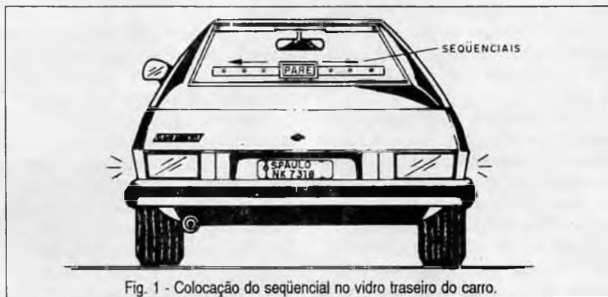
Fig. 1 - Colocação do seqüencial no vidro traseiro do carro.
