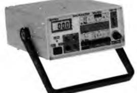
Tensão c.c. 1000 V - precisão 1%, tensão c.a. - 750 V, resistores 20 MΩ, Corrente c.c./c.a. - 20 A ganho de transistores hfe, diodos. Ajuste de zero externo para medir com alta precisão valores abaixo de 20 Ω.
