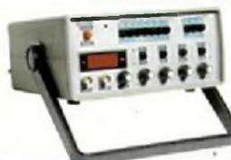
Ótima estabilidade e precisão, p/ gerar formas de onda: senoidal, quadrada, triangular, faixas de 0,2 Hz a 2 MHz. Saídas VCF, TTL/MOS, aten. 20 dB.
