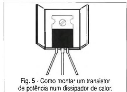
Fig. 5 - Como montar um transistor de potência num dissipador de calor.
