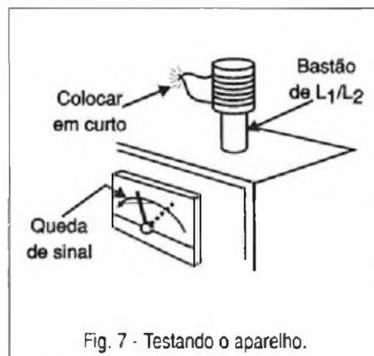
Fig. 7 - Testando o aparelho.
