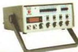
Ótima estabilidade e precisão, p/ gerar formas de onda: senoidal, quadrada, triangular, faixas de 0,2 Hz a 2 MHz. Saídas VCF, TTL/MOS, aten. 20 dB. GF39 ..... R\$ 390,00
