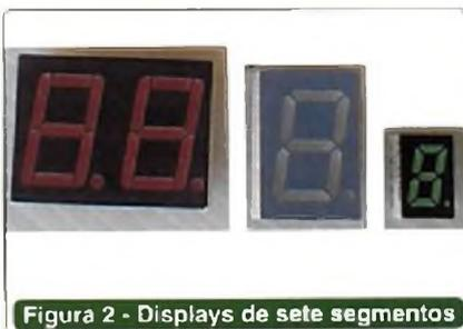
Figura 2 - Displays de sete segmentos
