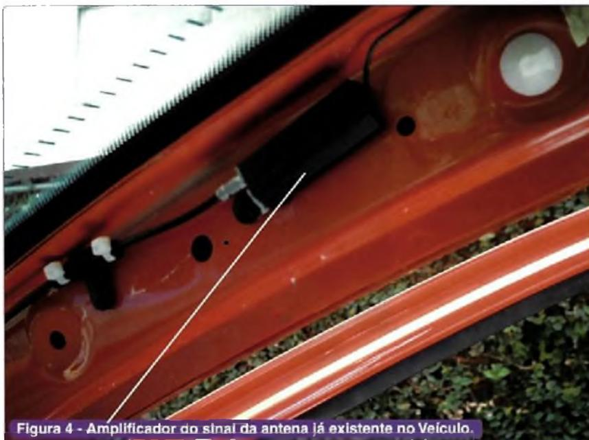
Figura 4 - Amplificador do sinal da antena já existente no Veículo.
