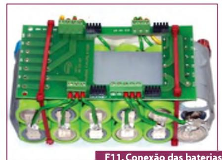
F11. Conexão das baterias formando um bloco.
