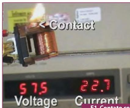
**F1.** Contato com 60V/22A de carga.
