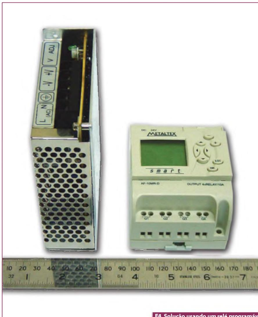
F4. Solução usando um relé programável e uma fonte de alimentação.
