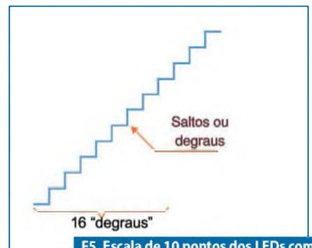
F5. Escala de 10 pontos dos LEDs com representação por 4 bits.
