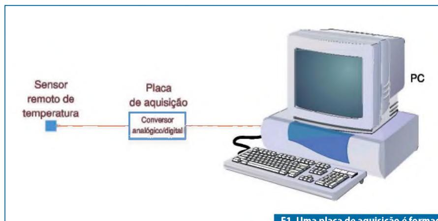
**F1.** Uma placa de aquisição é formada basicamente por conversores A/D.
