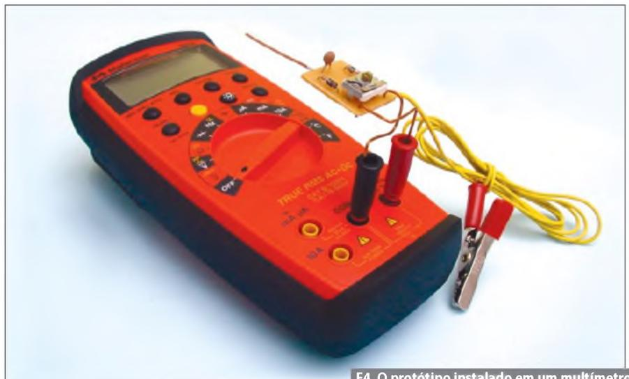
F4. O protótipo instalado em um multímetro modelo 38 XR, da Meterrmann.
