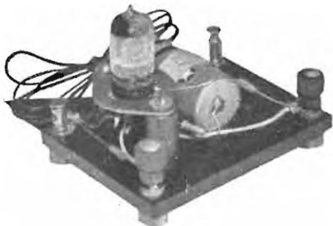
La messa a punto di un amplificatore di BF mediante un segnale ad onda quadra costituisce il metodo migliore e più rapido per determinare la risposta di frequenza, gli sfasamenti, le oscillazioni, ecc.
