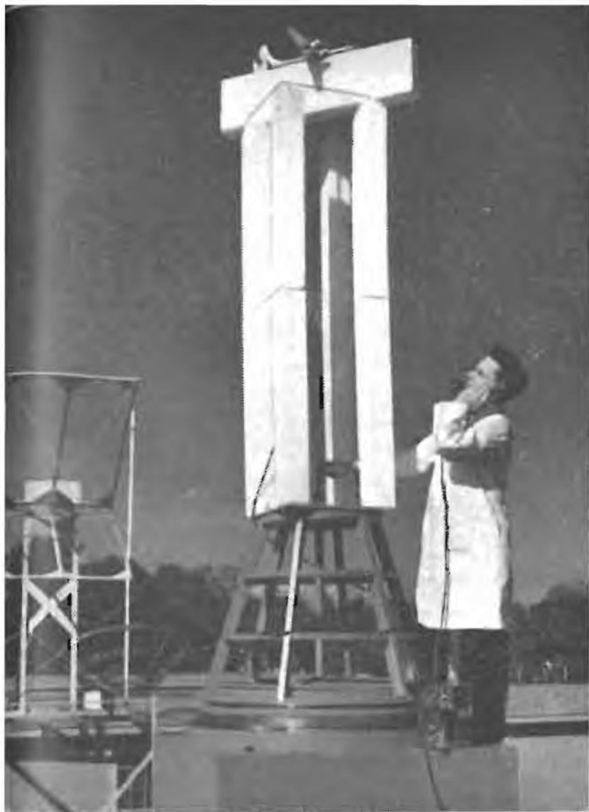
L'ing. Richard M. Hatch, Jr. sta ultimando la messa a punto del dispositivo per il tracciamento automatico del diagramma di irradiazione.
