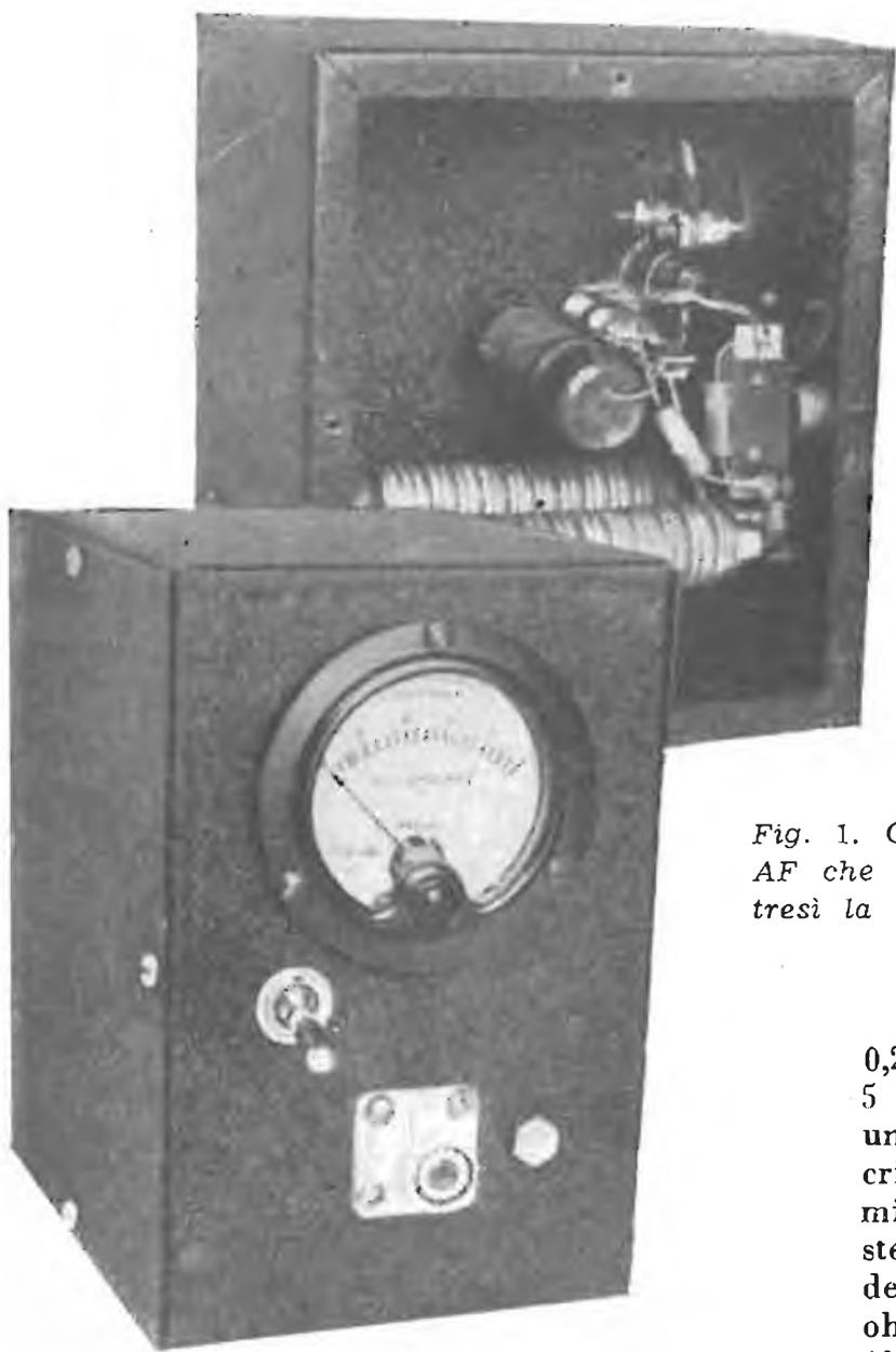
Fig. 1. Come si presenta il semplice wattmetro per AF che si descrive in questo articolo. E' visibile altresì la disposizione interna dei componenti.
