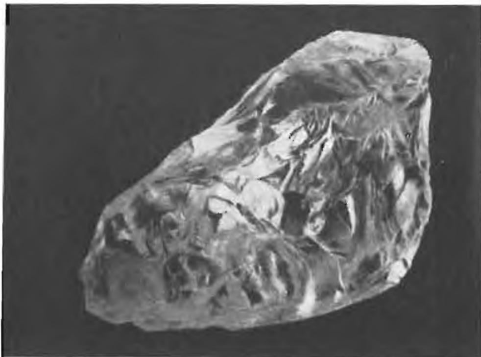
L'effetto piezoelettrico diretto fu scoperto nel 1880 dai coniugi Curie i quali osservarono come un cristallo di quarzo sottoposto a pressione secondo certe direzioni si caricava di elettricità. Successivamente Lipmann scoprì l'effetto piezoelettrico inverso constatando che un cristallo di quarzo si deformava se ad esso si applicava una d.d.p.
