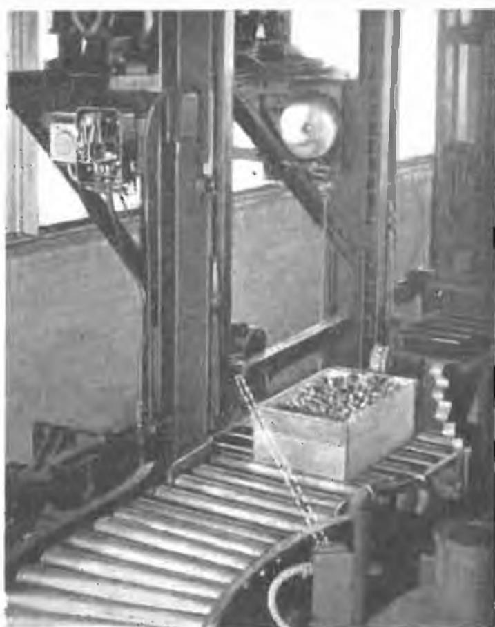
*Un altro esempio di comando di posizione di costruzione General Electric Co. Si tratta di portare una cassetta in una determinata posizione perchè venga riempita. Ultimata l'operazione di riempimento la cassetta riprende il cammino.*
