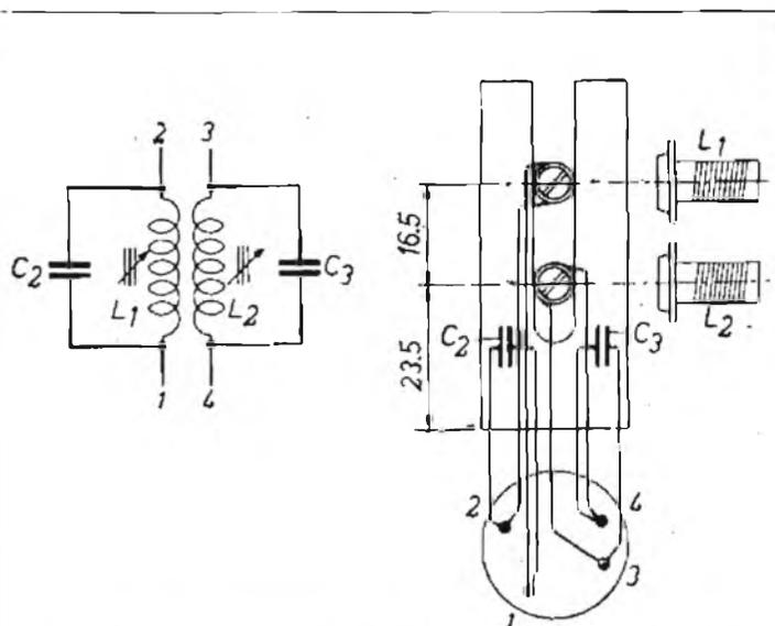
Particolari costruttivi del trasformatore d'antenna.
