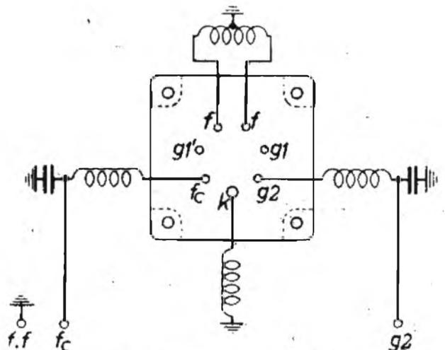
Fig. 5 - La figura illustra i disaccoppiamenti consigliati per la valvola amplificatrice di AF.
