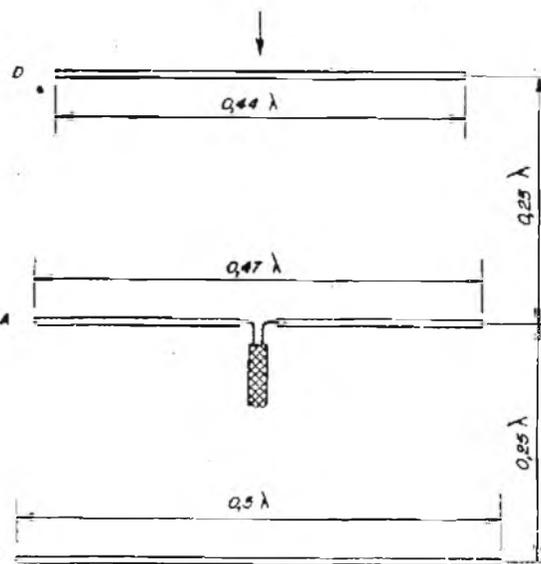
Fig. 6 - Tipico esempio di antenna direttiva, costituita da un elemento direttore (D), un elemento radiante (A) e un elemento riflettore (P). Quest'antenna, oltre ad aumentare il guadagno, consente di diminuire notevolmente i parassiti e le interferenze.
