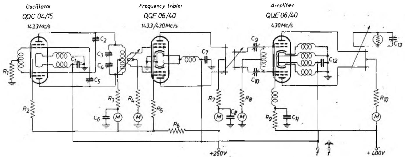
Fig. 1 - Circuito elettrico del trasmettitore descritto.
