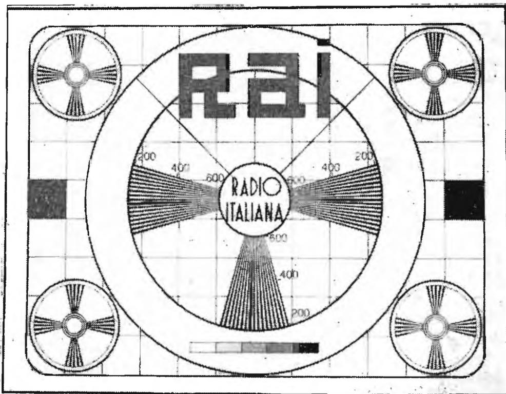
Il monoscopio impiegato dalla Radio Italiana per le sue trasmissioni televisive. Il monoscopio, oltre a servire al riconoscimento della stazione trasmittente, ha lo scopo di permettere la regolazione dei comandi del televisore, come è dettagliatamente spiegato a pag. 23.
