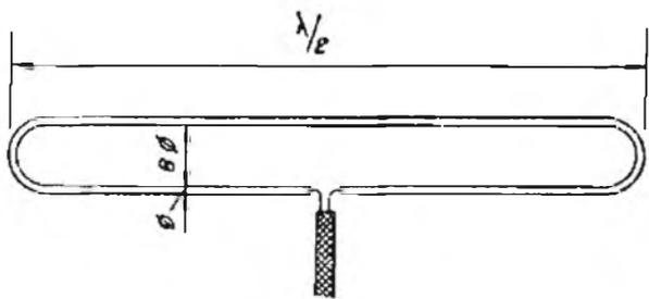
Fig. 5 - L'antenna trombone, detta anche folded dipole, o dipolo ripiegato ha la forma illustrata in figura. La sua impedenza al centro è di 300 ohm e viene alimentata con una piattina.
