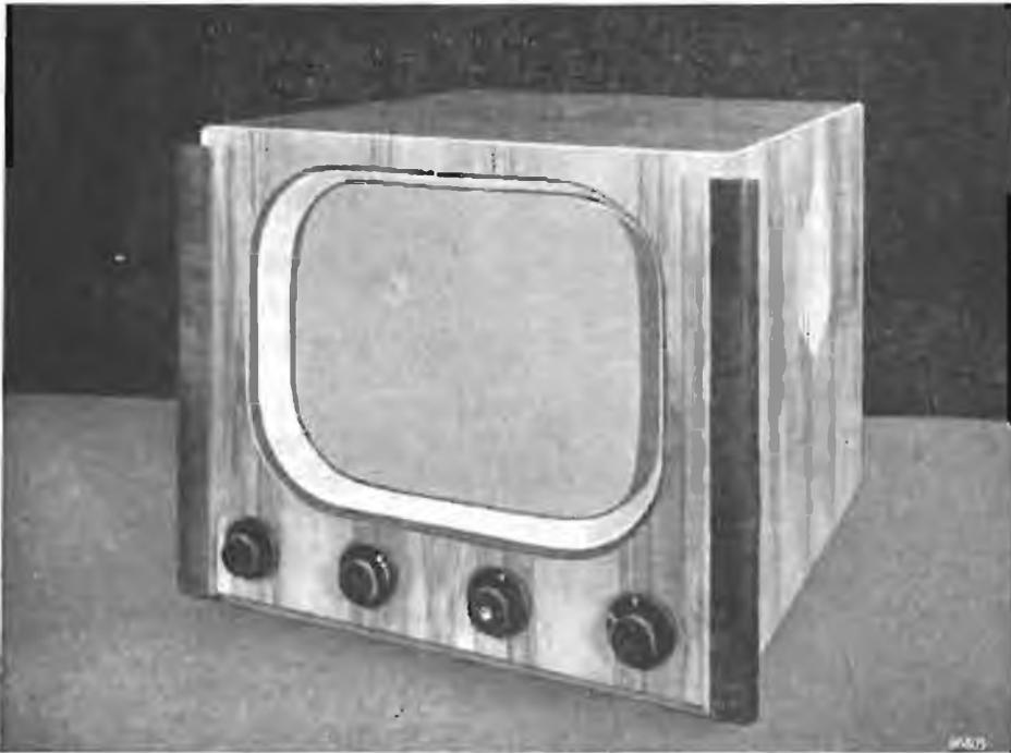
Il ricevitore di televisione che viene descritto impiega un tubo Philips MW36-22. Il mobile misura 45 cm di larghezza, 36 cm di altezza e 46 cm di profondità.
