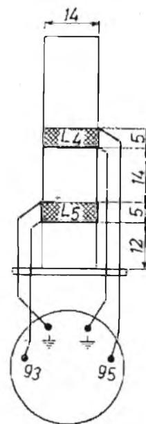
Particolari del trasformatore dell'oscillatore.
