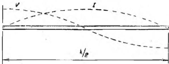
Fig. 1 - Distribuzione della tensione (E) e della corrente (I) in un'antenna lunga mezza onda.
