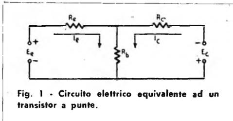
Fig. 1 - Circuito elettrico equivalente ad un transistor a punte.
