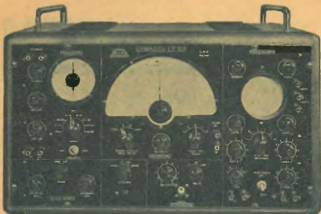
**Il Complesso per TV ed FM EP707** qui illustrato comprende un generatore modulato in frequenza (volutatore), un Calibratore (marker), un Generatore di barre ed un Oscilloscopio.
