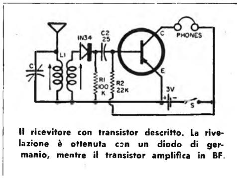
Il ricevitore con transistor descritto. La rivelazione è ottenuta con un diodo di germanio, mentre il transistor amplifica in BF.
