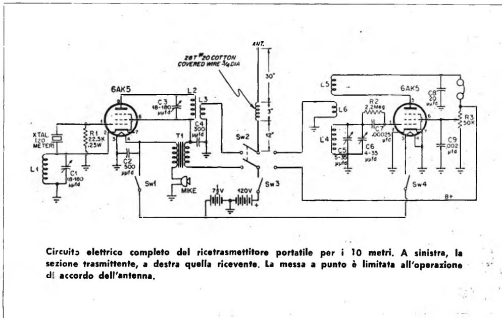
Circuito elettrico completo del ricetrasmittitore portatile per i 10 metri. A sinistra, la sezione trasmittente, a destra quella ricevente. La messa a punto è limitata all'operazione di accordo dell'antenna.
