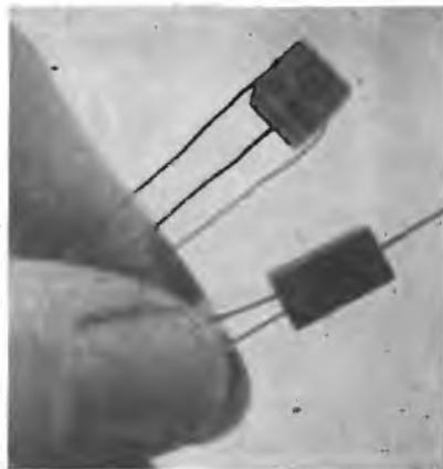
cuito o possano venire usati degli zoccoli a tre contatti. Poichè due terminali sono più ravvicinati (v. foto) è evitato il pericolo d'inversione di polarità: è questo lo standard proposto dallo JETEC.
