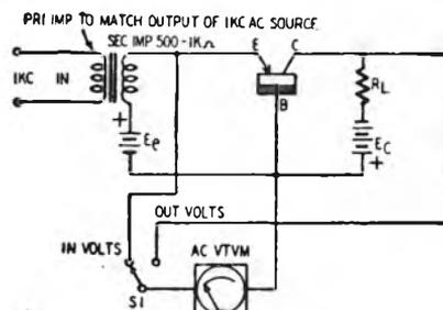
Fig. 4 - Circuito per la misura del guadagno in c.a. di un transistor.
