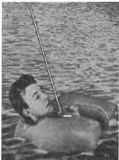
Per localizzare piloti di aerei caduti in mare e naufraghi, è stato costruito il « Sarah », minuscolo ricetrasmittitore, che emette per 20 ore un segnale impulsivo di circa 16 watt, che può essere ricevuto ad oltre 100 km di distanza da un aereo che voli a 3.000 m di altezza. L'apparecchio può su piccole distanze funzionare anche da radiotelefono.
