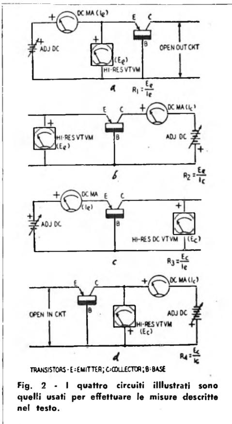
Fig. 2 - I quattro circuiti illustrati sono quelli usati per effettuare le misure descritte nel testo.
