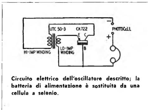
Circuito elettrico dell'oscillatore descritto; la batteria di alimentazione è sostituita da una cellula a selenio.
