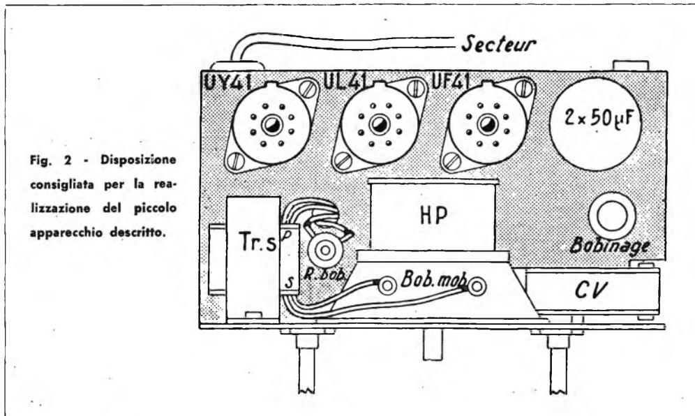
Fig. 2 - Disposizione consigliata per la realizzazione del piccolo apparecchio descritto.
