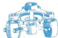
DU2 - Giunto stellare per le terminazioni del traliccio e per il fissaggio dell'asta di sostegno dell'antenna. Questo giunto porta tre anelli atti all'ancoraggio dei controventi. Un dispositivo a cunei permette il fissaggio al centro di qualsiasi tubo da 20 a 35 mm o di un cuscinetto a sfere per la realizzazione di antenne rotative.
