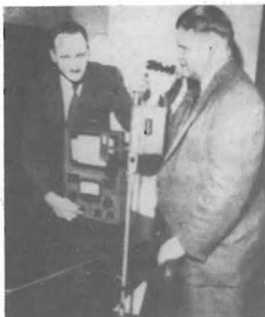
Un ispettore misura l'intensità di campo prodotta da questo trasmettitore impiegato per la guida dei ciechi, montato entro un bastone.
