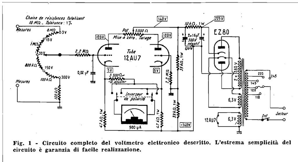
Fig. 1 - Circuito completo del voltmetro elettronico descritto. L'estrema semplicità del circuito è garanzia di facile realizzazione.
