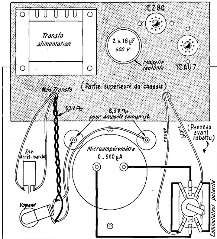
Fig. 3 - Disposizione dei componenti sulla parte superiore del chassis, col pannello frontale rappresentato abbattuto.
