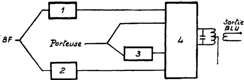
Fig. 5 - Sistema che sfrutta lo sfasamento per ottenere la soppressione di una banda laterale; 1) sfasamento  $+45^\circ$ ; 2) sfasamento  $-45^\circ$ ; 3) sfasamento  $90^\circ$ ; 4) modulatore bilanciato.
