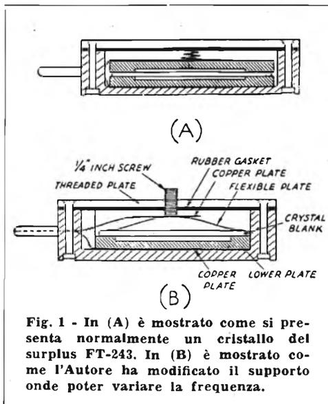
Fig. 1 - In (A) è mostrato come si presenta normalmente un cristallo del surplus FT-243. In (B) è mostrato come l'Autore ha modificato il supporto onde poter variare la frequenza.
