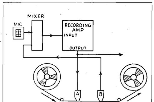
Fig. 1 - L'eco è ottenuta inviando indietro il segnale registrato sul nastro ed applicandolo nuovamente all'amplificatore di registrazione. A è la testa registratrice e B quella lettrice.
