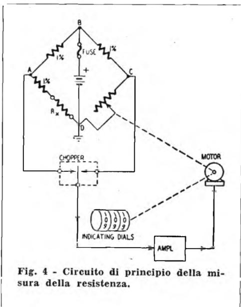
**Fig. 4 - Circuito di principio della misura della resistenza.**
