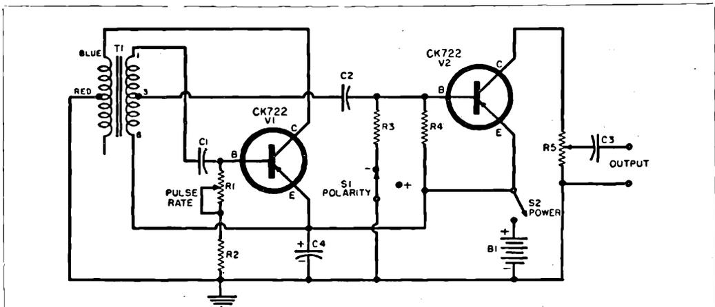
Fig. 1 - Circuito completo del generatore di impulsi transistorizzato.
