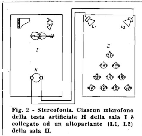
Fig. 2 - Stereofonia. Ciascun microfono della testa artificiale H della sala I è collegato ad un altoparlante (L1, L2) della sala II.
