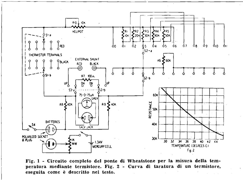
Fig. 1 - Circuito completo del ponte di Wheatstone per la misura della temperatura mediante termistore. Fig. 2 - Curva di taratura di un termistore, eseguita come è descritto nel testo.
