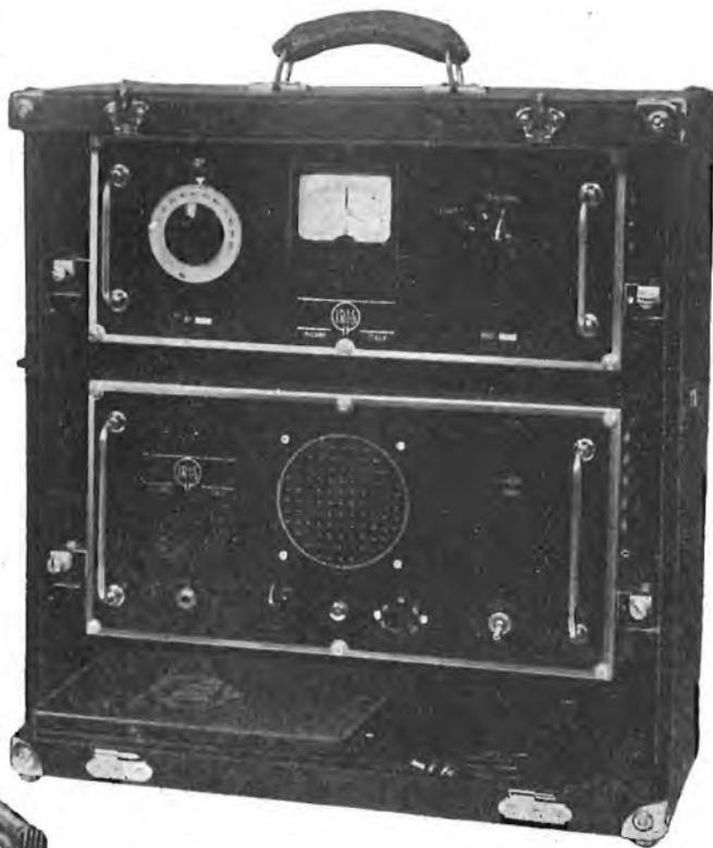
L'equipaggiamento di ricezione a distanza è costituito da una speciale valigia che contiene il ricevitore « Ricemike ». Questo ricevitore, appositamente progettato è dotato di altissima sensibilità, in modo da captare il segnale del « Telemike » su un'area piuttosto vasta. L'uscita del ricevitore può essere inviata a qualsiasi impianto di amplificazione.
