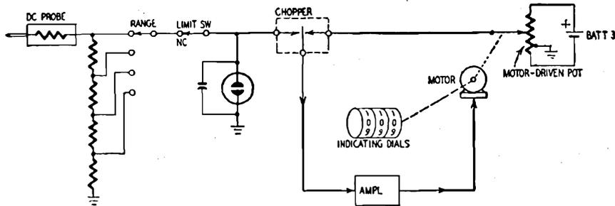
Fig. 2 - Circuito semplificato dal dispositivo di misura delle tensioni c. c.
