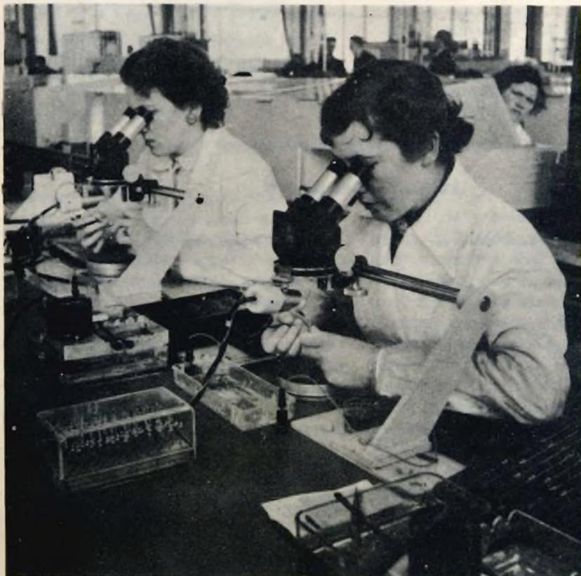
Fissaggio dei terminali in un transistor di bassa frequenza (da Philips).
