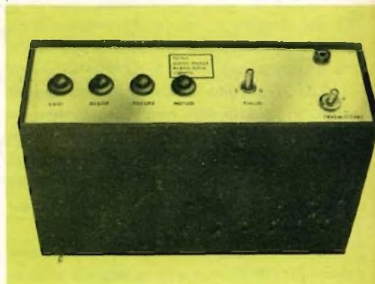
Fig. 2 - La trasmettente. Notare in basso a destra i fori per la regolazione dei cinque potenziometri.
