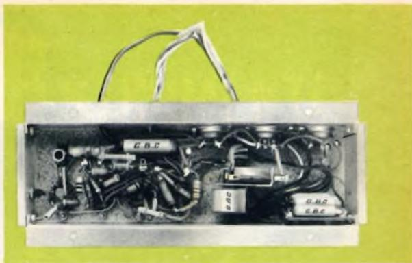
Fig. 7 - La ricevente vista dal di sotto. Al centro il banco a lamelle vibranti, e sulla destra in basso i cinque condensatori da 5 µF.
