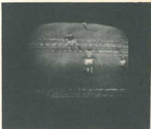
Fig. 1 - Disturbo dovuto ad un campanello elettrico. Sullo schermo del televisore appaiono striscie sottili e punteggiate intermittenti.
