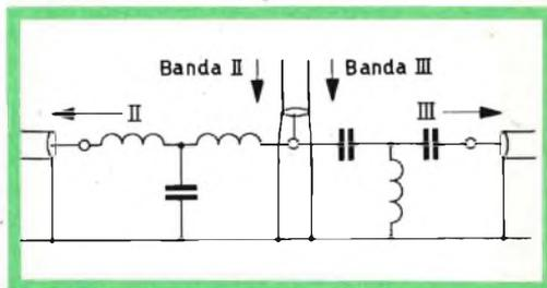
Fig. 7a - Filtri passa-basso e passa-alto impiegati per separare due segnali.
