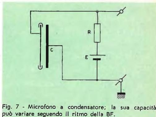
Fig. 7 - Microfono a condensatore; la sua capacità può variare seguendo il ritmo della BF.
