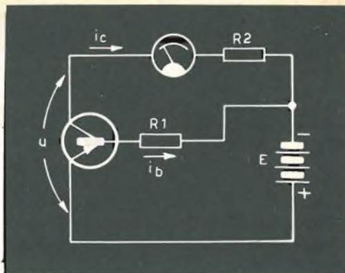
Fig. 4 - Per misurare il guadagno di corrente, si alimenta la base con la tensione  $E$  attraverso la resistenza nota  $R_1$  e si suppone trascurabile la tensione base-emettitore. La corrente di base è allora  $E/R_1$ .
