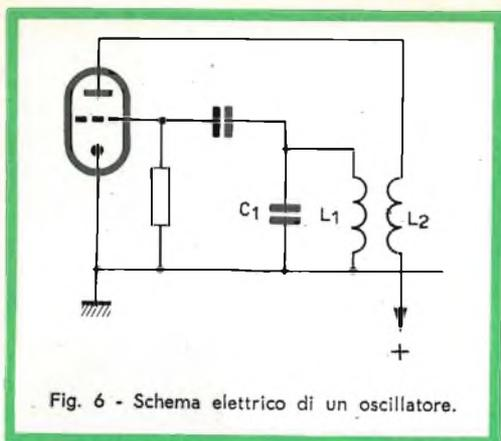
Fig. 6 - Schema elettrico di un oscillatore.
