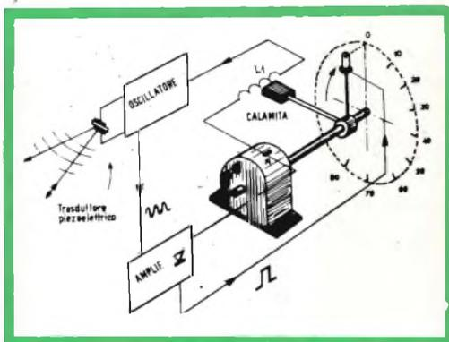
Fig. 1 - Asieme schematico e funzionale dell'ecosonda.
