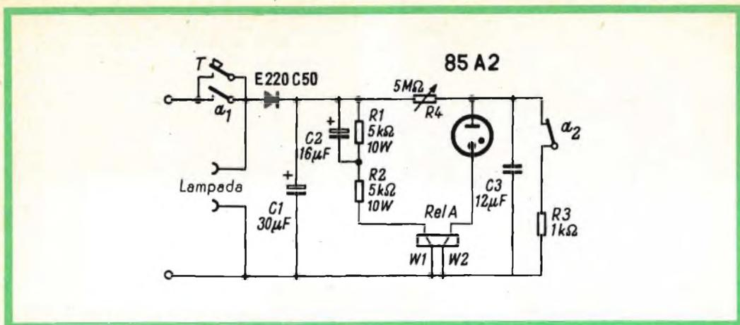
Fig. 7 - Circuito elettrico di un interruttore elettronico molto semplice.
