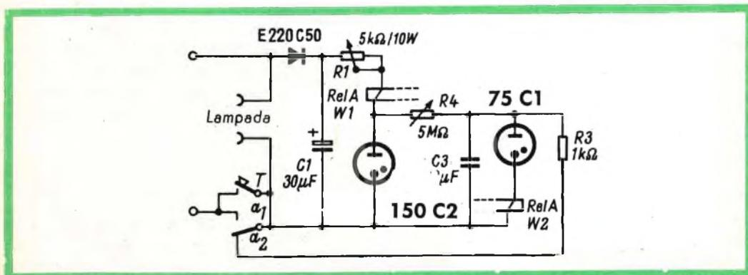
Fig. 8 - Circuito elettrico di un interruttore elettronico dove la tensione che alimenta la costante RC è stabilizzata.
