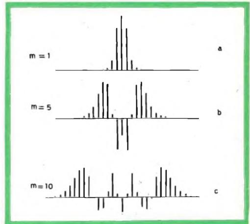
Fig. 9 - a), b), c) Rappresentazione delle bande laterali di una portante modulata in frequenza. Si può vedere come la gamma occupata dalle bande laterali è maggiore all'aumentare di  $m$ .
