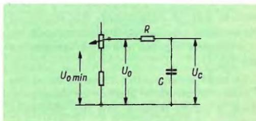
Fig. 3 - Circuito temporizzatore vero e proprio con indicazione dei simboli delle tensioni.
