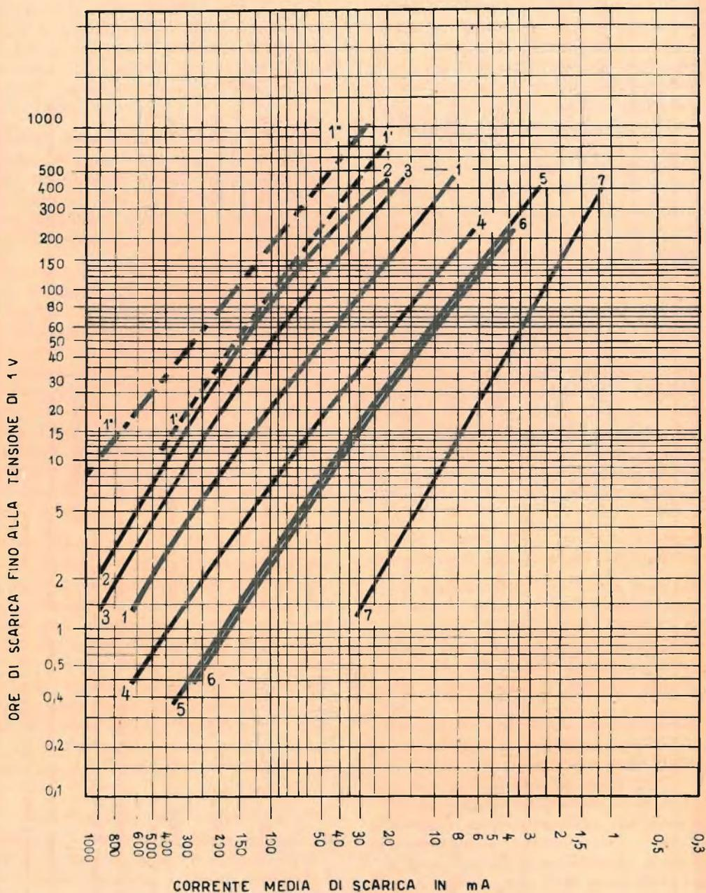
Fig. 4 - Diagramma della scarica in ore, di elementi di pile a secco di vari tipi e dimensioni, dalla tensione iniziale a vuoto, fino alla tensione di 1 V, in funzione della corrente media di scarica, corrispondente alla tensione media di 1,2 V per ciascun elemento sotto carico.
