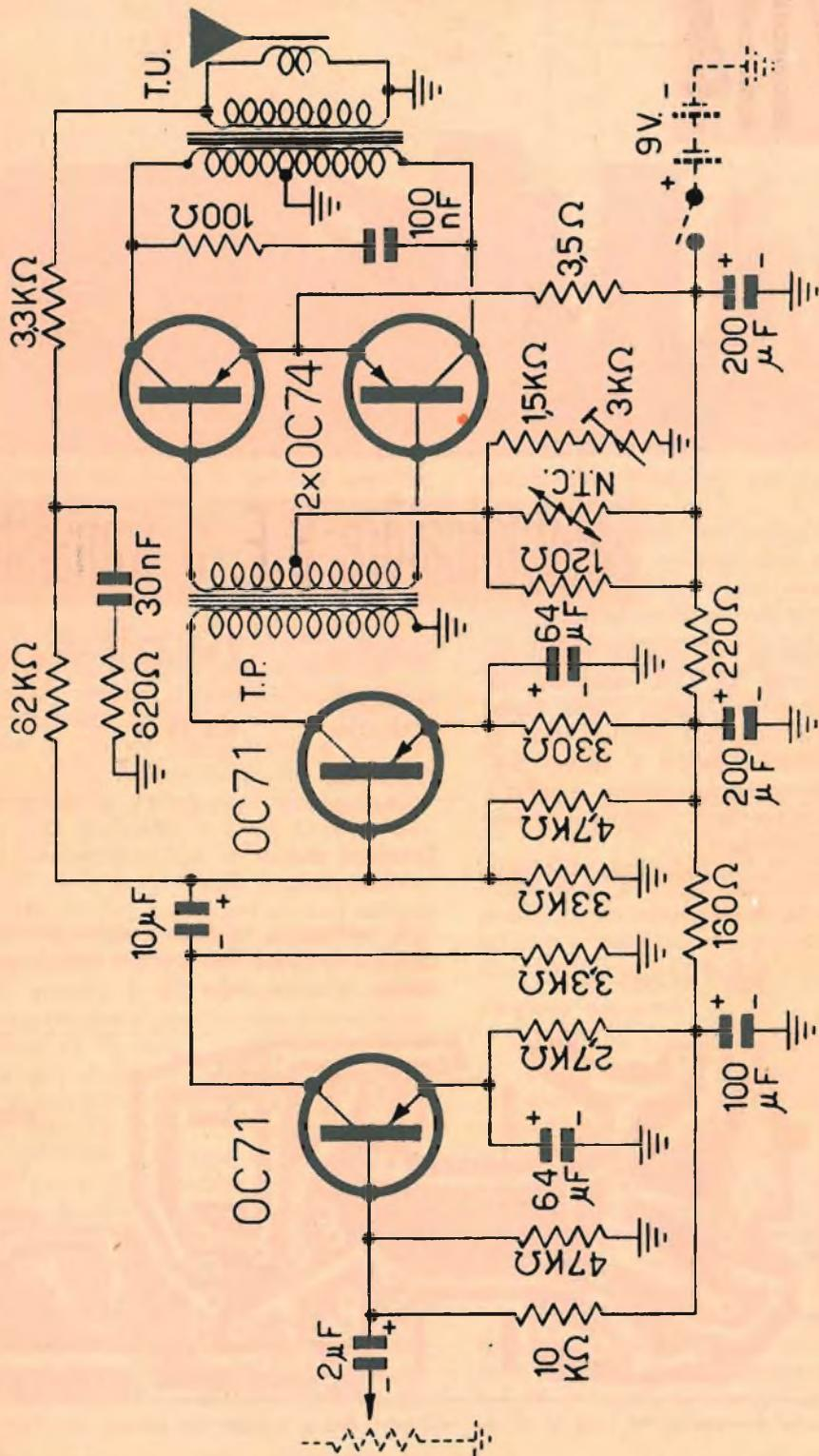
Fig. 2 - Schema elettrico dell'amplificatore TR/114.
