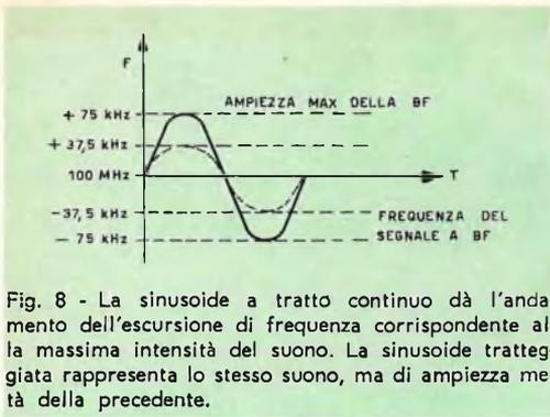
Fig. 8 - La sinusoide a tratto continuo dà l'andamento dell'escursione di frequenza corrispondente alla massima intensità del suono. La sinusoide tratteggiata rappresenta lo stesso suono, ma di ampiezza metà della precedente.
