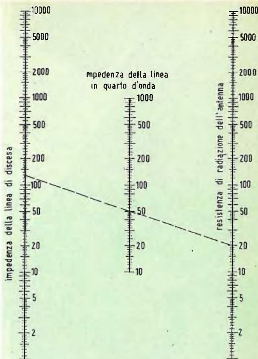
Fig. 7 - Nomogramma per il calcolo dell'impedenza di adattamento di una linea in quarto d'onda.
