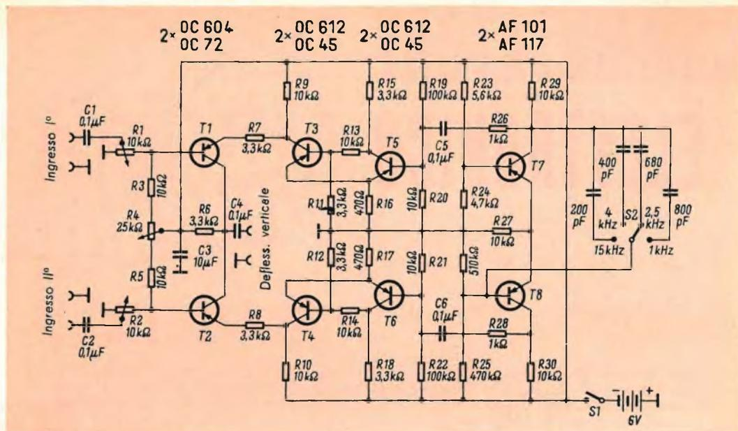
Fig. 1 - Schema elettrico del commutatore elettronico; con questo tipo di commutatore elettronico il pennello del tubo a raggi catodici "salta" da una curva all'altra.
