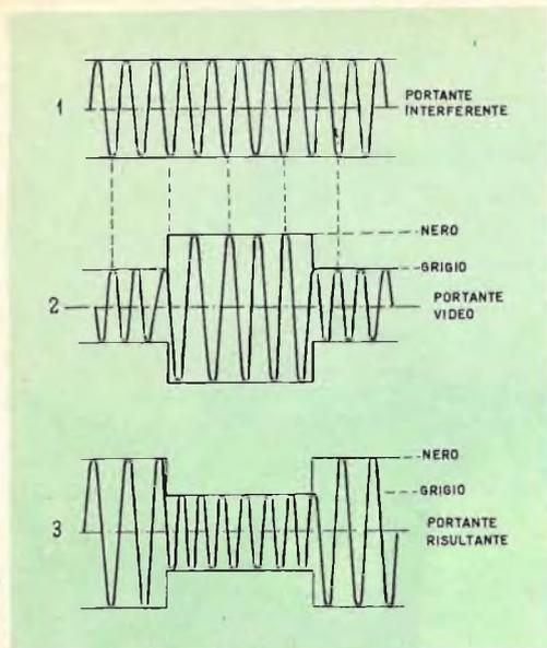
Fig. 1 - Dimostrazione del particolare fenomeno per cui l'immagine assume delle caratteristiche simili a quelle di un negativo fotografico: i segnali relativi al « bianco » producono sullo schermo delle zone nere e i segnali relativi al « nero » producono delle zone bianche.
