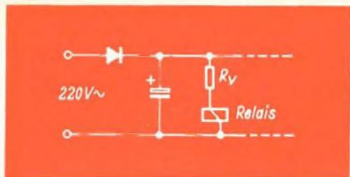
Fig. 4 - Circuito di alimentazione dell'interruttore elettronico.
