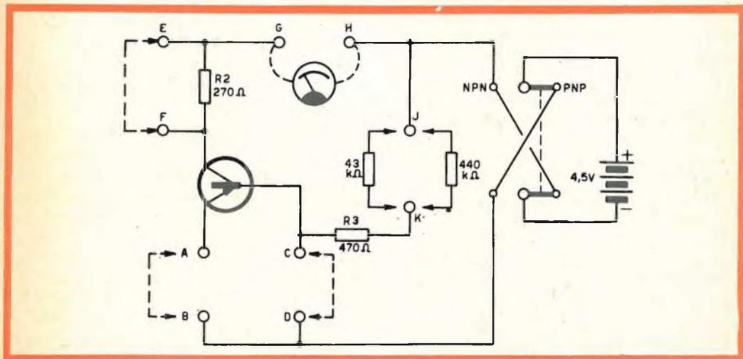
Fig. 5 - Schema del misuratore di transistor nella versione più semplice.
