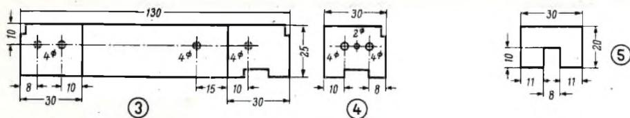
Fig. 4 - Dimensioni e foratura della piastra di rame per la camera schermante per il gruppo RF; 3 = foglio di rame prima della piegatura; 4 = piastra di rame per parete divisoria. 5 = Schermo per i supporti della valvola FI.
