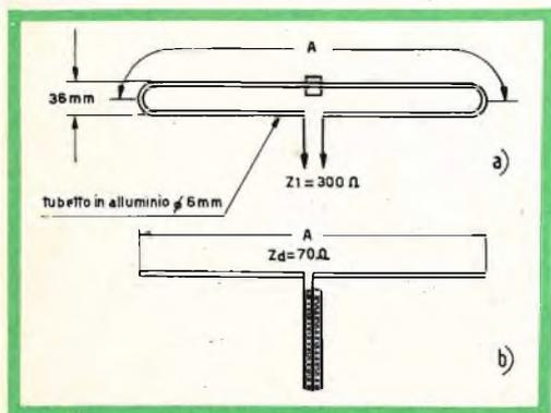
Fig. 6 - a) Dipolo ripiegato con discesa a  $300 \Omega$ .
