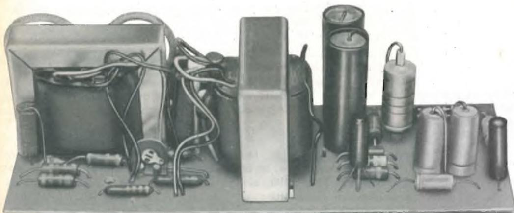
Fig. 4 - L'amplificatore TR/114 realizzato su circuito stampato.
