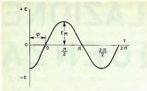
Fig. 1 - Oscillazione sinusoidale con i relativi parametri.
