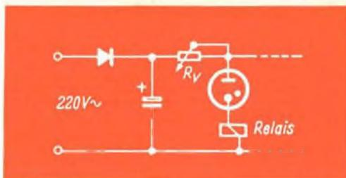
Fig. 5 - Circuito alimentatore con tubo stabilizzatore.
