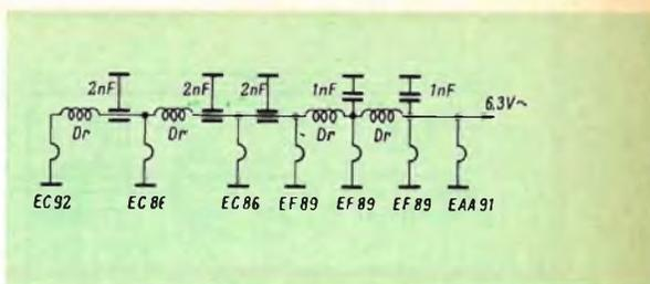
Fig. 2 - Schema per l'alimentazione dei filamenti.
