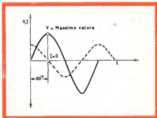
Fig. 10 - Andamento della corrente e della tensione in un circuito percorso da corrente alternata e dove è stato inserito un condensatore.
