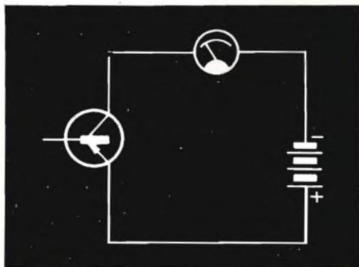
Fig. 2 - Se la tensione viene applicata fra collettore ed emettitore (base staccata), si misura  $I_{co}$ , assai maggiore ( $\beta$  volte maggiore) di  $I_{cb_0}$ .
