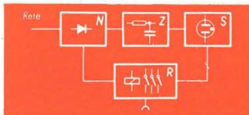
Fig. 1 - Schema a blocchi dell'interruttore elettronico.
