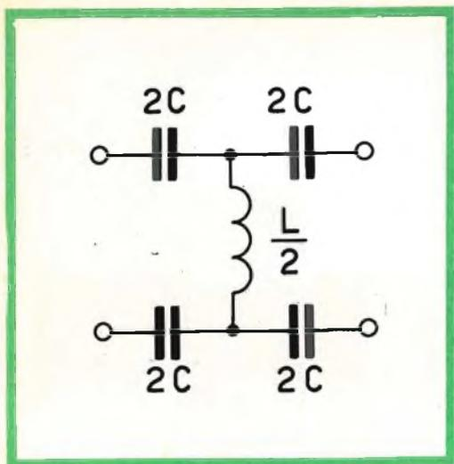
Fig. 9 - Schema elettrico di filtro passa-alto simmetrico.
