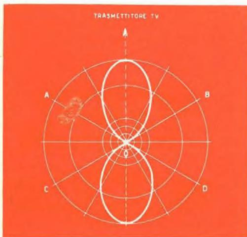
Fig. 2 - Diagramma di ricezione di un dipolo semplice.
