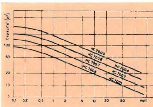
Fig. 1 - Curve rappresentative della variazione di capacità di vari diodi in funzione della tensione di polarizzazione.
