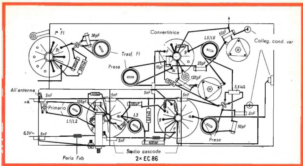
Fig. 5 - Schema di cablaggio del gruppo a radiofrequenza.
