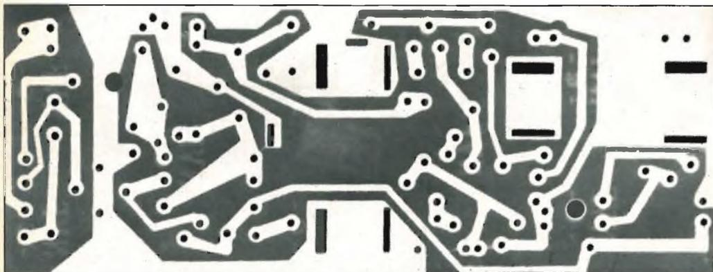
Fig. 1 - Circuito stampato O/178 (135 X 52 mm) che verrà dato in omaggio agli abbonati del 1964.
