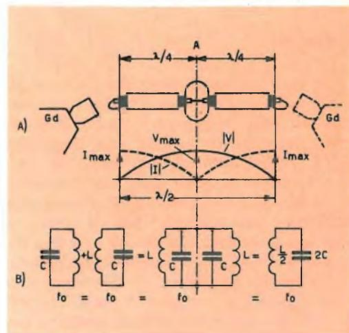
Fig. 5 - (a) Condizioni di risonanza di un cavo coassiale risonante in  $\lambda/2$  cortocircuitato alle due estremità; (b) circuito equivalente.
