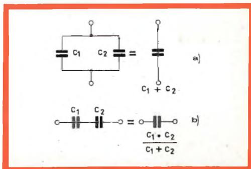
Fig. 7 - a) Collegamento in parallelo di due condensatori; b) Collegamento in serie.
