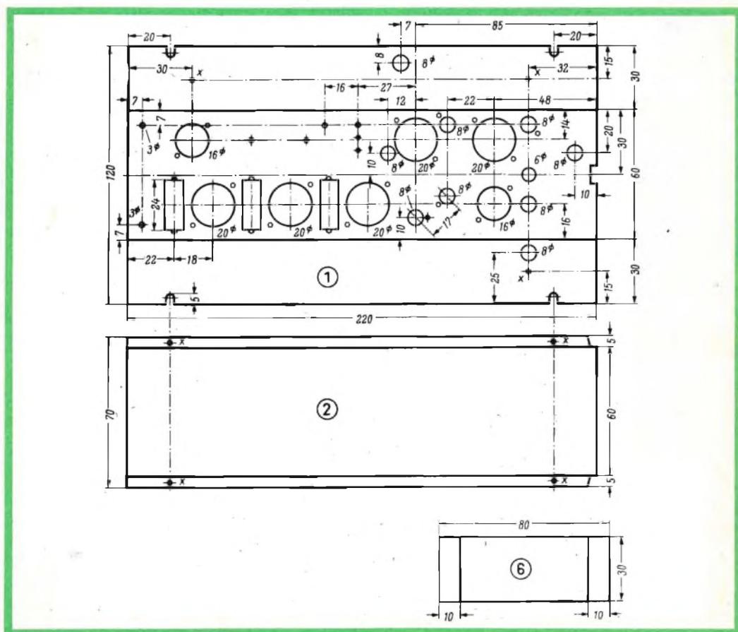
Fig. 3 - Dimensioni e foratura della piastra principale dello chassis; 1 = piastra principale; 2 = piastra inferiore; 6 = piastra laterale.
