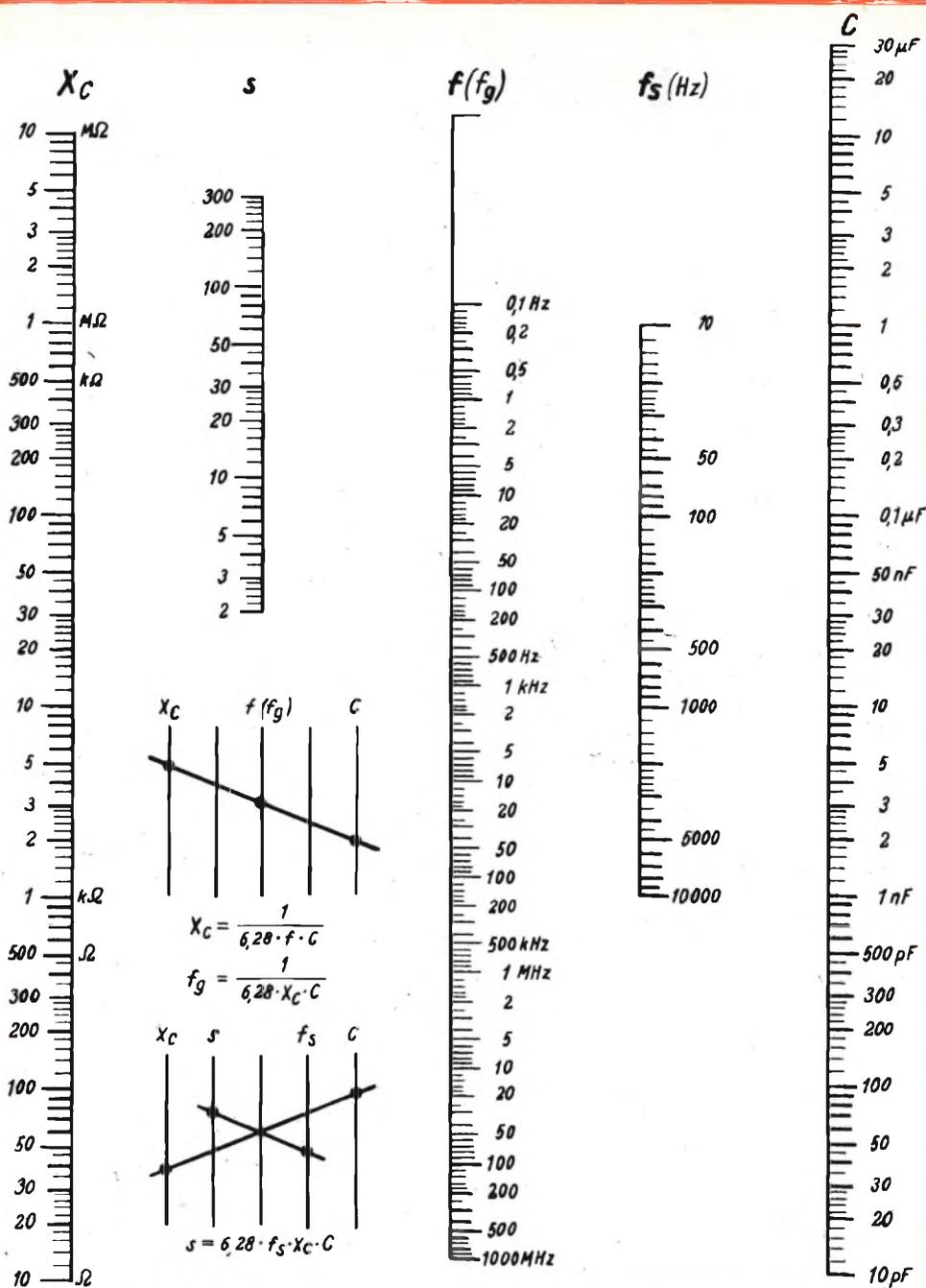
**Tavola III** - Per calcolare il valore della resistenza capacitiva ( $X_c$ ) si congiunge con una retta il punto corrispondente al valore della frequenza sulla scala  $f$  con il punto corrispondente al valore della capacità sulla scala  $C$ ; il punto in cui il prolungamento di questa retta taglia la scala  $X_c$  corrisponderà al valore della resistenza capacitiva (o reattanza)  $X_c$  cercato.
