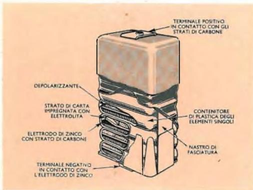
Fig. 2 - Batteria da 9 V ad elementi piatti per ricevitori a transistori. (Da « Electrical Manufacture » marzo 1962).
