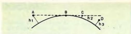
Fig. 11 - Propagazione per onda diretta delle onde inferiori a 5 m.
