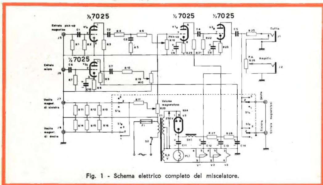
Fig. 1 - Schema elettrico completo del miscelatore.
