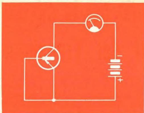
Fig. 3 - Se la base e l'emettitore sono collegati fra di loro, si può allora misurare la corrente  $I_{cs}$ , compresa fra  $I_{cbo}$  e  $I_{ceo}$ .
