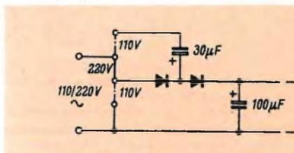
Fig. 6 - Circuito alimentatore-duplicatore.
