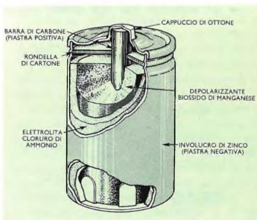
Fig. 1 - Moderna costituzione di un elemento di pila a secco con biossido di manganese. (Da « Electrical Manufacture » marzo 1962).
