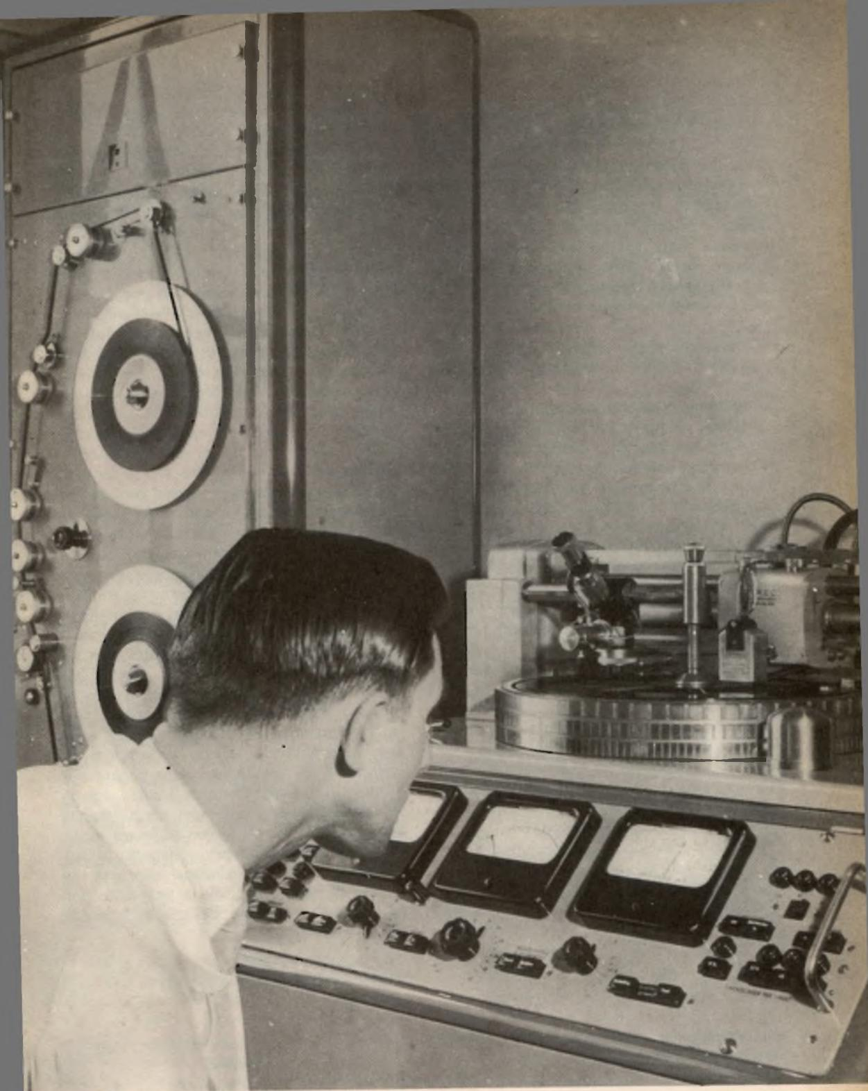
Sala di incisione. Il contenuto di un brano musicale cessa di essere una « variazione di un campo magnetico » (nastro del registratore) per materializzarsi nel solco ondeggiante del disco.
