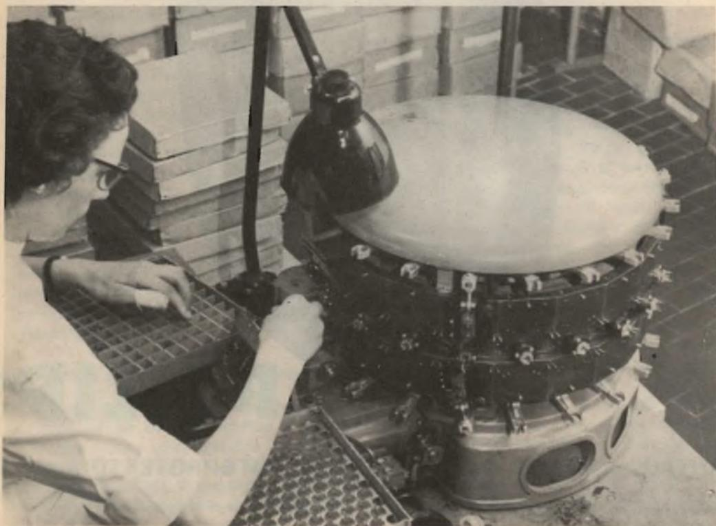
Fase finale di controllo del pentodo amplificatore di media frequenza AF 184. L'esecuzione AF 183 è a pendenza variabile (mA/V) ottenuta variando il « passo » delle spire che formano la griglia controllo. Entrambe queste valvole hanno la griglia a « telaio » e possono quindi fornire elevati valori di amplificazione.
