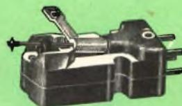
**Cartuccia piezoelettrica « Lesa »** tipo « S ». Per la produzione stereofonica dei dischi ad incisione « stereo » sistema 45°-45°. Puntina di zaffiro modello « S » livello d'uscita a 1.000 Hz per canale. 120 mV/cm/s. Risposta equalizzata da 30 a 16.000 Hz con carico 1 M $\Omega$ . Separazione fra i due canali superiori a 15 dB.
