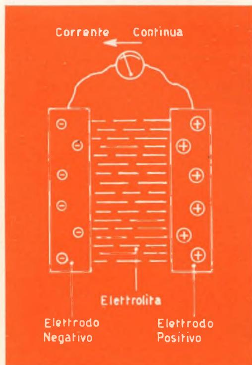
Fig. 4 - Dalla polarità opposta degli elettrodi ha luogo la corrente continua circolante nello strumento.
