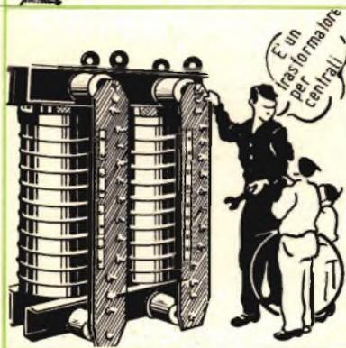
In elettrotecnica vengono impiegati i cosiddetti trasformatori di potenza nelle sottostazioni delle centrali idroelettriche. Tali trasformatori possono abbassare la tensione da 30.000 V a 3.000 V o viceversa.
