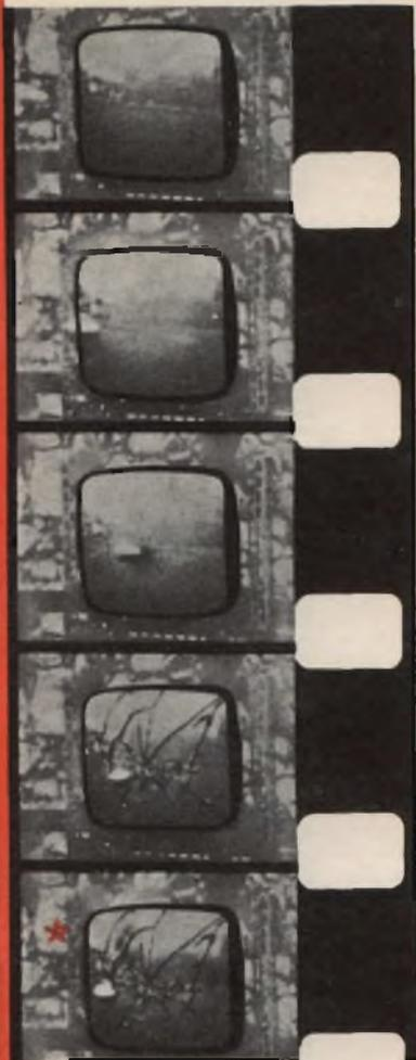
*Sequenza filmata della prova d'implosione: una sfera di acciaio (12" impatta sul centro della faccia del cinescopio cadendo con moto pendolare dall'altezza di 2 metri.*
