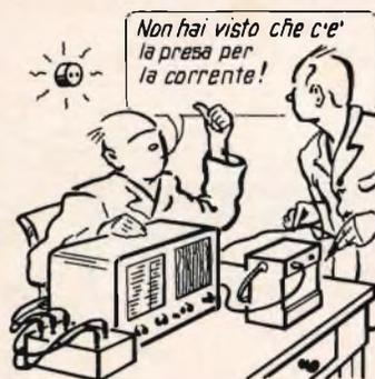
Supponiamo di avere a disposizione una tensione di 220 V. È possibile mediante un trasformatore abbassare questa tensione fino al livello necessario per l'accensione dei filamenti. Ma l'accensione, mediante corrente alternata, di filamenti che normalmente richiedono tensione continua produce nell'altoparlante un ronzio assolutamente intollerabile.
