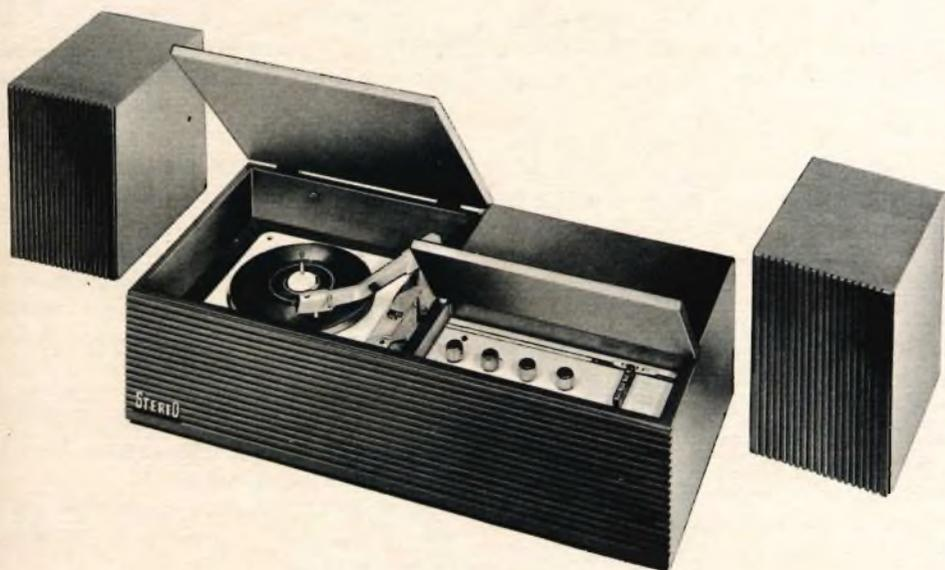
Complesso monostereofonico HI-FI costituito da un elegante mobile in legno pregiato e da 2 diffusori acustici A/494. Amplificatore con potenza d'uscita di 12 W (6 W per canale) con distorsione < 2 %. Regolazione fisiologica del volume. Controllo toni bassi - alti e bilanciamento. Prese per registratore e sintonizzatore. Commutazione delle funzioni con tastiera. Cambiadischi automatico ELAC a 4 velocità. Alimentazione universale 110 ÷ 220 V.
