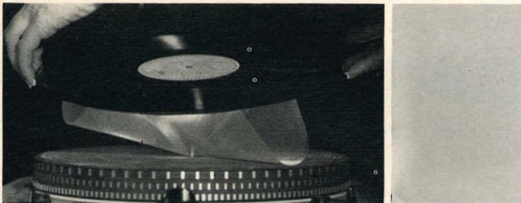
Fig. 2 - Un disco di politene costituisce una copertura per il piatto del giradischi, di facile pulitura, ed agisce anche come indicatore della presenza di cariche elettrostatiche, prodotte durante la pulizia.
