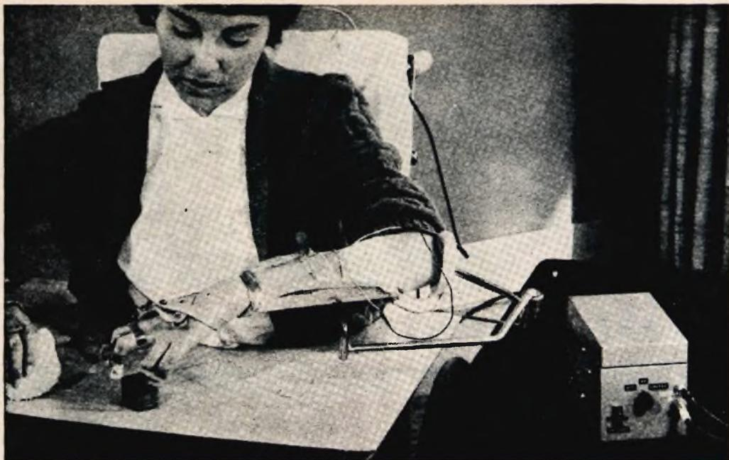
Esempio di applicazione dello stimolatore mioelettrico. La scatola che si trova alla sinistra della paziente contiene le delicate apparecchiature elettroniche che possono sostituirsi ai nervi lesi per ottenere i movimenti del braccio altrimenti inibiti dalla paralisi.
