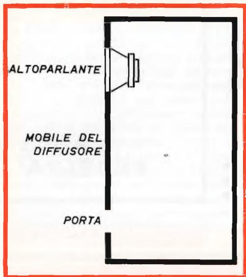
Fig. 1 - Vista in sezione di un bass reflex.
