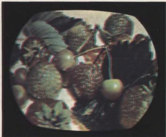
Fig. 132c - Colori che assumono le fragole di fig. 132a nel caso in cui il segnale di crominanza abbia subito un ritardo di  $-70^\circ$ . L'orologio del colore ci dice che i colori tendenti al rosso si tramuteranno in questo caso in colori tendenti al violetto (o porpora), come effettivamente si può constatare osservando questa fotografia.
