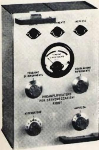
Fig. 9 - Preamplificatore Galileo R 106 f, intercambiabile, per servomeccanismi.
