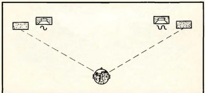
Fig. 10 - Due segnali identici riprodotti simultaneamente da due altoparlanti, ma con uno sfasamento costante, danno l'illusione che quest'ultimi siano posti più lontano l'uno dall'altro.
