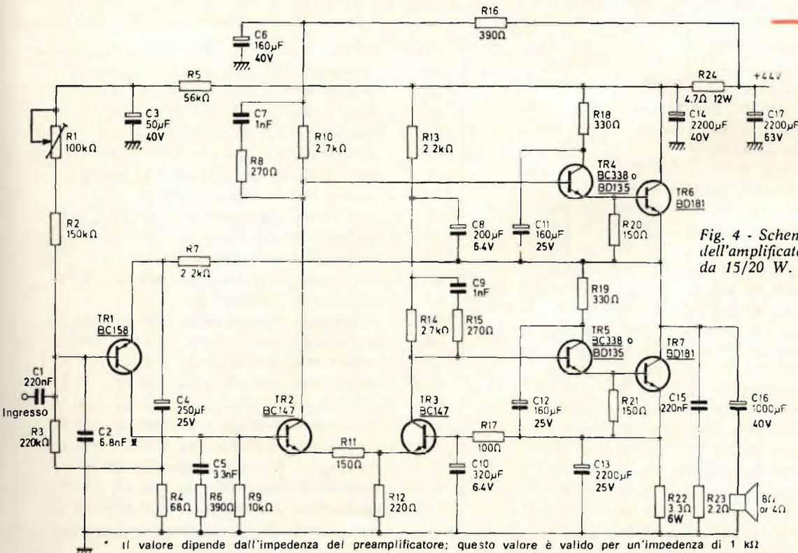
Fig. 4 - Schema elettrico dell'amplificatore B.F. da 15/20 W.
