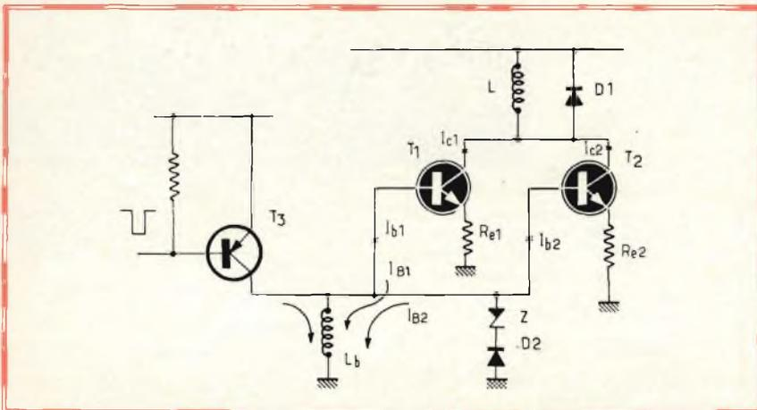
Fig. 9 - L'aggiunta della bobina  $L_b$  permette di applicare alle basi una tensione di contro-polarizzazione nell'istante di bloccaggio: ciò migliora considerevolmente il tempo di interdizione dei transistori.
