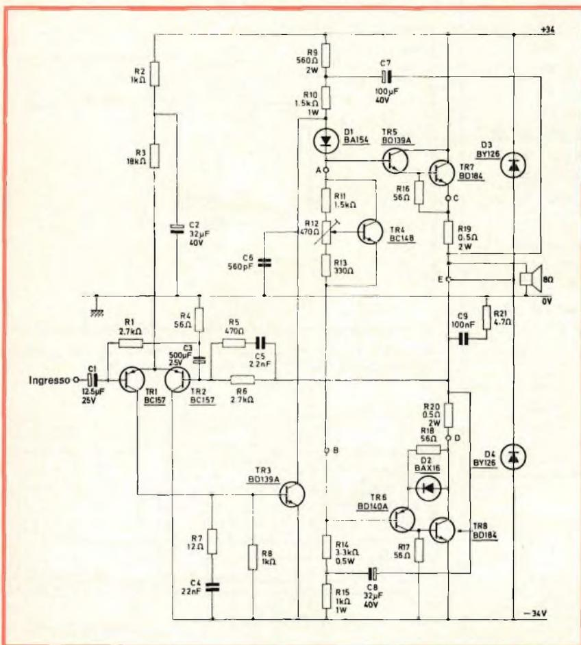
Fig. 14 - Schema elettrico dell'amplificatore B.F. da 50 W.
