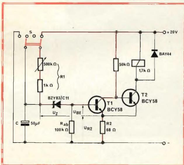
Fig. 7 - Circuito temporizzatore semplice con condensatore elettrolitico. La tensione ai morsetti del condensatore è uguale alla tensione di commutazione. Il transistor  $T_1$  diventa conduttore, in modo che il transistor  $T_2$  è bloccato e il relè si apre.
