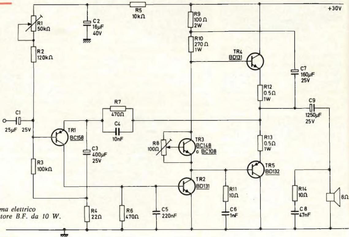
Fig. 1 - Schema elettrico dell'amplificatore B.F. da 10 W.
