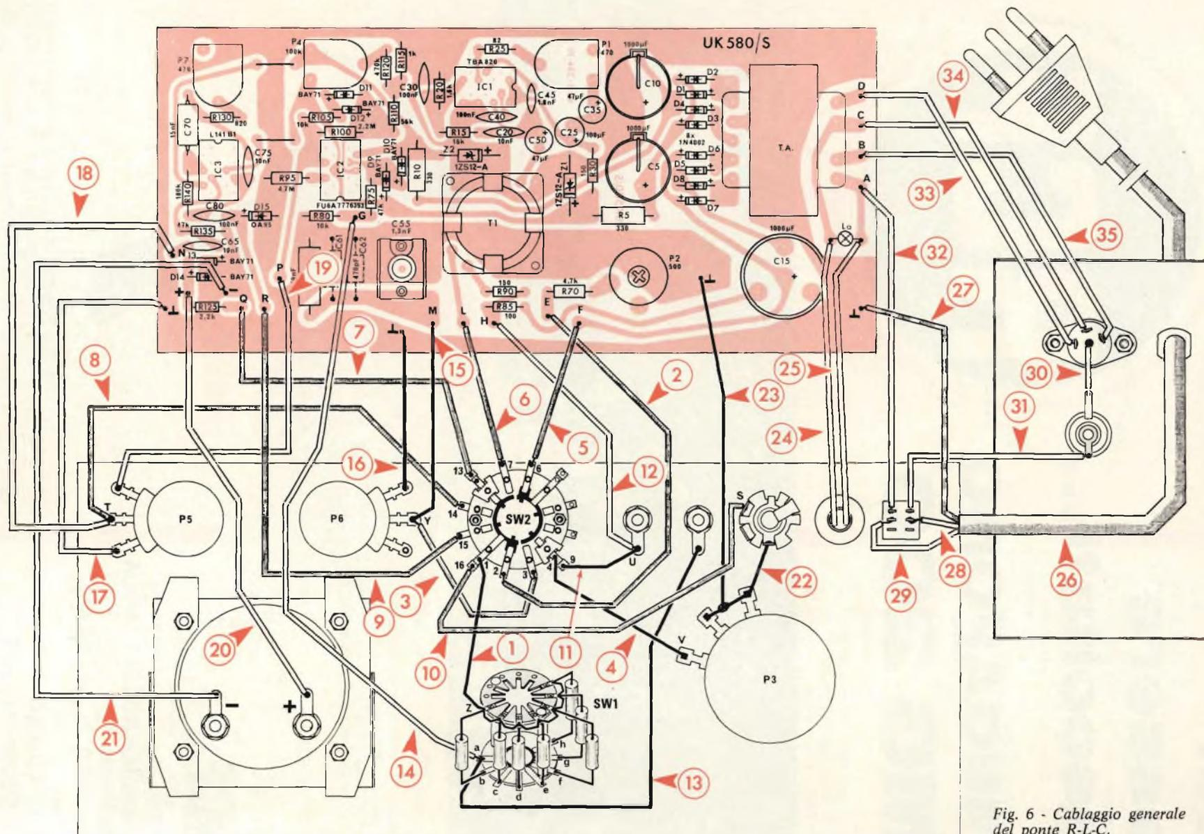
Fig. 6 - Cablaggio generale del ponte R-L-C.
