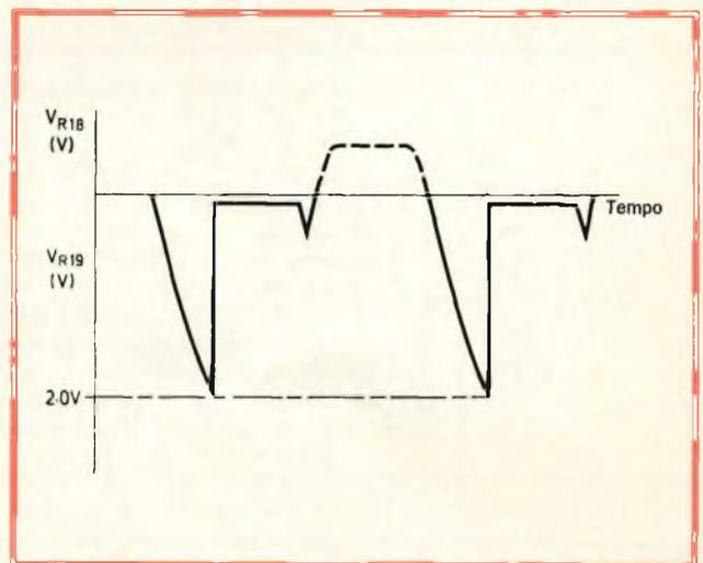
Fig. 12 - Forme d'onda per la regolazione del circuito di protezione contro i cortocircuiti di fig. 11.
