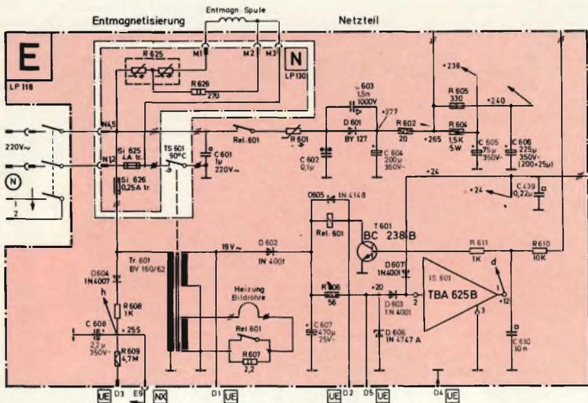
Fig. 2 - Schema elettrico della sezione alimentatrice.
