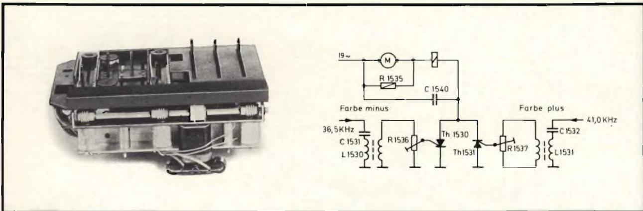
Fig. 4 - Meccanica dei comandi volume, luminosità, contrasto, tonalità colore comprensiva di motore e parti di trascinamento.
