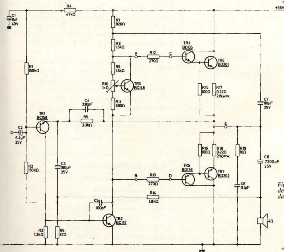
Fig. 6 - Schema dell'amplificatore B.F. da 25 W.
