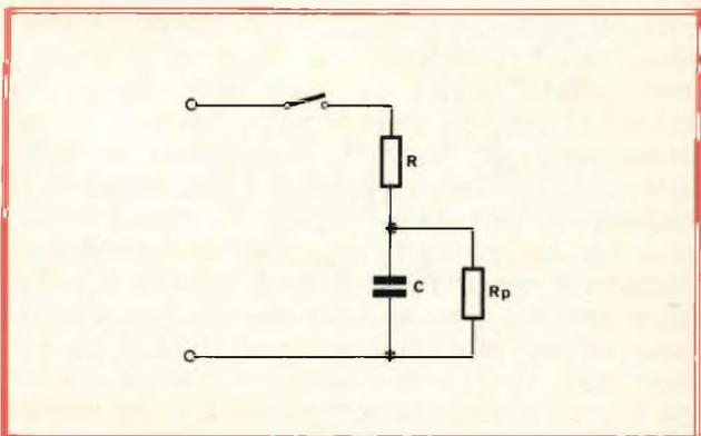
Fig. 4 - Schema equivalente di un elemento  $RC$  la cui resistenza di carico è percorsa non soltanto dalla corrente di carico, ma anche dalle correnti di fuga del condensatore o dalle correnti inverse dei semiconduttori.
