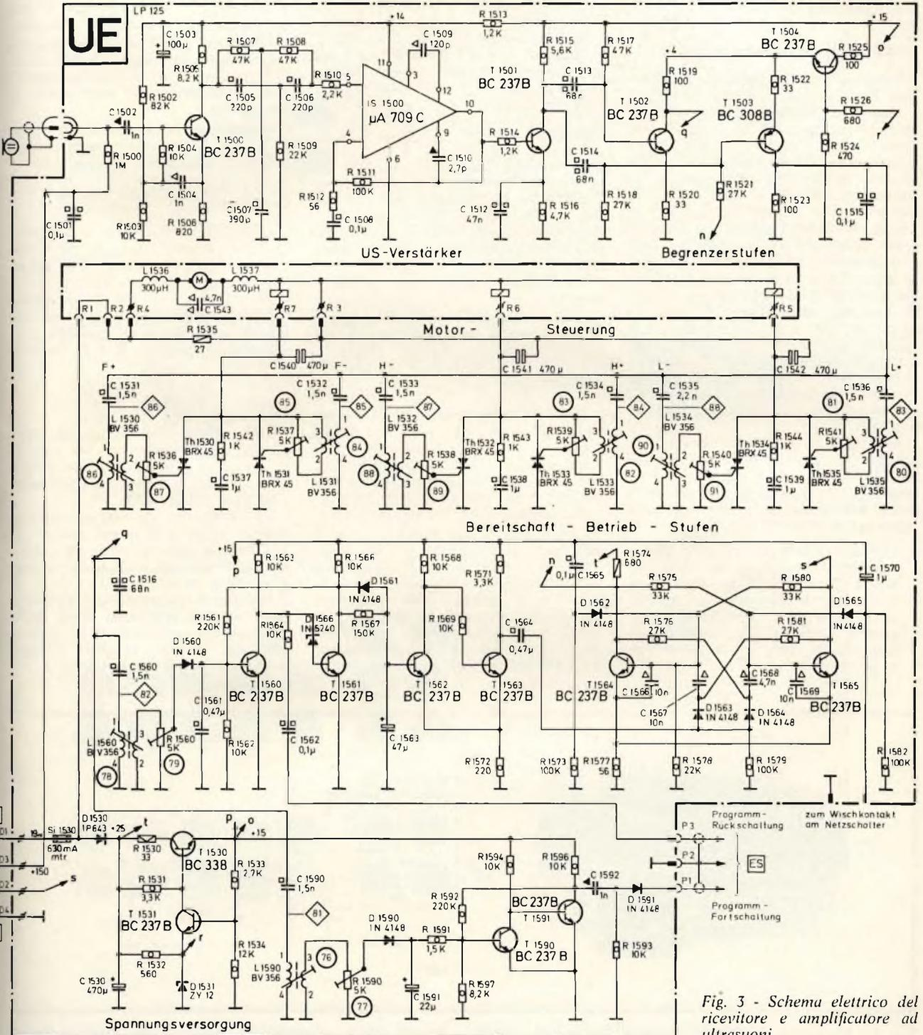
Fig. 3 - Schema elettrico del ricevitore e amplificatore ad ultrasuoni.
