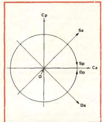
Fig. 12 - A) modulazione circolare Sp. B) modulazione circolare Dp.
