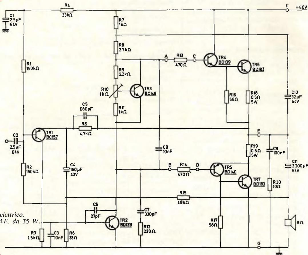
Fig. 10 - Schema elettrico dell'amplificatore B.F. da 35 W.
