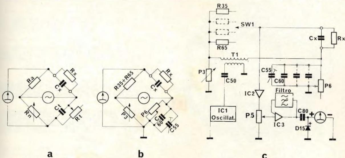
Fig. 4 - Misura delle capacità.
