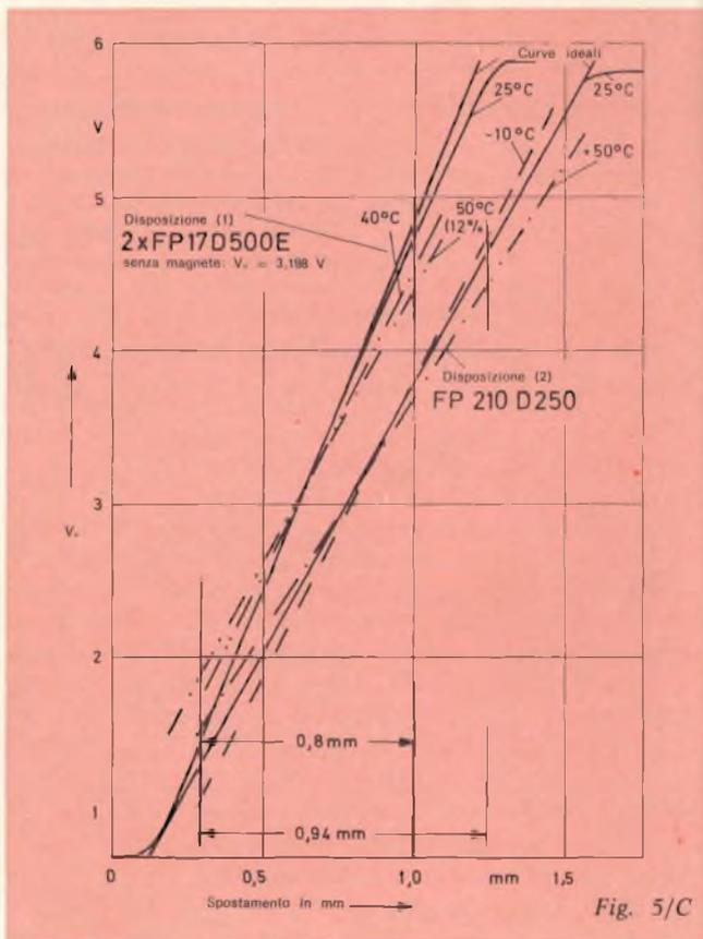
Nel campo di temperatura di  $-10$  sino  $+50$  °C l'errore è del  $\pm 10\%$  con la disposizione (2) rispetto alla curva a 25 °C.
