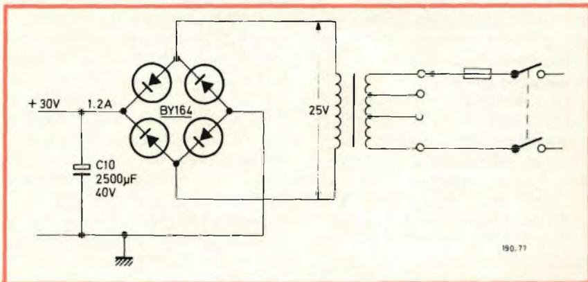
Fig. 2 - Circuito di alimentazione per l'amplificatore da 10 W.
