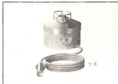
Fig. 12 - Bocca artificiale sorgente di pressione sonora costante B & K per la misura di risposta in frequenza su microfoni e protesi auditive.
