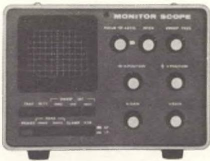
Fig. 3 - Monitor Scope Sommerkamp YO-100. Questo apparecchio è l'accessorio indispensabile del radioamatore. Prossimamente pubblicheremo la descrizione circuitale e i modi d'impiego di questo monitor.
