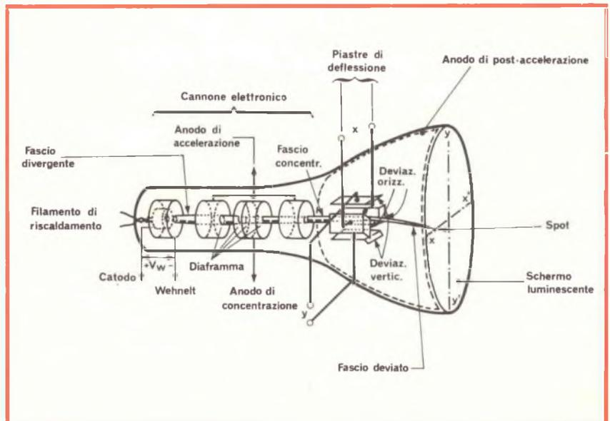
Fig. 1 - Aspetto interno di un tubo catodico classico.
