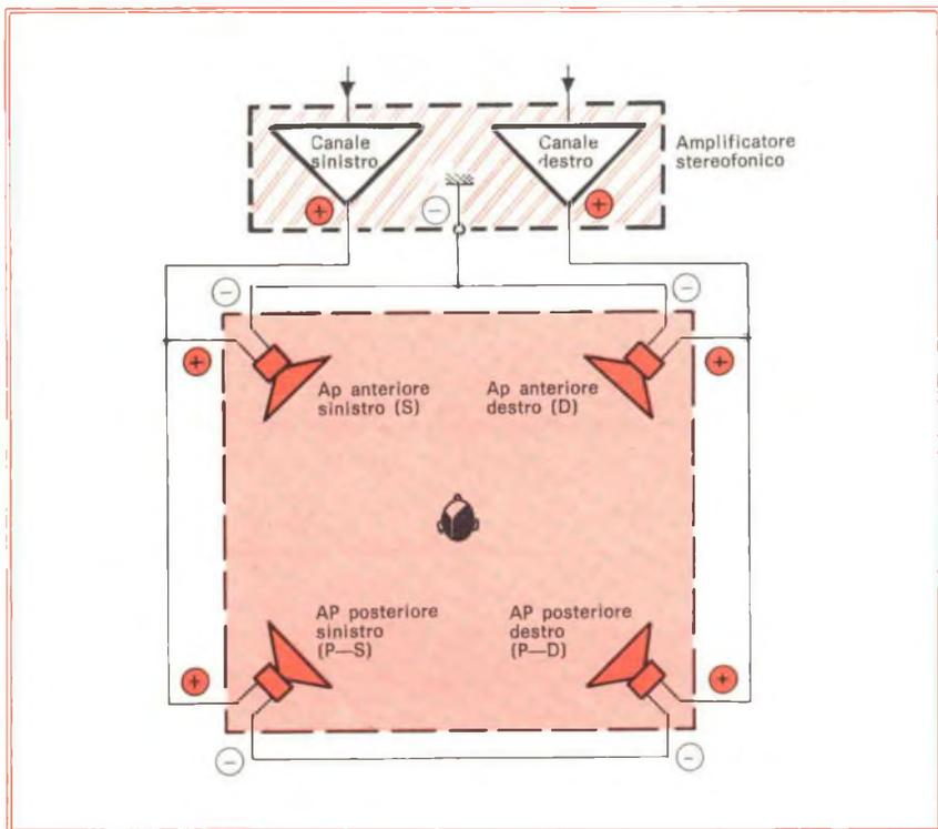
Fig. 10 - Sostituzione dell'altoparlante posteriore «unico» con due altoparlanti disposti secondo le diagonali della sala d'ascolto.
