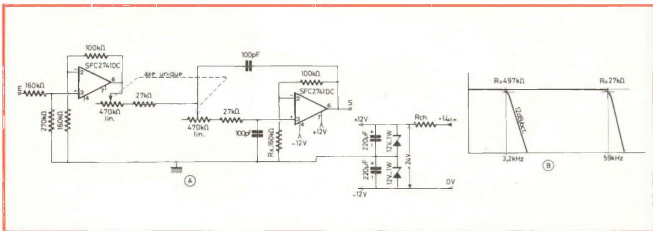
Fig. 7 - Due circuiti integrati, in contenitori ad otto terminali, di produzione Sescosem, con sigla di riferimento SFC 2741 DC, permettono di semplificare la maggior parte di questo circuito (A). Il grafico (B) riproduce la curva di responso.
