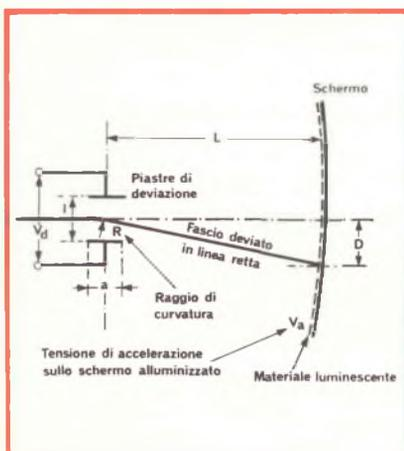
Fig. 6 - Procedimento di deviazione elettrostatica.
