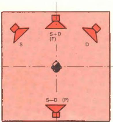
Fig. 6 - Disposizione degli altoparlanti nella versione «seconda disposizione».
