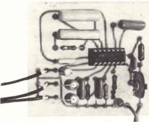
Fig. 6 - Aspecto del decodificatore stereofonico, così come è stato montato sulla basetta a circuito stampato.
