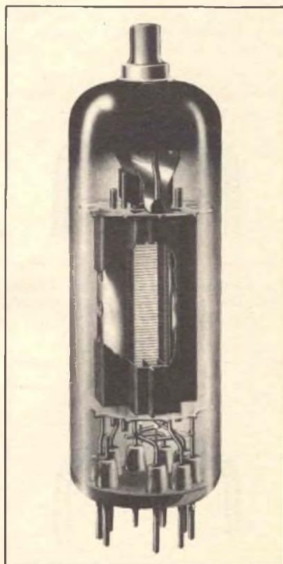
Fig. 1 - Pentodo finale PL504. In questo caso al cappellotto è collegato l'anodo a scomparti che elimina l'emissione secondaria.
