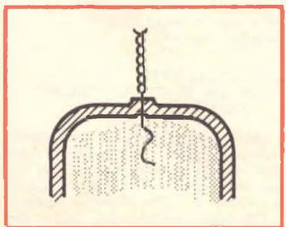
Fig. 6 - Il conduttore attorcigliato (facente capo al cappio) è pronto per essere saldato al cappelotto.
