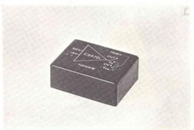
Fig. 102 - Esempio di modulo. I componenti dei vari circuiti (in questo caso si tratta di un amplificatore operazionale controllato a chopper) sono montati su circuito stampato e inglobati in resine epossidiche (Philips).
