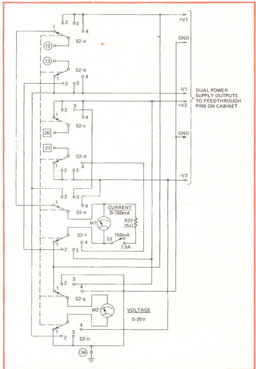
Fig. 17 - Circuito di misura per il controllo delle tensioni e delle correnti che alimentano il circuito sotto prova.
