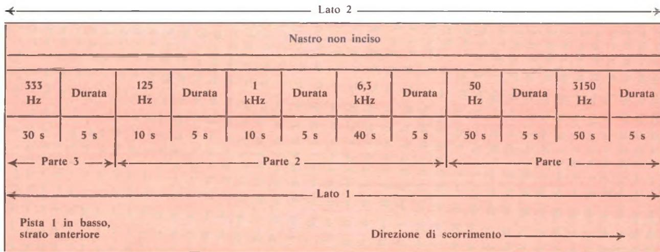
Fig. 6 - Cassetta per nastro di prova 466.
