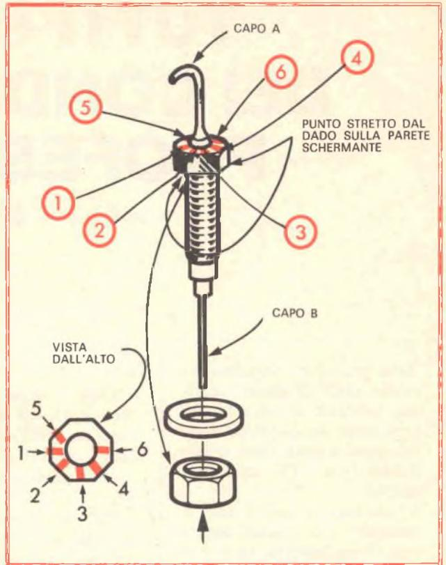
Fig. 13-A - Codice per condensatori passanti ceramici.
