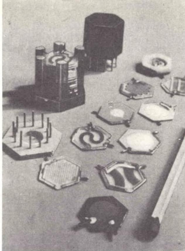
Fig. 99 - Elementi di un micromodulo (Siemens).
