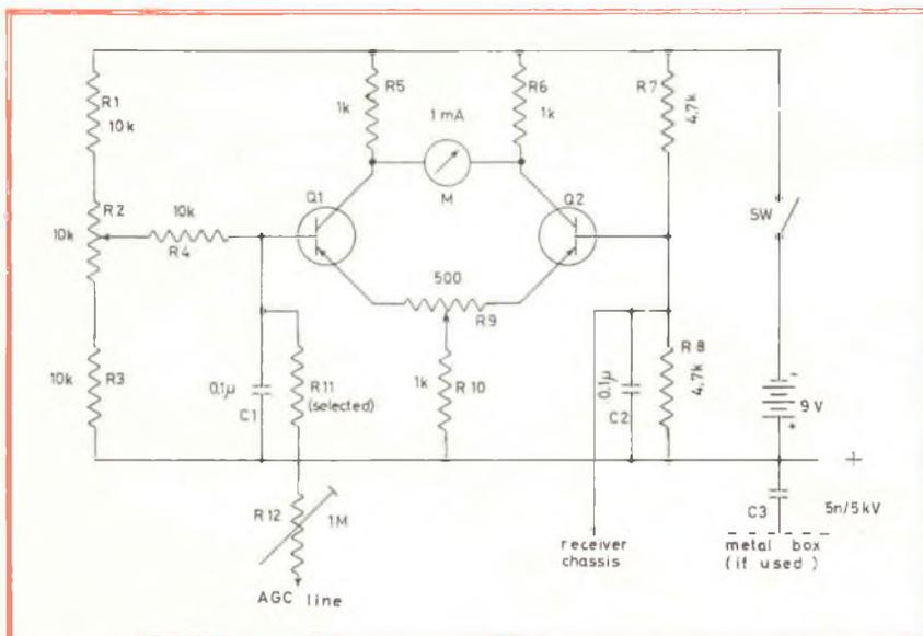
Fig. 7 - Schema elettrico di un indicatore di intensità di segnali (S meter) da inserire esternamente ad un radiodicevitore.
