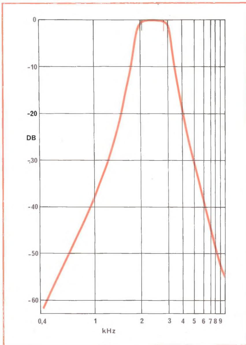
Fig. 6 - Grafico illustrante le caratteristiche del filtro passa-banda di figura 5.
