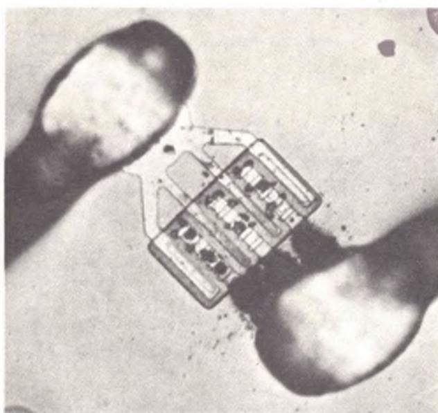
Fig. 100 - (a sinistra). Chip del transistor BFW 30 in condizioni normali. Il chip misura  $0,35 \times 0,35 \text{ mm}$ , le «dita» (5) dell'emettitore sono larghe  $6 \mu\text{m}$ . (a destra). Danni prodotti dal fenomeno della migrazione dopo un funzionamento di 5000 ore con una corrente di 300 mA.
