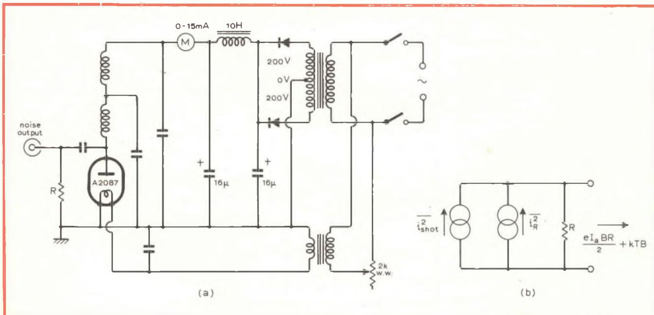
Fig. 3 - Pur essendo una sorgente estremamente utile di rumore agli effetti delle misure, il diodo termoionico funzionante in stato di saturazione viene considerato come un generatore di rumore assoluto. Lo schema (a) è costituito da un circuito tipico che fa uso di un diodo A2087, secondo lo schema riprodotto nella versione equivalente in (b).
