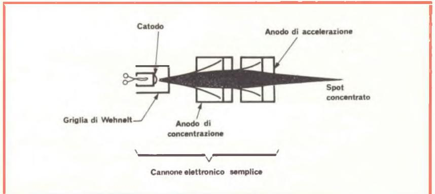
Fig. 3 - Schema di un cannone elettronico semplice.
