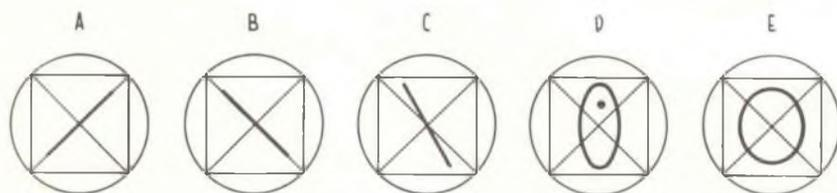
Fig. 12 - Tracce relative al rapporto di fase fra due tensioni sinusoidali. A = ampiezza e fasi uguali. B = ampiezza uguale e fase a 180° cioè in opposizione. D = ampiezza uguale e fase 53°. E = ampiezza uguale e fase a 90°.
