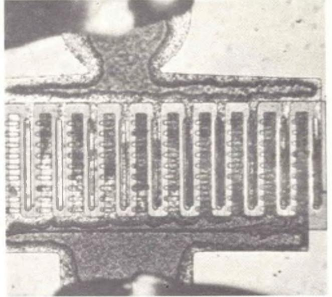
Fig. 101 - (a sinistra) Chip del transistor BFW 164 in condizioni normali. Il chip misura 0,45 x 0,45 mm, le 12 «dita» dell'emettitore sono larghe 6  $\mu\text{m}$ , (a destra). Danni prodotti dal fenomeno della migrazione dopo che il transistor è stato mantenuto inattivo per 5000 ore alla temperatura di 275 °C.
