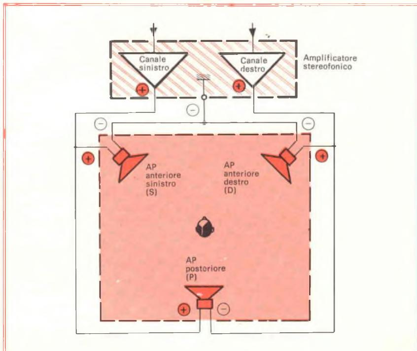
Fig. 8 - Variante della «seconda disposizione» (fig. 6) non comprendente l'altoparlante frontale.
