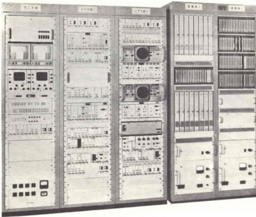
Fig. 6 - Convertitore di standard, di tipo numerico, per televisione bianco e nero, colori, scambio programmi via satellite della OKI Electric Industry.
