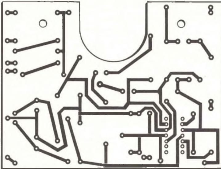
Fig. 22 - Riproduzione del circuito stampato corrispondente alla disposizione dei componenti di cui alla figura 21.
