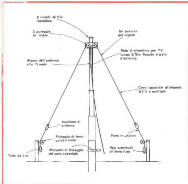
Fig. 1 - Vista generale dell'antenna a «V» rovesciata.
