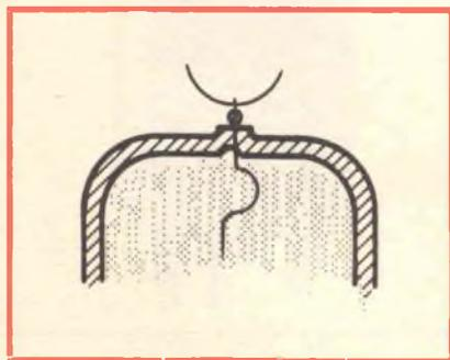
Fig. 5 - Cappio con filo da 1 o 2/10 di mm di filo di rame attorno allo spezzone di conduttore che esce dal bulbo.
