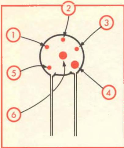
Fig. 15 - Codice dei «sei punti» per condensatori ceramici.
