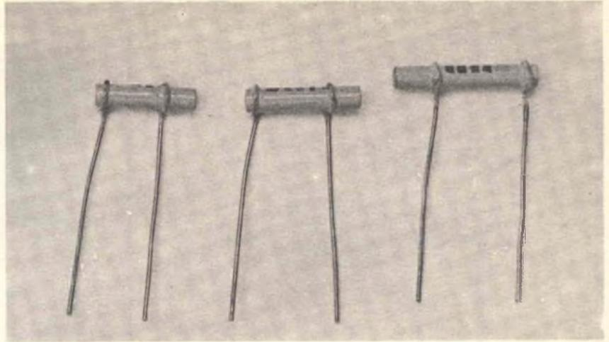
Fig. 17-A - Condensatori ceramici a tubetto con uscite radiali.
