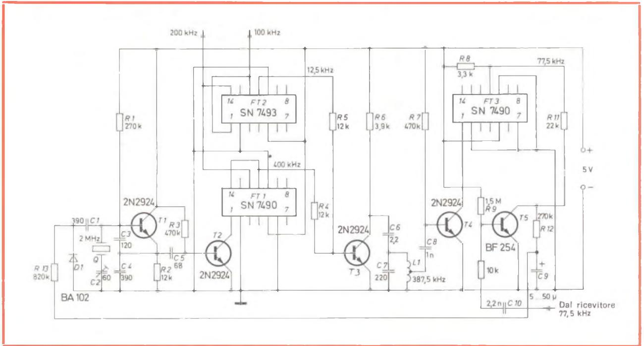
Fig. 11 - Circuito elettrico del generatore di frequenza con controllo di fase. La frequenza di 77,5 kHz, ricavata dall'oscillatore a quarzo mediante divisione e battimento, è confrontata con la frequenza ricevuta. La tensione che ne deriva controlla l'oscillatore a quarzo.
