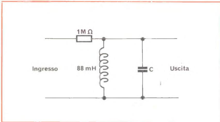
Fig. 3 - Versione semplificata del classico circuito filtro usato nei demodulatori per RTTY.
