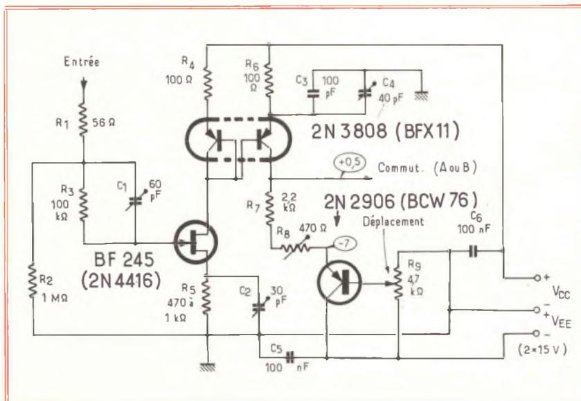
Fig. 13 - Schema del preamplificatore ad alta impedenza di ingresso e con guadagno pari a 2, funzionante con banda passante compresa tra 0 e 25 MHz.
