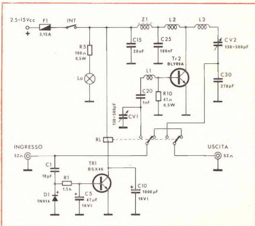
Fig. 1 - Schema elettrico dell'amplificatore lineare ad alta frequenza AMTRON UK 372 per la gamma 26 ÷ 30 MHz.
