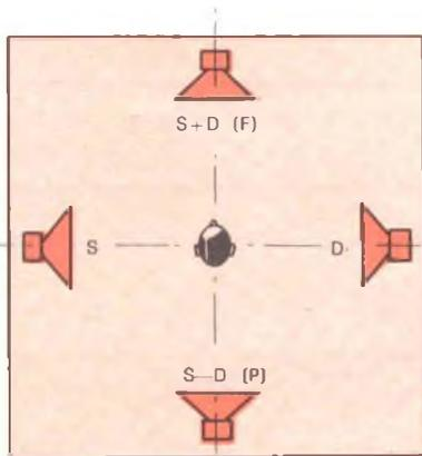
Fig. 1 - Disposizione degli altoparlanti permettono, in una sala d'audizione, di localizzare i suoni nello spazio.
