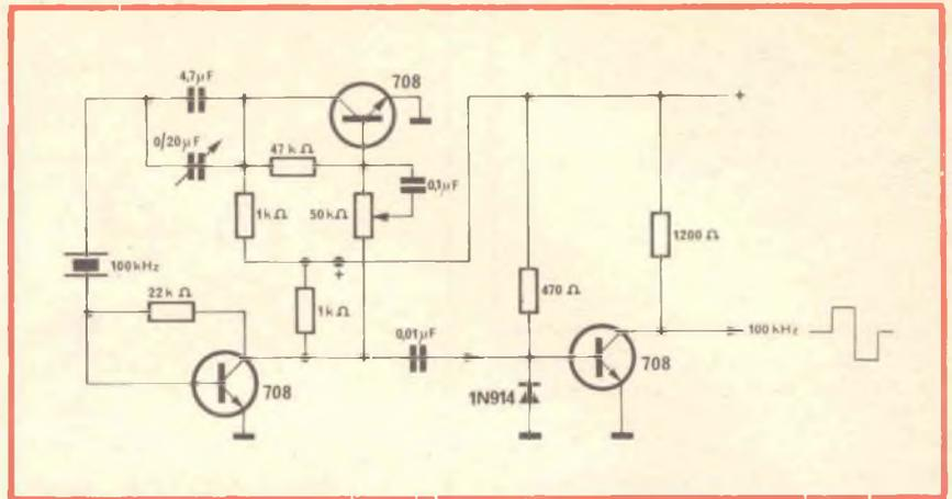
Fig. 4 - Classico circuito oscillatore che permette di far oscillare anche quarzi di particolare durezza.
