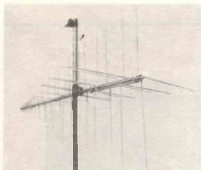
Fig. 15 - Antenna UHF/EHF a doppia polarizzazione Watkins-Johnson per la gamma  $30$  MHz  $\div$   $12$  GHz.
