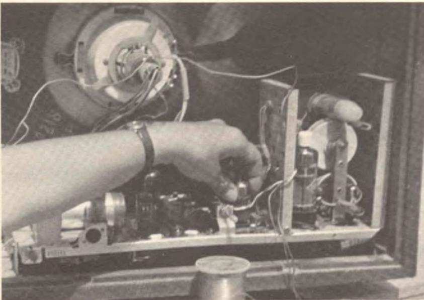
Fig. 6 - I tubi, nel tempo, si esauriscono; inoltre divengono microfonicici, difettosi, e manifestano vari cortocircuiti interni anche intermittenti. Se uno è sospettabile, conviene procedere immediatamente alla sostituzione.
