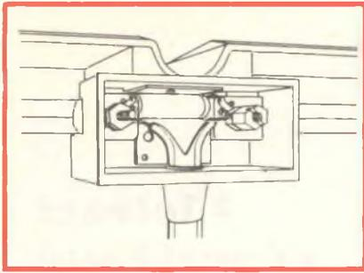
Fig. 3 - Collegamento della piattina da 300 Ω alla morsetteria del dipolo.
