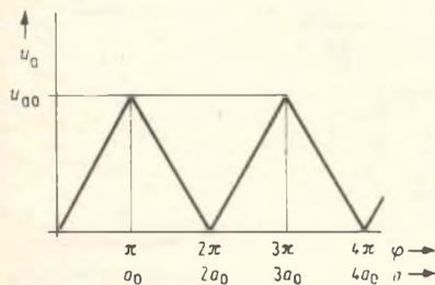
Fig. 3 - Tensione di uscita «ua» del misuratore di distanza in dipendenza dalla distanza «a» dallo spostamento di fase  $\varphi_a$  fra segnale trasmesso e quello ricevuto, il di cui andamento indica la ambiguità dell'interpretazione.
