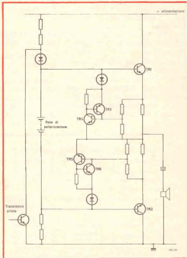
Fig. 11 - Schema elettrico del circuito di protezione contro i cortocircuiti di tipo ad arresto di corrente a «tiristori».
