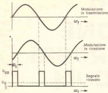
Fig. 2 - Principio fisico su cui si basa la misura della distanza. L'onda modulata all'ingresso del ricevitore, dopo aver percorso il tragitto di misura, risulta sfasata dell'angolo  $\varphi_a$  rispetto all'onda in uscita dal trasmettitore. Mediante comparazione, ai passaggi per lo zero delle due modulazioni, si genera una oscillazione rettangolare con rapporto di pulsazione  $\varphi_a/\pi$ , la di cui tensione media continua «ua» è una funzione diretta della distanza.
