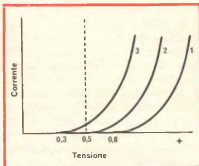
Fig. 1 - La variazione della corrente dipende dalla temperatura e dalla tensione.
