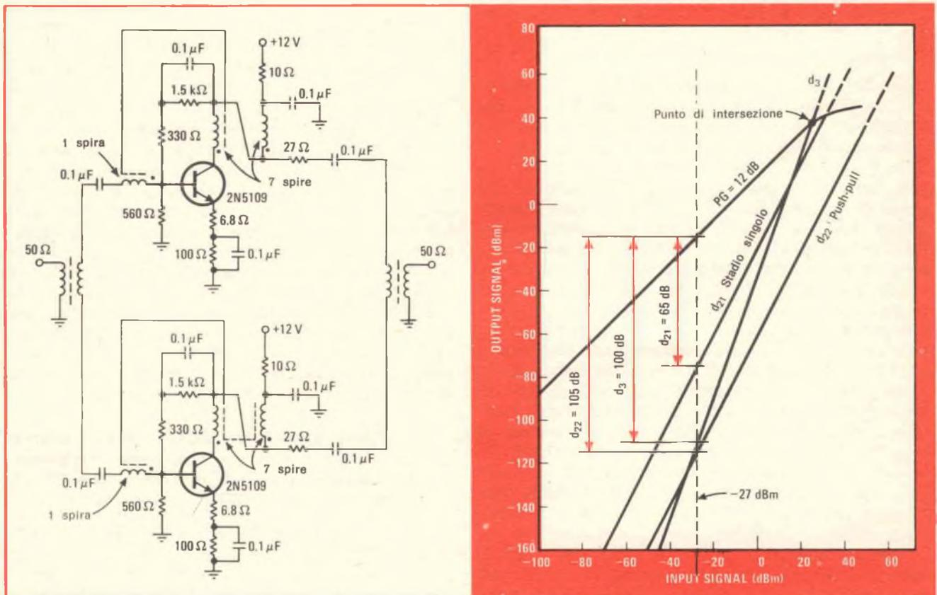
Fig. 3 - Push-pull. Due transistori a radiofrequenza di potenza consentono di ottenere un amplificatore con ottima linearità. La controeazione tra resistenze di emettitore non by-passed, le resistenze collettore-base e i trasformatori collettore-base linearizzano il circuito. Le curve illustrano la riduzione dei livelli di distorsione.
