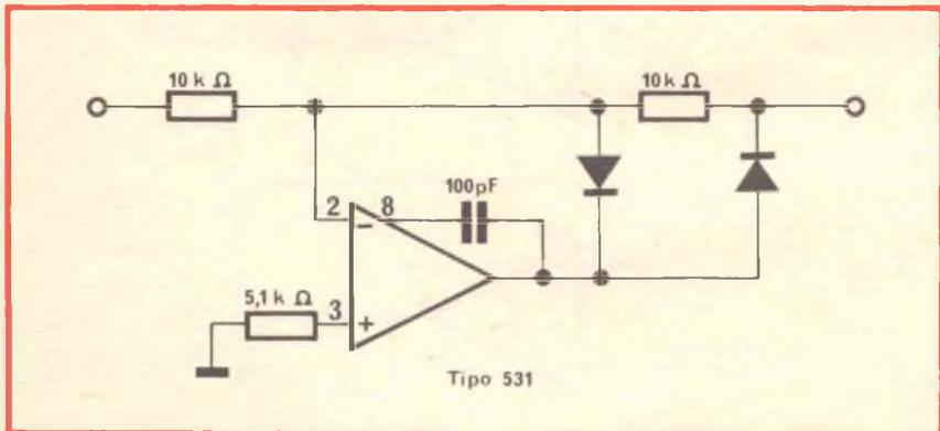
Fig. 4 - Raddrizzatore per alta frequenza.
