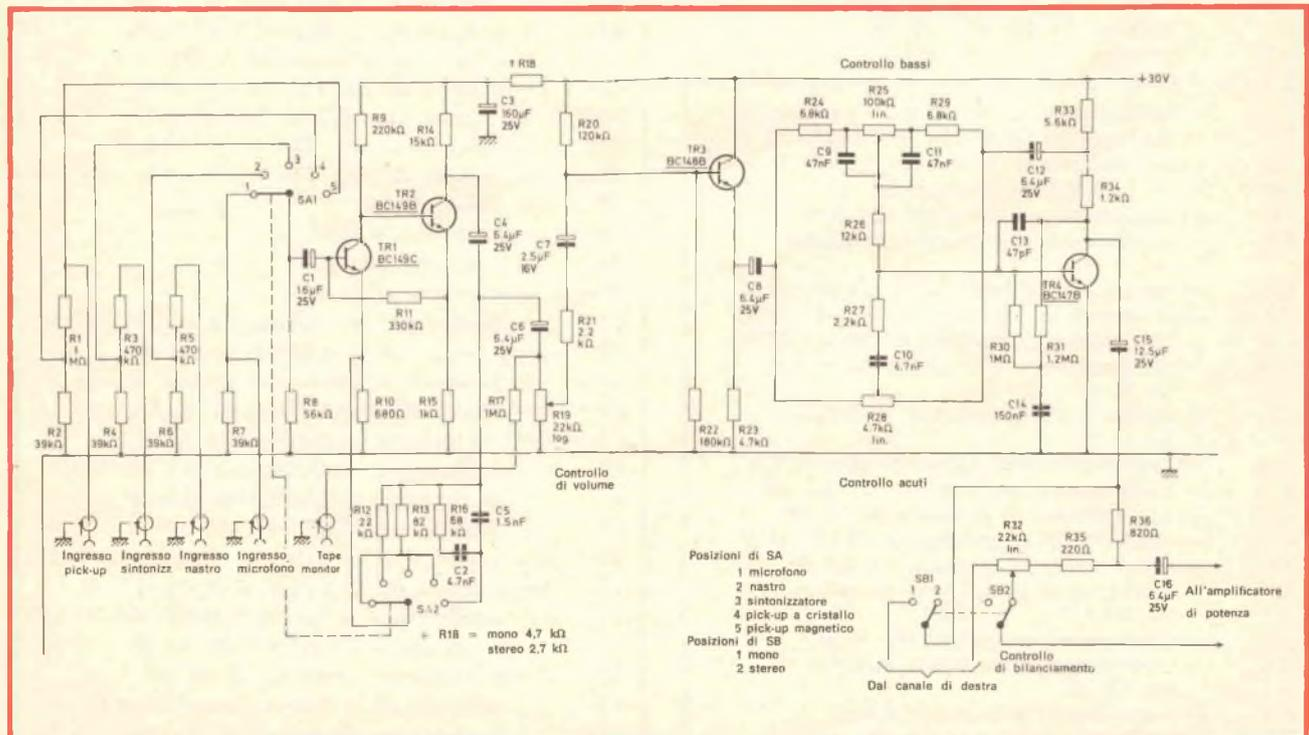
Fig. 6 - Schema elettrico del preamplificatore universale utilizzabile con gli amplificatori audio da 15/20 W, 25 W, 35 W e 50 W.
