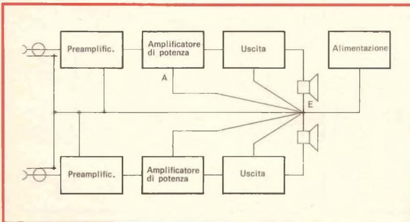
Fig. 13 - Messa a terra dell'amplificatore stereo.
