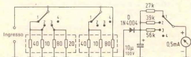
Fig. 1 - Schema elettrico del wattmetro. Posizioni del commutatore: 1 = 4 Ω, 2 = 8 Ω, 3 = 16 Ω, 4 = escluso. Le linee tratteggiate contengono i gruppi di resistenze.
