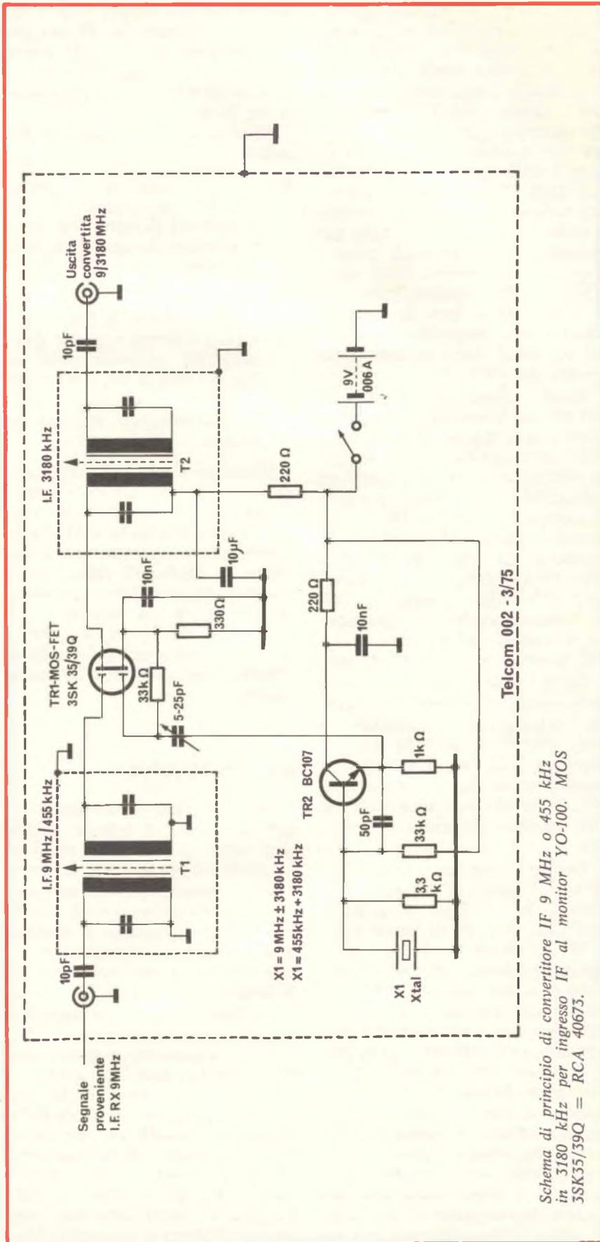
Schema di principio di convertitore IF 9 MHz o 455 kHz in 3180 kHz per ingresso IF al monitor YO-100. MOS 3SK35/39Q = RCA 40673.
