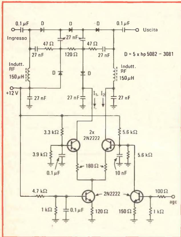
Fig. 2 - Attenuatore. L'attenuatore impiega cinque diodi p-i-n in doppia configurazione a T. La somma delle correnti di collettore dei transistori dovrebbe essere mantenuta costante per non far variare le impedenze di ingresso e di uscita.
