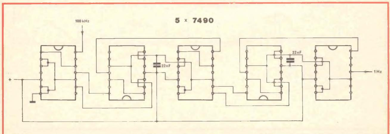
Fig. 5 - Circuito divisore del CLOCK, composto da cinque 7490 così collegati fra di loro.
