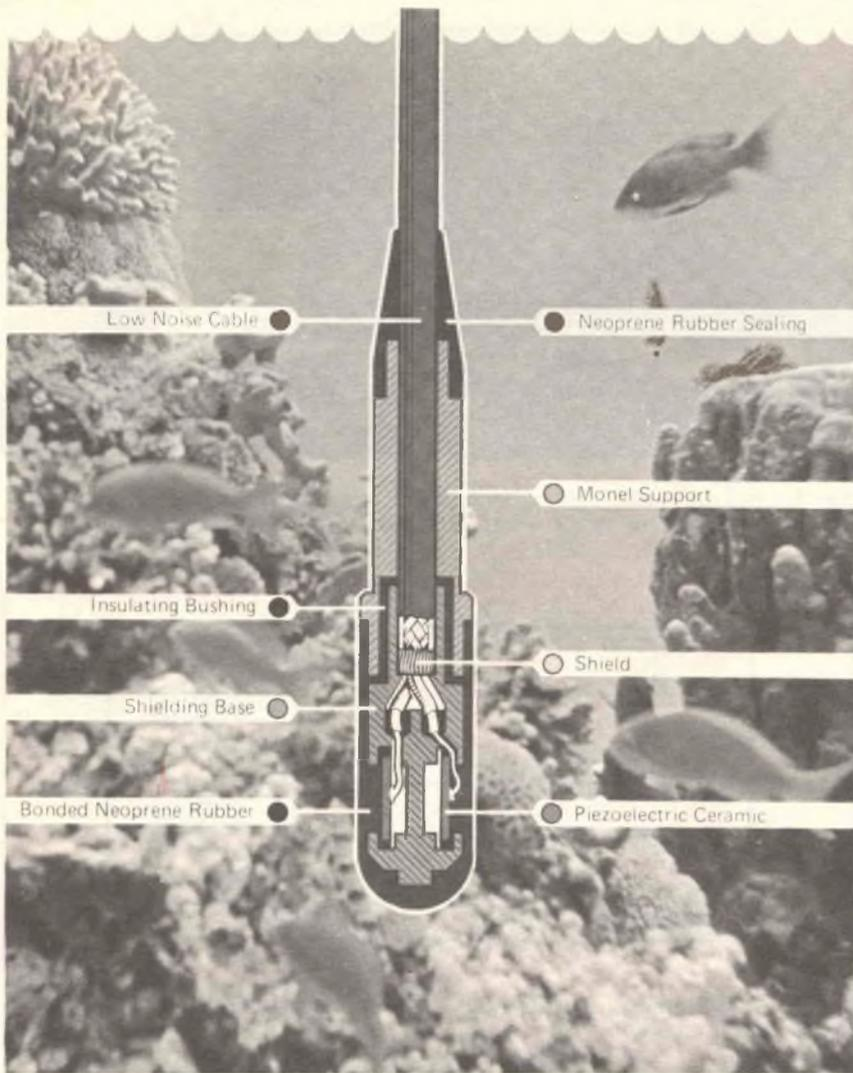
Fig. 10 - Vista in sezione dell'idrofono B & K modello 8101 di cui alla fig. 9.
