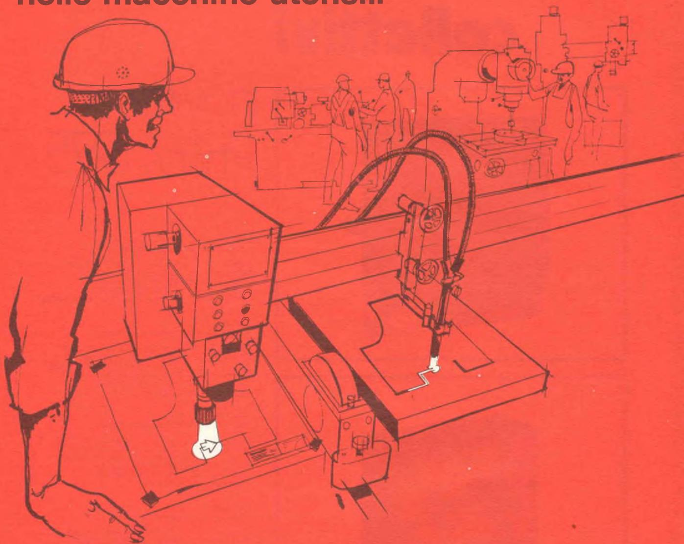
Oggi esistono macchine in grado di « leggere » i disegni, seguirne le linee e controllare in tal modo direttamente l'utensile con la massima precisione. Non hanno bisogno di maschere, di programmi al calcolatore, di schede perforate di comando: basta solo il disegno. Queste macchine sono fornite di due sensori opto-elettronici alta-
