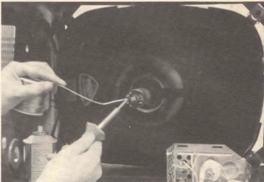
*Fig. 7 - Non di rado, i cinescopi manifestano effetti microfonici e varie instabilità. Talvolta, i tecnici gettano nei rifiuti degli elementi, buonissimi che hanno il solo torto di presentare una saldatura deficitaria all'interno dei piedini dello zoccolo. Prima di scartare un cinescopio difettoso, si dovrebbe sempre fare la prova mostrata nella figura, ovvero il «ripasso» delle saldature, spinotto dopo spinotto, effettuato con abbondante calore, ed uno stagno scorrevole, di ottima qualità.*
