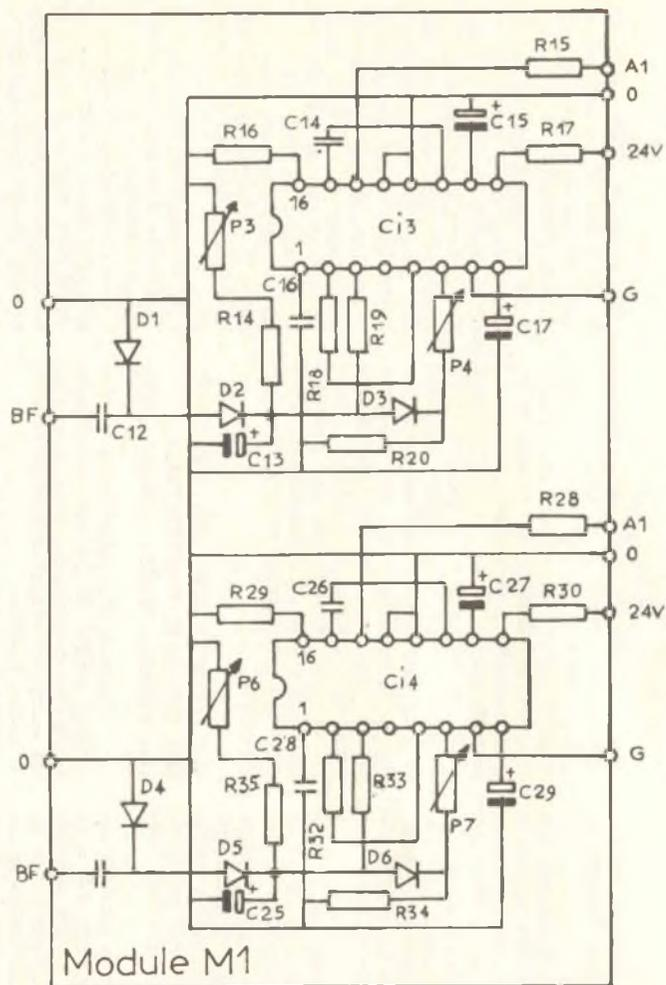
Fig. 10 - Schema elettrico del modulo M1, facente parte del dispositivo di cui alla figura 8.
