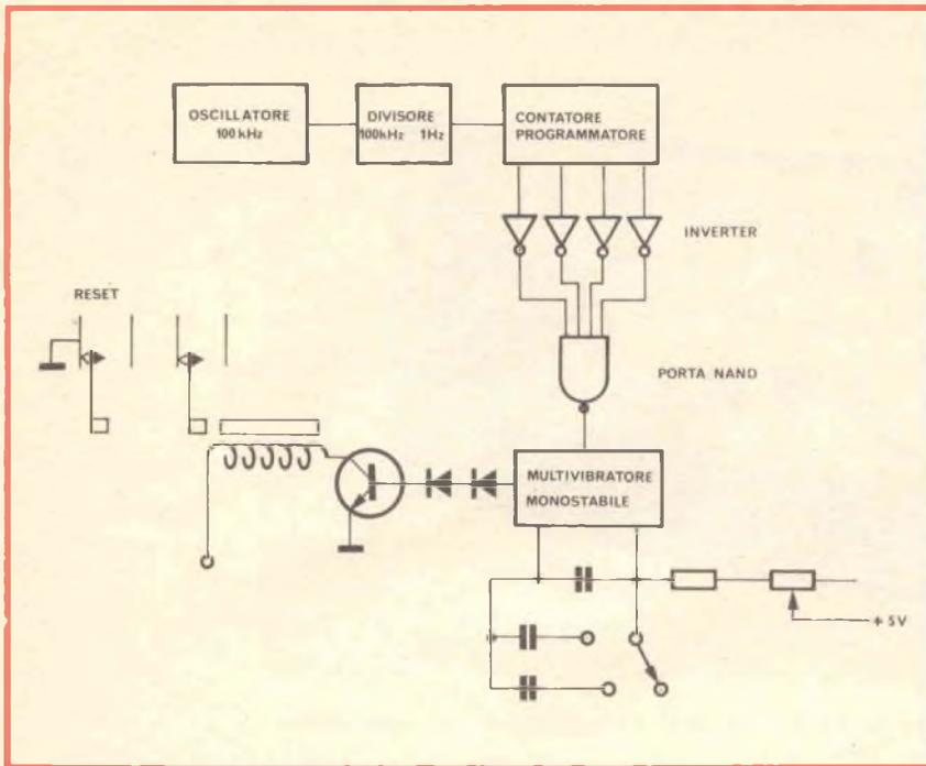
Fig. 2 - Schema a blocchi del contatore ciclico.
