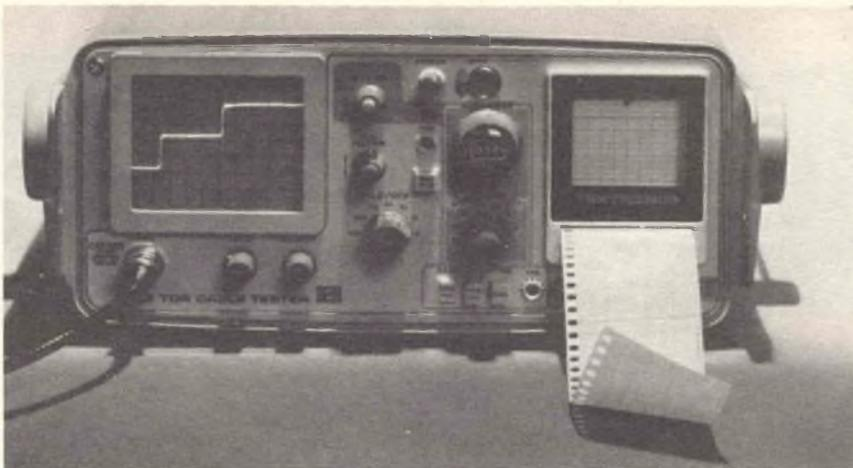
Fig. 7 - Riflettore della Tektronix (Silvestar), modello 1502 per misure su cavi, munito di registratore (esiste anche la versione XY).
