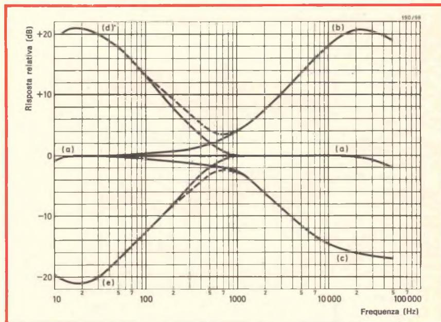
Fig. 8 - Caratteristiche del controllo di tono del preamplificatore.
