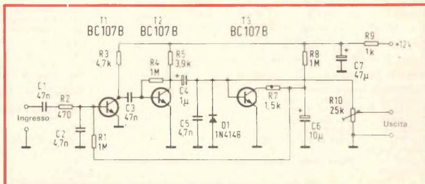
Fig. 1 - Schema elettrico del compressore della dinamica per ricetrasmittitori.
