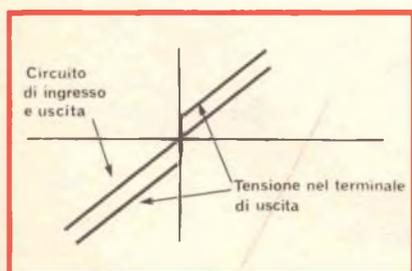
Fig. 10 - Principio di un rivelatore a «zero crossing».
