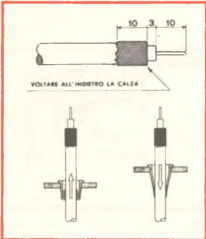
Fig. 4 - Procedimento da seguire per introdurre il cavo coassiale nella morsetteria.
