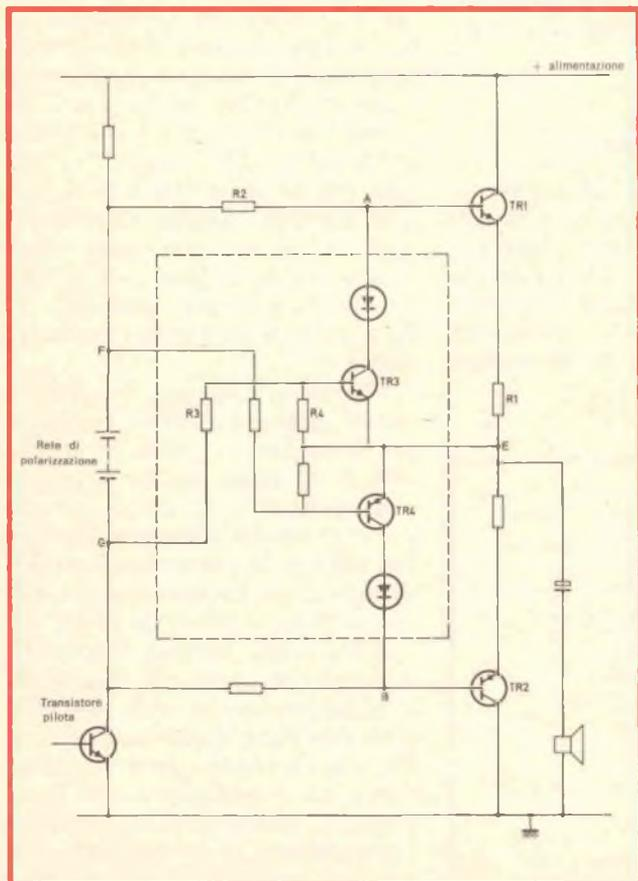
Fig. 10 - Schema elettrico del circuito di protezione contro i cortocircuiti di tipo ad arresto di corrente.
