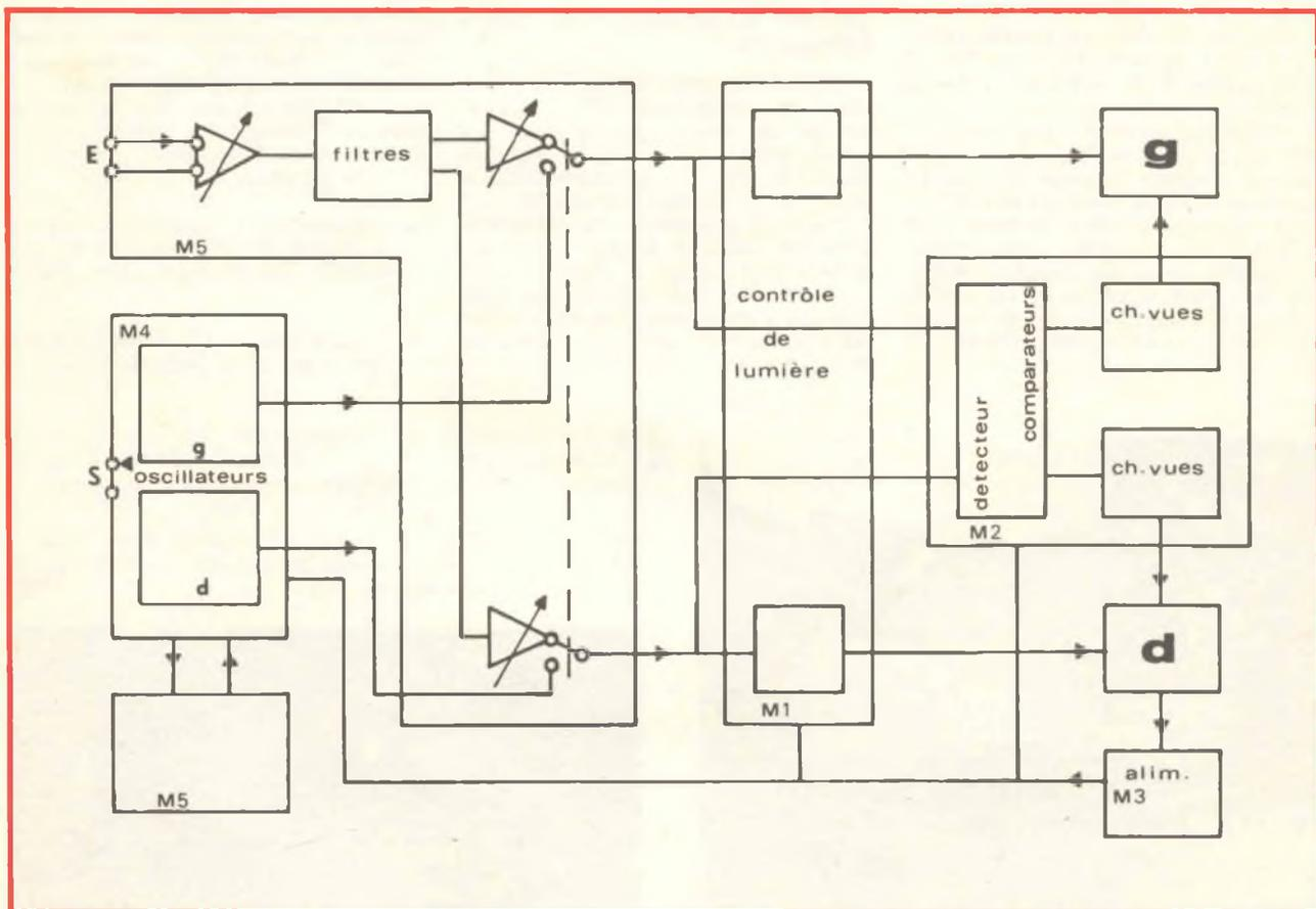
Fig. 9 - Schema a blocchi generale che illustra tutte le funzioni che vengono svolte nel dispositivo per la realizzazione delle dissolvenze incrociate.
