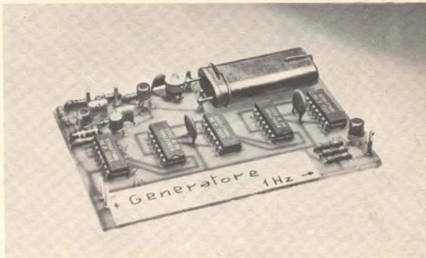
Fig. 12 - Circuito stampato di figura 9 a montaggio ultimato.
