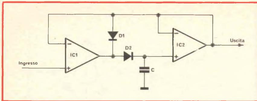
Fig. 7 - Circuito denominato: immagazzinatore di campionamento.
