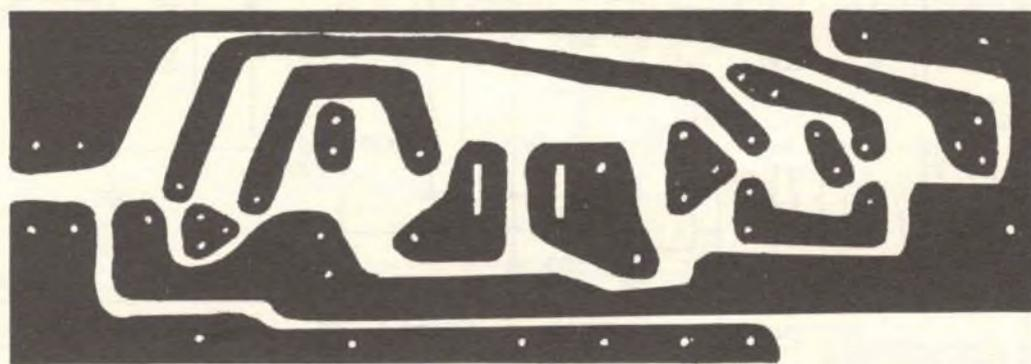
Fig. 19 - In alto, lato rame della basetta di supporto del circuito stampato, ed in basso disposizione dei diversi componenti del circuito, sul lato opposto.
