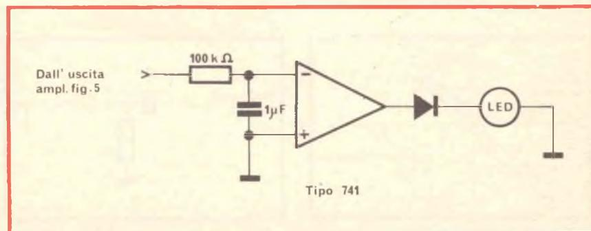
Fig. 6 - Una resistenza da 68  $\Omega$  1/2 W limita la corrente del LED.
