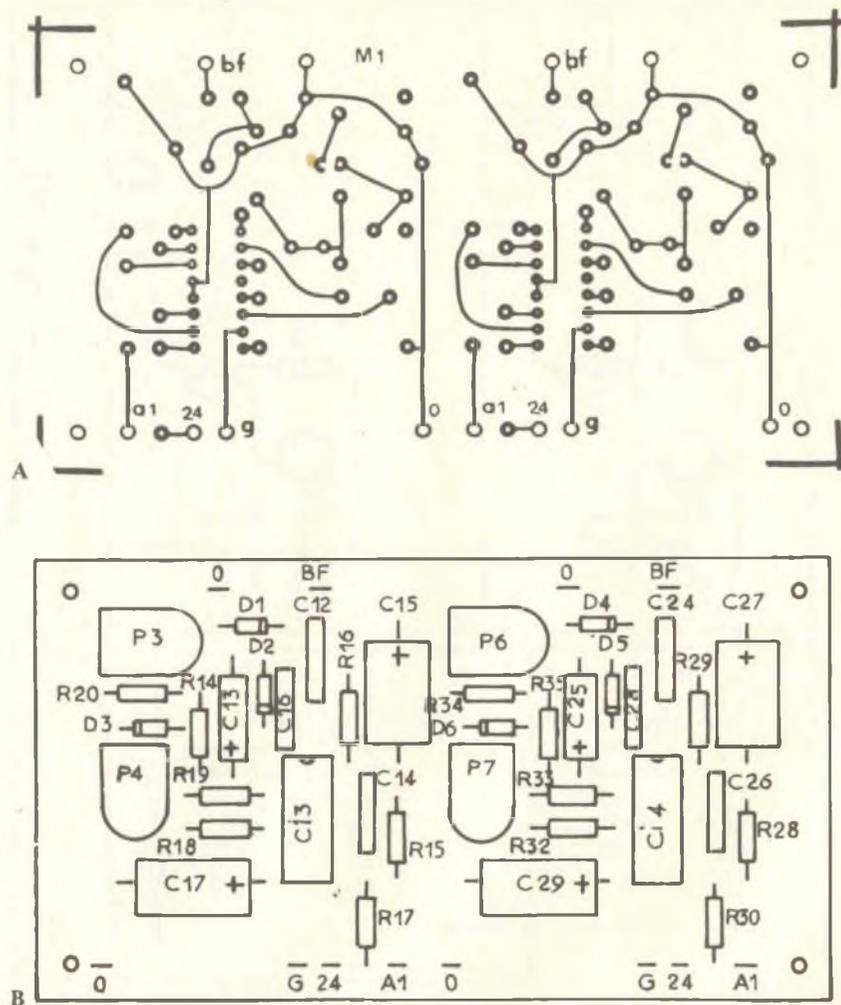
Fig. 11 - In «A» riproduzione del lato rame del circuito stampato sul quale può essere montato il modulo M1. La sezione «B» di questa stessa figura rappresenta invece la disposizione dei componenti sul lato opposto della medesima basetta.
