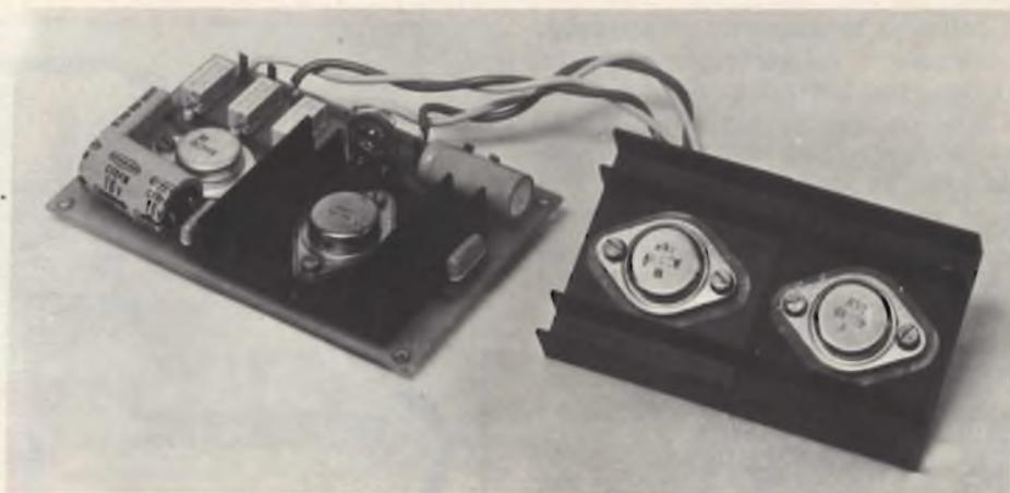
Fig. 11 - Prototipo dell'alimentatore di figura 8 a realizzazione ultimata.
