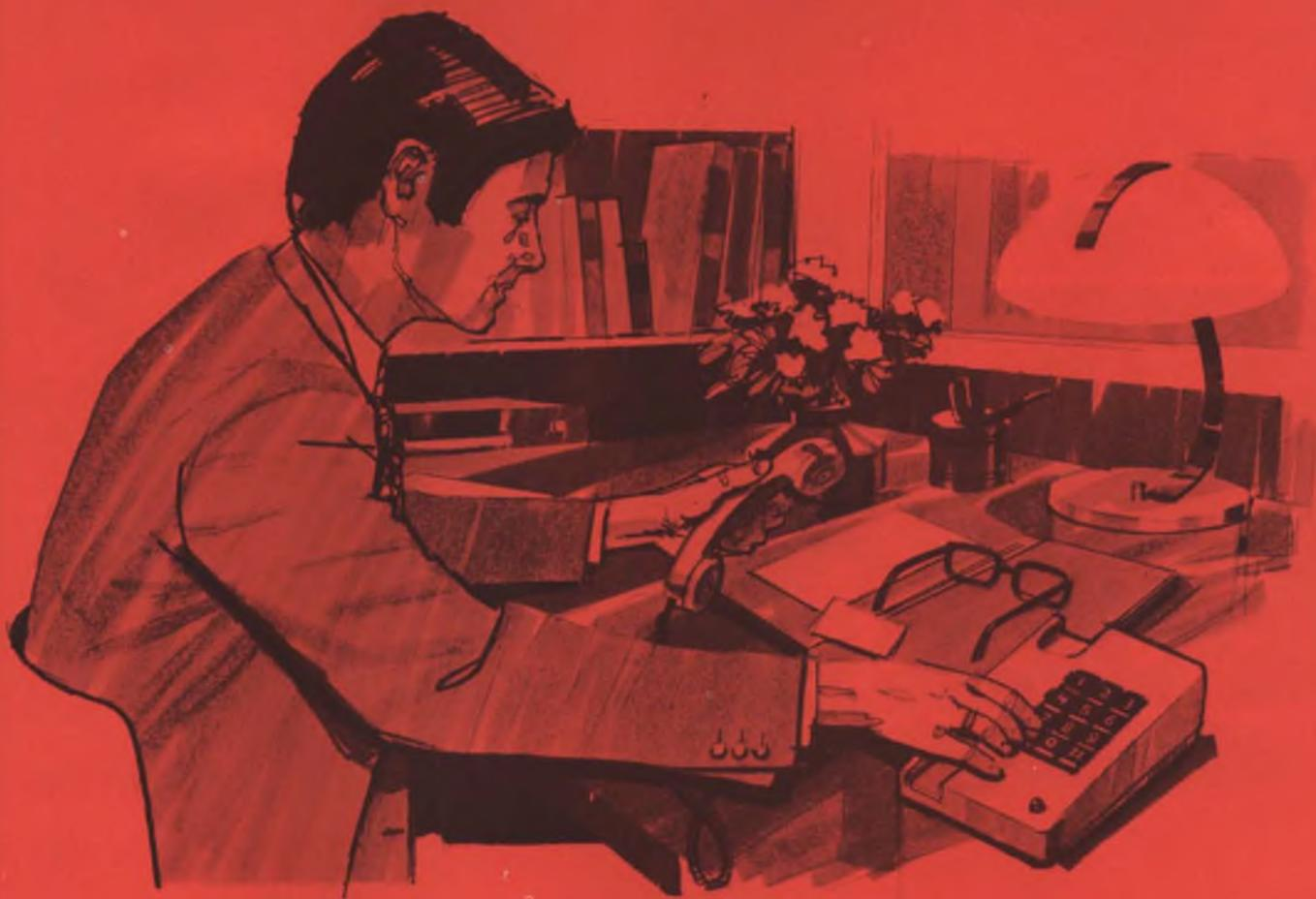
Il nuovo sistema elettronico di selezione renderà senza dubbio più confortevole l'uso del telefono. Una tastiera a 12 pulsanti sostituirà il disco di chiamata, l'utente potrà usufruire del servizio sveglia, commutare l'apparecchio sulla posizione di risposta automatica per le chiamate provenienti dall'esterno ed effettuate in sua assenza, memorizzare i numeri telefonici d'uso più frequente e richiamarli poi premendo due soli
