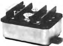
Consente un notevole risparmio di carburante, specialmente nella stagione più fredda, perché la carica ad altissima tensione fornita da questa accensione elettronica, brucia completamente ogni traccia di benzina. La velocità e la ripresa vengono aumentate di poco, ma in compenso il motore ha un funzionamento più regolare e le partenze a freddo sono immediate. KC/3000-00
