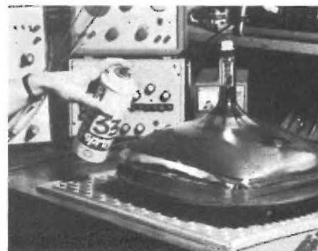
Fig. 10 - Esempio di applicazione del «Graphit-Spray 33» sul retro di un cine-scopio, per costituire uno strato perfettamente conduttivo, di notevole resistenza. Lo stesso materiale può essere usato anche per riparare schermi interrotti, e per creare effetti di schermaggio.
