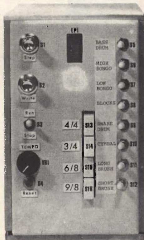
Fig. 7 - Il pannello frontale del generatore di ritmi contiene tutti i comandi necessari per consentire l'uso del dispositivo, e la regolazione del tempo fondamentale.
