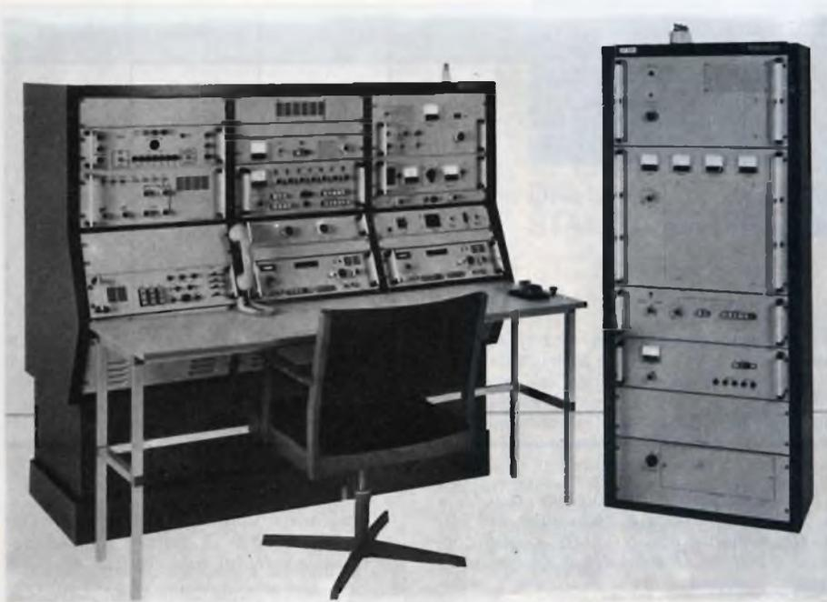
Fig. 14 - Complesso trasmettente-ricevente per navi funzionante in telegrafia e telefonia sulle gamme VHF, onde medie ed onde corte, completo di apparecchi di soccorso ed autoallarme.
