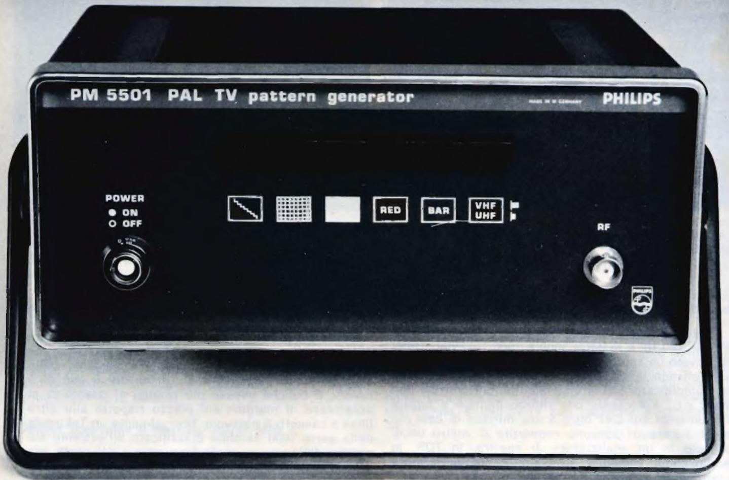
Progettato per fornire i 5 segnali di prova per l'installazione a domicilio di televisori bianco/nero e colori. Le dimensioni compatte (110x230x210) e il peso contenuto (1,25 kg) lo rendono particolarmente adatto per impieghi esterni; può essere portato nella borsa degli attrezzi. Funzionamento secondo standard CCIR 625 linee, sistema G. Barre di colore conformi al sistema PAL.
