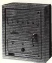
A costruzione modulare per realizzare impianti industriali, con predisposizione per il collegamento sino a 5 rivelatori a microonde ed una linea di contatti (normalmente chiusi). Allarme e preallarme sono temporizzati con tempo regolabile da 3 ÷ 10 min. ~. Alimentazione: 220 V c.a. Dimensioni: 310 x 250 x 135
