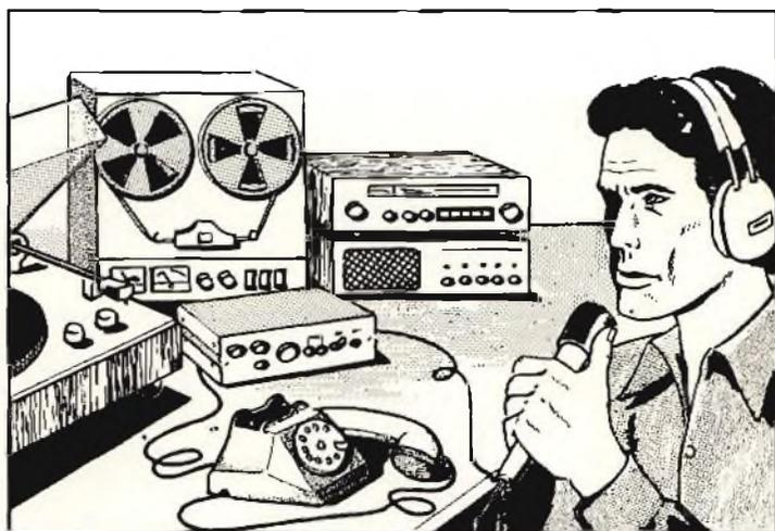
3) Rende possibile comunicare via telefono i segnali provenienti da apparecchi di ogni tipo quali giradischi, registratori, filodiffusori, radio. Mediante i regolatori di livello Aux e Micro, chi trasmette può mixare e quindi sovrapporre la propria voce per commentare, tradurre, completare l'informazione.
