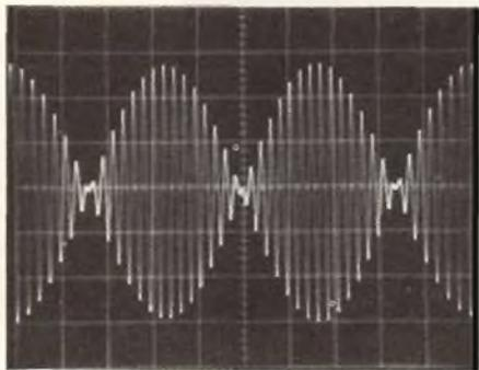
Fig. 30 - Modulazione AM del tipo «Suppressed Carrier».
