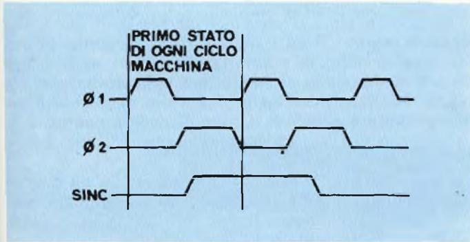
Fig. 6 - Primo stato di ogni ciclo macchina.
