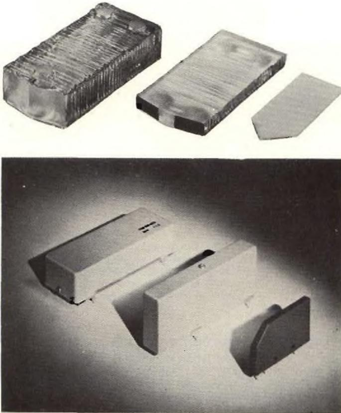
Fig. 158 - (in alto) Blocchi di vetro impiegati nelle linee di ritardo DL1, DL20 e DL50. (in basso) Le medesime munite di trasduttori PNE e contenitore.
