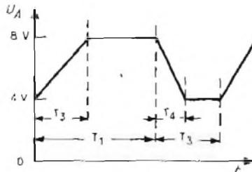
Fig. 2 - Andamento dei segnali relativi al generatore di onde trapezoidali di fig. 1.
