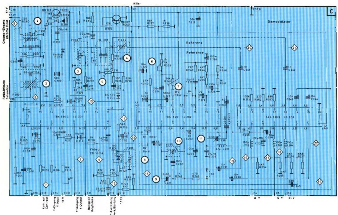
Fig. 171 - Circuiti presenti nel modulo Chroma (F). Segnali d'ingresso: C17 = segnale di crominanza a 4,43 MHz; C14 = segnale di luminanza; C12 = impulso spegnimento verticale. Segnali d'uscita: C4 = B-Y; C5 = G-Y; C6 = R-Y; C13 = segnale di luminanza. Regolazioni: C18 = saturazione; C15 = contrasto; C11 = brillantezza. Alimentazione: 12 V = C28; 7 V = C19; Massa C3.7.9. C16.
