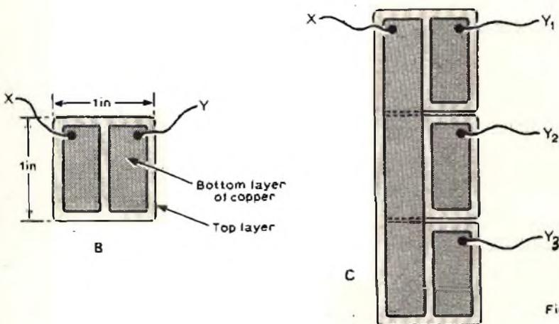
Fig. 5 - In «A» lo schema principale del commutatore a sfioramento; in «B» metodo costruttivo del sensore capacitivo, basato sull'impiego di un pezzo di circuito stampato a doppia faccia, una delle quali supporta l'elettrodo sensibile interno, mentre l'altro è diviso in due per realizzare i due valori capacitivi. In «C» è rappresentata la tecnica realizzativa di un sensore per commutazioni multiple.
