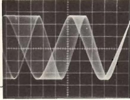
Fig. 27 - Uscita FM ( $\pm 15\%$  di modulazione).
