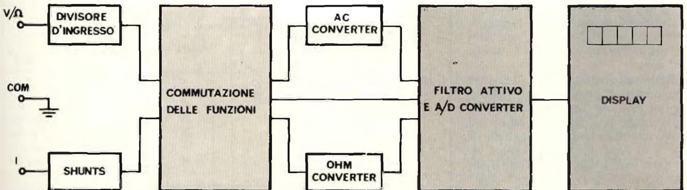
Fig. 1 - Schema a blocchi di un multimetro digitale.
