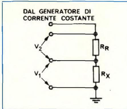
Fig. 12 - Principio di misura della conduttanza.
