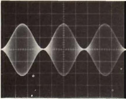
Fig. 24 - Uscita sinusoidale modulata AM (90° di modulazione).
