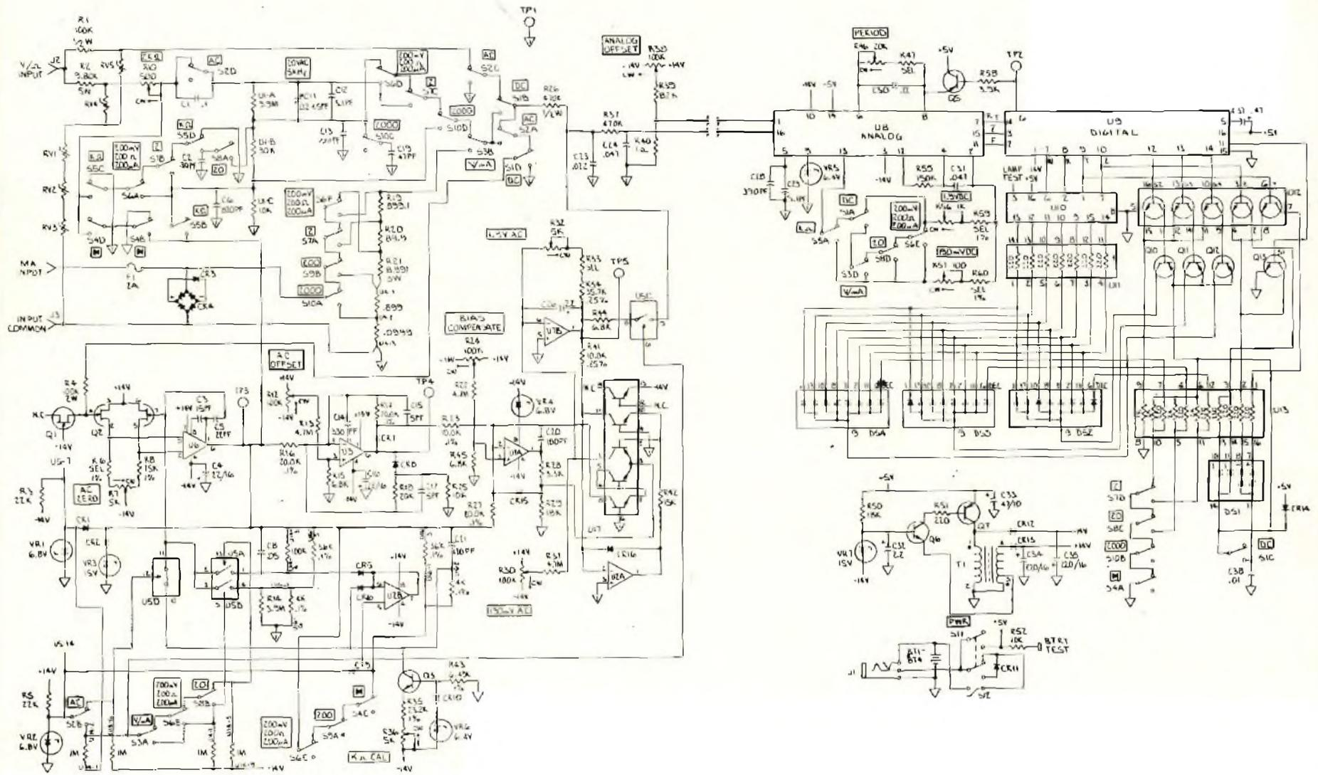
Fig. 3 - Schema completo del multimetro J. Fluke 8030 A.
