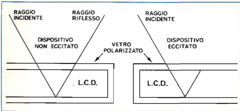
Fig. 11 - Funzionamento di un display a cristalli liquidi.
