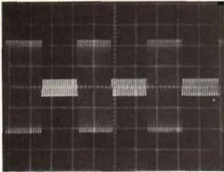
Fig. 25 - Uscita modulata AM da onde quadre.
