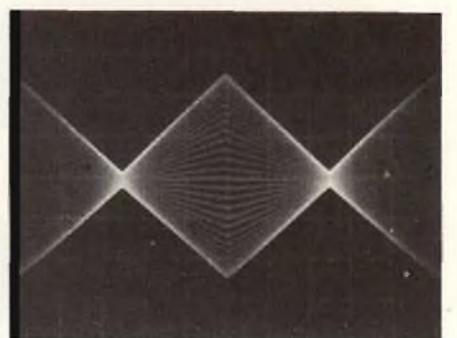
Fig. 32 - Uscita AM con modulazione a bassissima frequenza.
