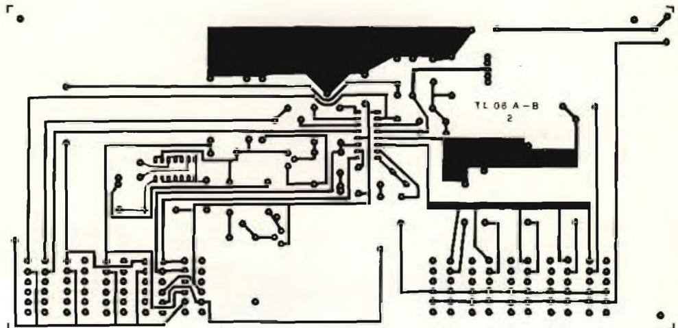
Fig. 18 - Circuito stampato del generatore di modulazione. Scala 2:1.
