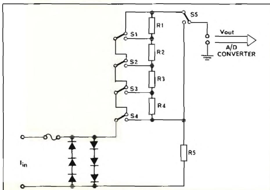
Fig. 3 - Schema di principio di uno shunt per le portate amprometriche.
