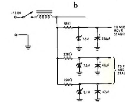
Fig. 8 - Due diversi metodi di impiego dei diodi zener, per ottenere la stabilizzazione dell'alimentazione per i soli circuiti di ricezione (a), oppure dei circuiti di ricezione e di trasmissione (b).
