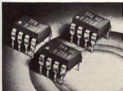
*Componente versatile per comando sensoriale a parzializzazione di fase per il controllo di luminosità di lampade.*
