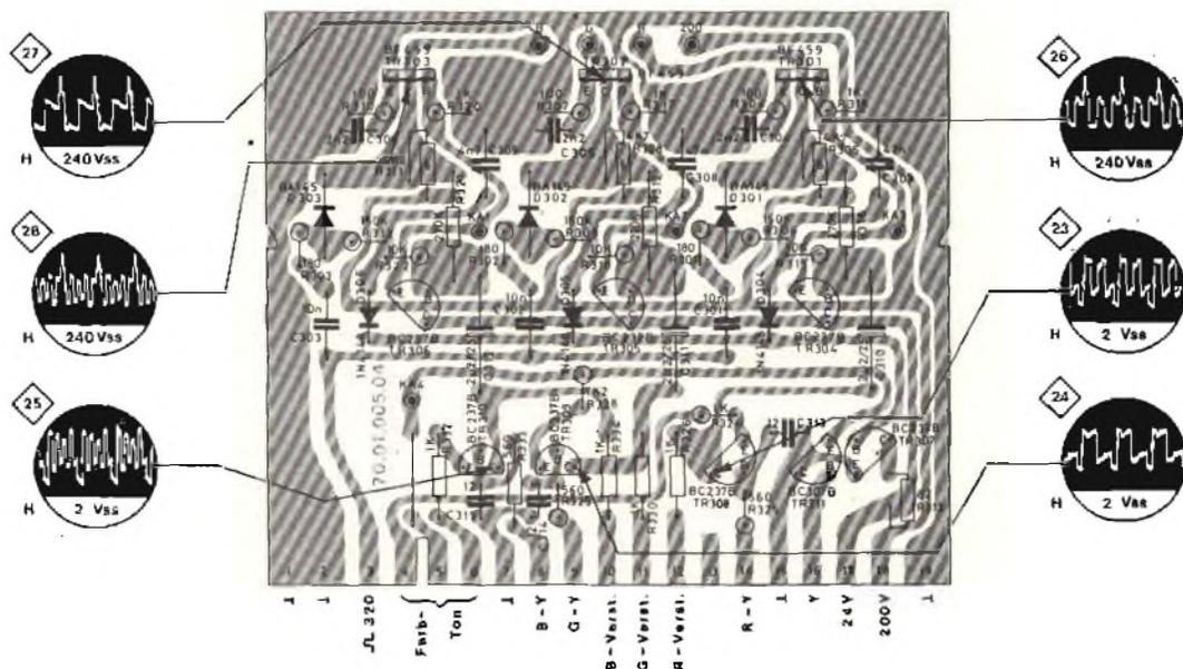
Fig. 177 - Circuito stampato del modulo RGB visto dalla parte del rame. Sono indicate gli oscillogrammi dei segnali presenti nei più importanti. Terminali 1/2/7/13/19 = massa; 3 = 320 Ω; 4/5/6 = tinta; 8 = segnale B-Y; 9 = segnale G-Y; 10 = reg. amplificatore segnale B; 11 = reg. amplificatore segnale G; 12 = reg. amplificatore segnale R; 13 = libero; 14 = segnale R-Y; 16 = segnale Y; 17 = 24 V; 18 = 200 V.
