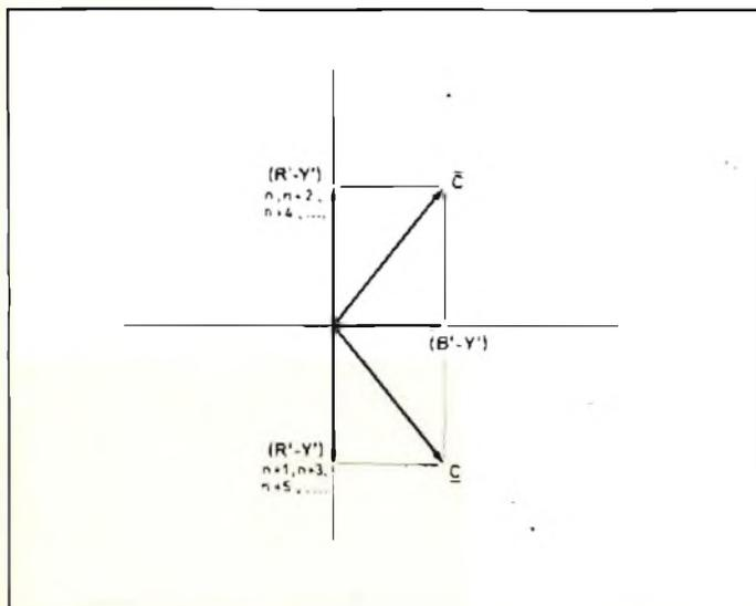
Fig. 154 - Formazione del segnale di crominanza secondo il sistema PAL. A righe alterne la sottoportante modulata da R-Y varia di  $180^\circ$ ; e pertanto il segnale di crominanza (C) risulta ribaltato di riga in riga rispetto all'asse di modulazione di B-Y.
