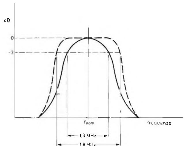
Fig. 165 - Curve di trasferimento dell'energia. A tratto pieno è indicata la curva di risposta del solo vetro (il picco massimo si ha quando  $R_1 = R_L$ ). In tratteggio è indicata la curva di risposta che si ha in seguito all'aggiunta dell'induttanza esterna.
