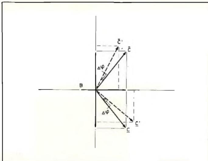
Fig. 155 - Effetto di un errore (o spostamento) di fase  $\Delta\phi$  sul segnale di crominanza PAL. Questo errore sposta, ovviamente, nella stessa direzione anche il vettore del segnale di crominanza della riga ribaltata.
