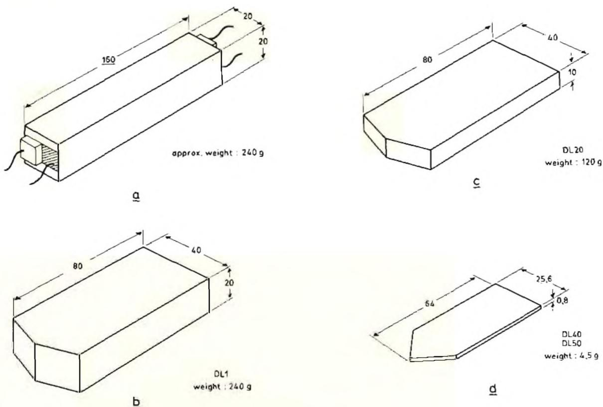
Fig. 157 - Varie forme assunte dalla linea di ritardo PAL. Si noti la progressiva diminuzione delle dimensioni del mezzo in cui si propagano le onde ultrasonore e cioè del vetro (dimensioni in mm.)
