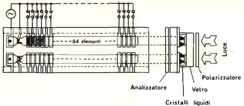
Fig. 3 - Struttura dell'indicatore di picco a cristalli liquidi.
