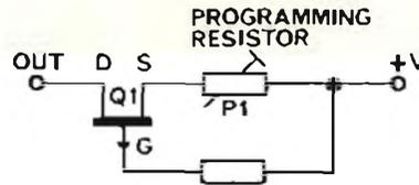
Fig. 6 - Principio di funzionamento di un generatore di corrente costante.
