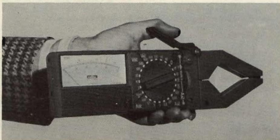
Il modello **MX 478** è protetto con dei fusibili e un disgiuntore resettabile da pannello, può misurare capacità ed è alloggiato in un contenitore metallico.
