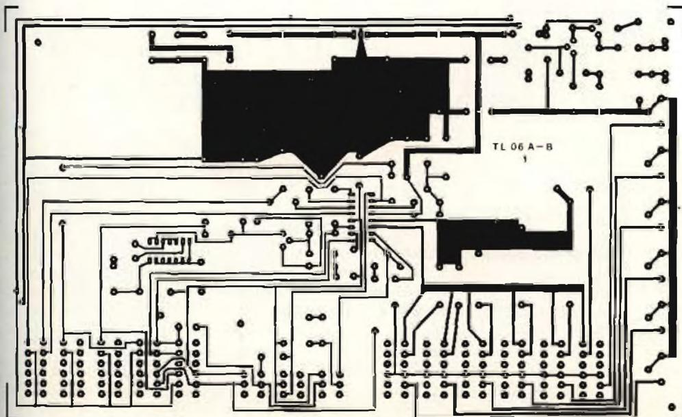
Fig. 16 - Circuito stampato del generatore primario che comprende anche l'alimentazione.
