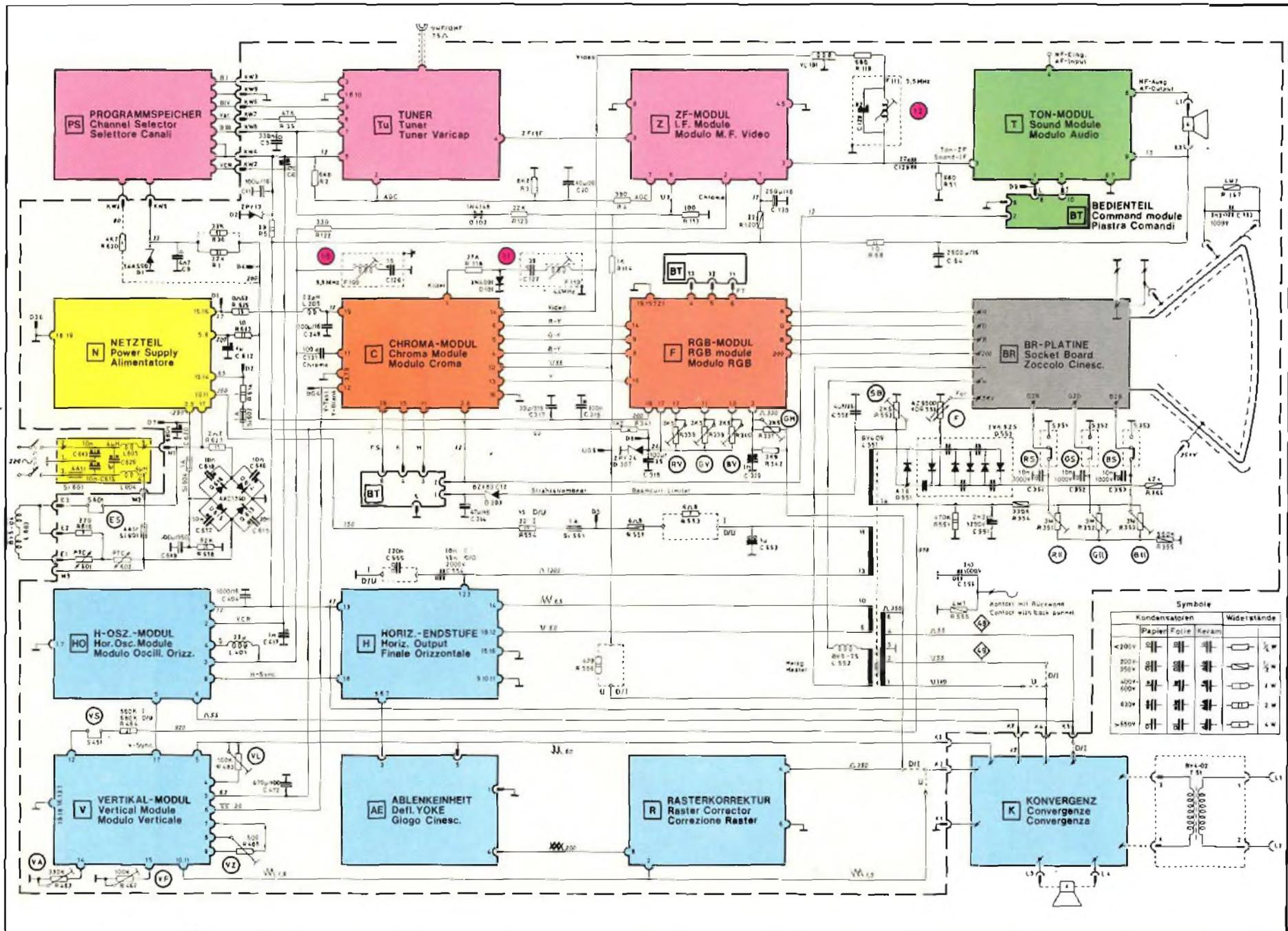
Fig. 167 - Schema a blocchi completo del televisore UT 3040 GBC. In rosso è indicata la sezione crominanza costituita dai moduli C (Chroma) e F (RGB); in giallo è indicato l'alimentatore; in verde la sezione audio; in blu la sezione deflessione di riga e di quadro e le correzioni della convergenza e del cuscino (raster); in viola le sezioni R.F. e F.I.
