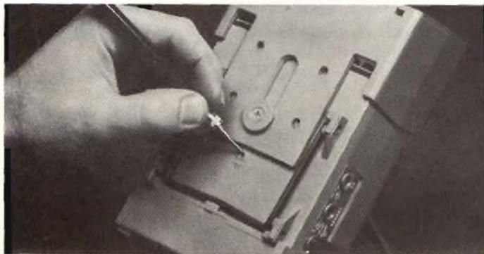
Fig. 1 - Controllo della tensione delle batterie dell'8030 A.
