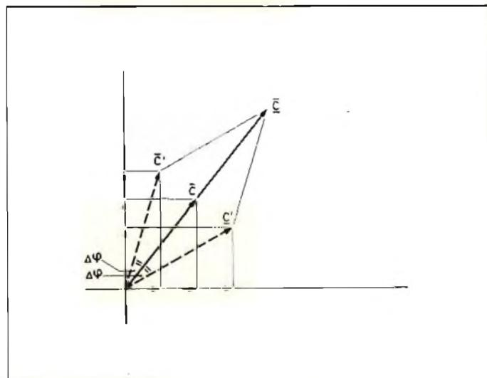
Fig. 156 - Compensazione dell'errore di fase secondo il sistema PAL. Ribaltando nuovamente il vettore  $C'$  e sommandolo a quello della riga precedente (vettore  $C$ ), è possibile ridare al vettore  $C$  la posizione angolare con cui era stato trasmesso (viene cioè eliminato l'errore di fase  $\Delta\phi$ ). Risulta solo aumentato in ampiezza, si ha cioè un aumento della saturazione del colore, in genere, non avvertito dall'occhio.
