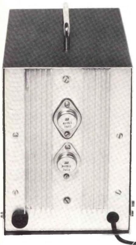
Vista del pannello posteriore dello strumento comprendente i transistori di potenza.
