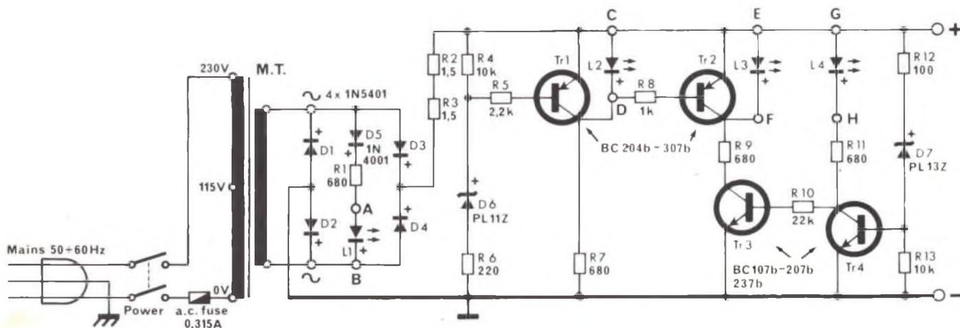
Fig. 1 - Circuito elettrico del caricabatterie automatico OK 481.
