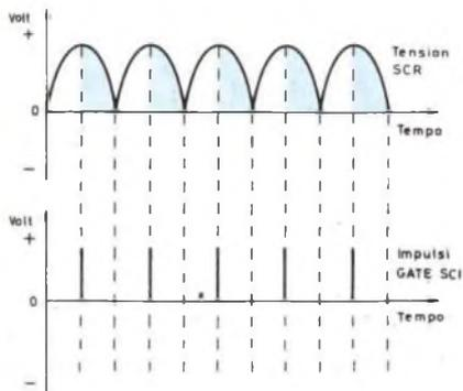
Fig. 10-A - Risposta di un circuito parzializzatore impiegante un Thyristore.
