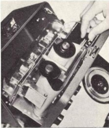
Fig. 13 - Siamo sempre nel campo delle nuove professioni. Messa a punto di un moderno apparecchio per ecoscandaglio ultrasonoro (FURUNO, MARK-3, della S.I. R.M.).
