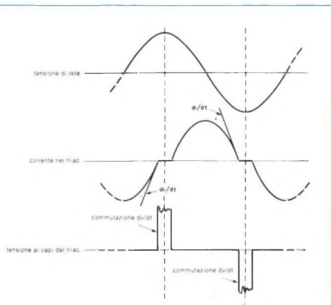
Fig. 8 - Forma d'onda caratteristica di un TRIAC con carico induttivo. Si noti il fronte ripido di tensione a cui è assoggettato il TRIAC (commutazione  $dV/dt$ ) e levata.
