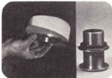
Fig. 12 - Questa serie di fotografie mettono in evidenza come deve essere eseguito il fissaggio, alla chiglia di una barca, del trasduttore per un ecoscandaglio ultrasonoro.
