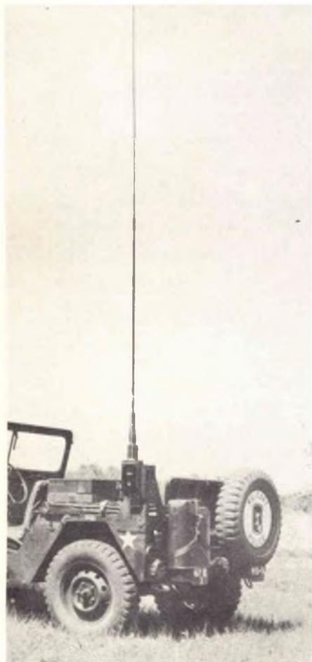
Fig. 8 - Una robusta antenna per installazione su veicoli destinati a percorsi molto accidentati.
