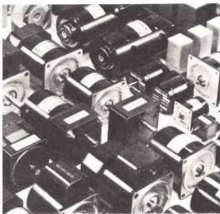
Fig. 1 - La foto illustra numerosi esemplari di motorini elettrici sincroni a corrente alternata, che ancora oggi costituiscono l'oggetto di elevate richieste di mercato, per la produzione di giradischi di tipo economico, e di centri-musica.
