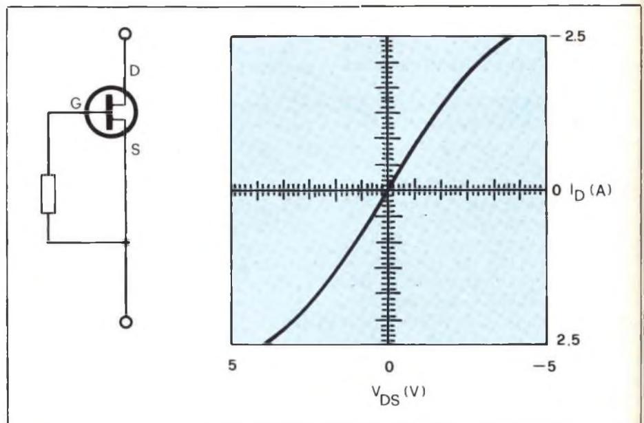
Fig. 7 - Curva caratteristica di un FET Verticale tracciata per  $V_{GS} = 0$  (in orizzontale la tensione fra Drain e Source, in verticale la corrente di Drain). Notare la linearità sia per correnti dirette sia per correnti inverse.
