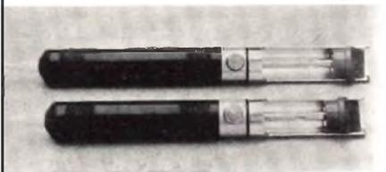
**Dissaldatore con pompa aspirante**
