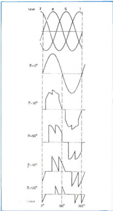
Fig. 24 - Forme d'onda relative al triac TH (R) confrontate con le tensioni delle varie fasi. B = angolo d'innescio.
