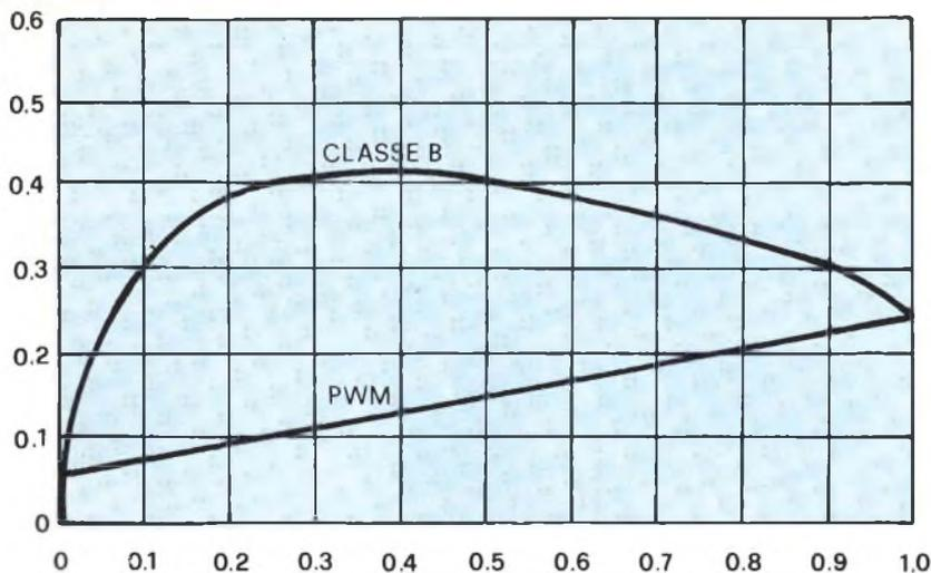
Fig. 8 - Dissipazione in potenza fra un amplificatore convenzionale in classe B ed un amplificatore PWM. Il grafico è ricavato sperimentalmente da due prototipi. In ascissa la potenza fornita al carico come frazione della potenza massima, in ordinata la potenza dissipata sempre come frazione della potenza massima.
