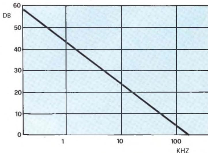
Fig. 5 - Livello di contoreazione (espresso sull'asse delle ordinate in decibel) in funzione della frequenza in un amplificatore PWM con portante a 500 kHz.
