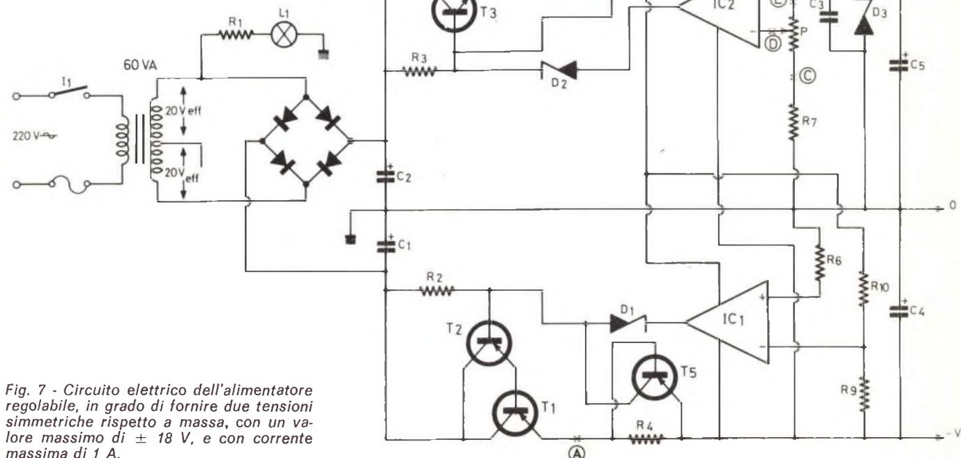
Fig. 7 - Circuito elettrico dell'alimentatore regolabile, in grado di fornire due tensioni simmetriche rispetto a massa, con un valore massimo di  $\pm 18$  V, e con corrente massima di 1 A.
