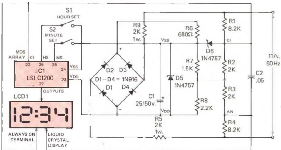
Fig. 5 - Questo secondo schema rappresenta l'unità integrata C1200, ed i componenti necessari esterni, facenti parte dell'orologio.
