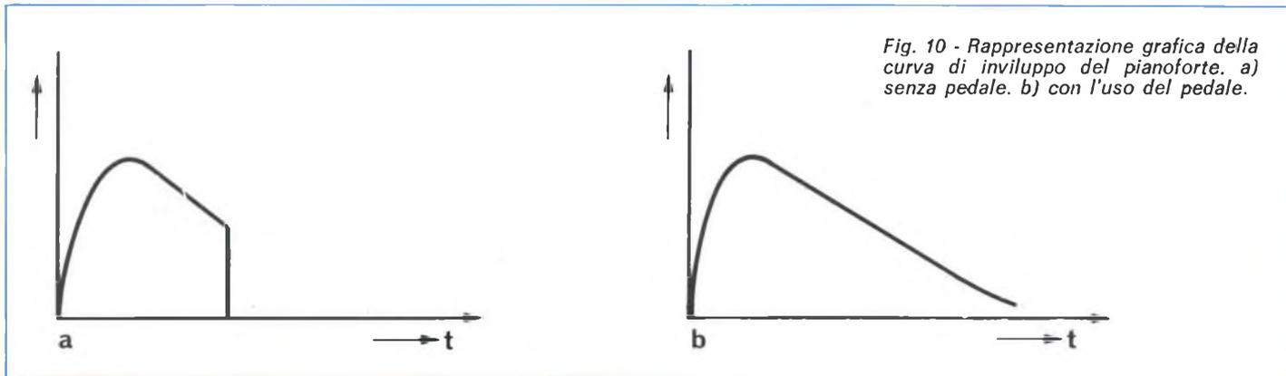
Fig. 10 - Rappresentazione grafica della curva di inviluppo del pianoforte. a) senza pedale. b) con l'uso del pedale.
