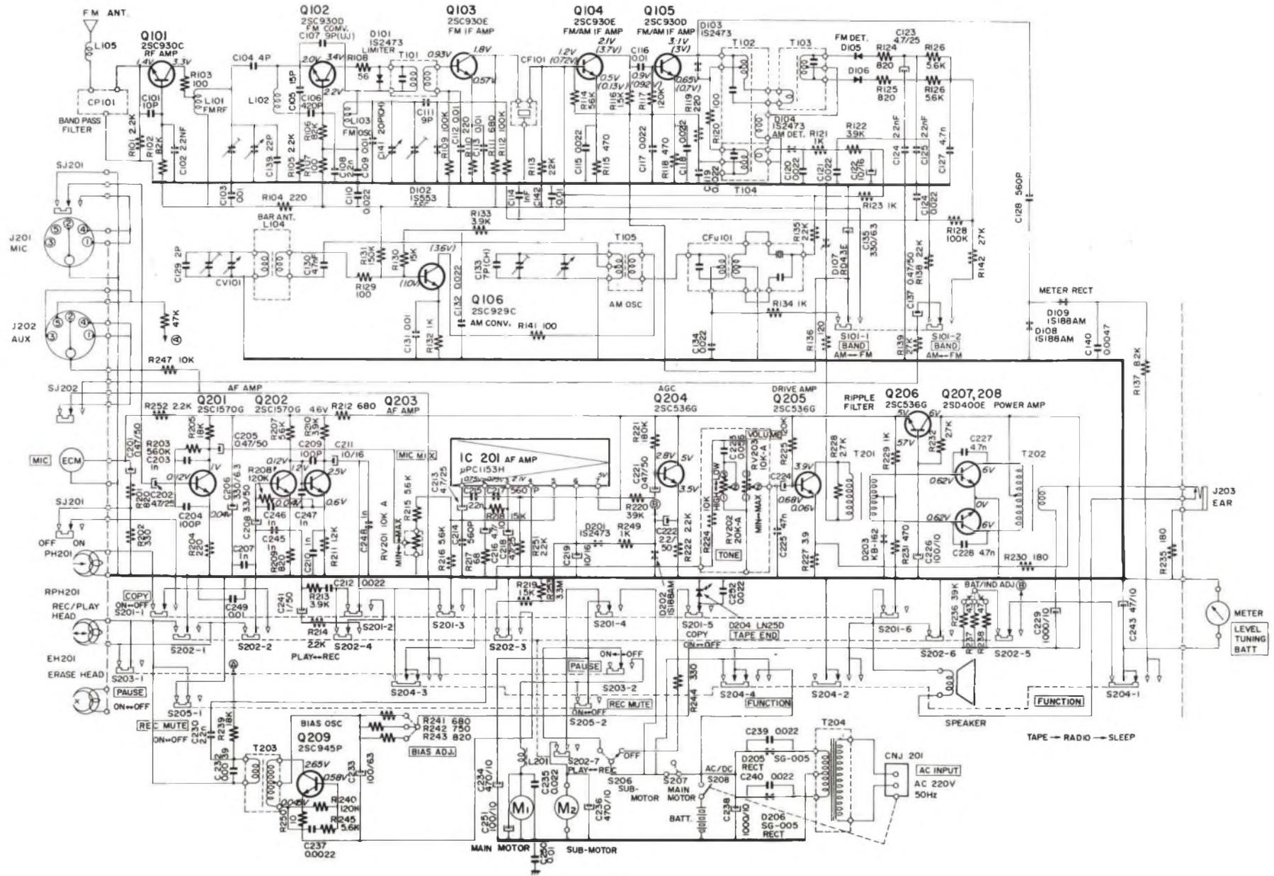
Fig. 3 - Schema elettrico completo del radio-registratore, recante anche i valori di tutti i componenti che ne fanno parte.
