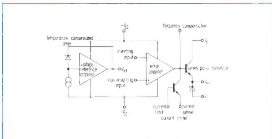
Fig. 2 - Schéma a blocchi del regolatore L123 (723).
