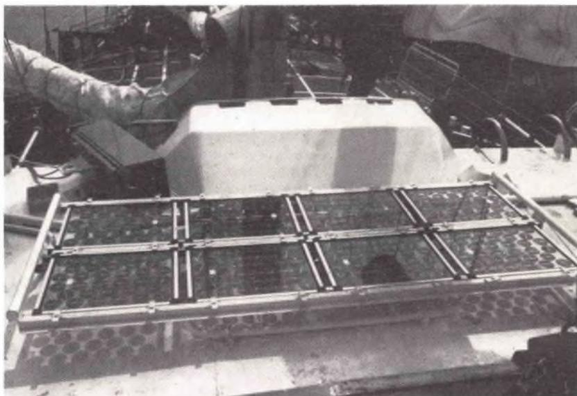
Il modulo BPX 47 A trasforma direttamente l'energia solare in energia elettrica. Contiene 34 celle al silicio collegate in serie; ogni cella ha un diametro di 57 mm. Lo spessore del modulo è 15 mm. La tensione d'uscita è prelevabile tramite cavetto a due conduttori lungo 1 m e con diametro di 5,5 mm. Il conduttore nero è quello a polarità negativa; quello rosso, a polarità positiva. Il peso complessivo del pannello è 2,4 kg.
