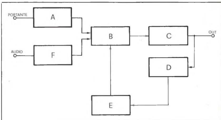
Fig. 4 - Ancora un diagramma a blocchi, nel quale, oltre a raffigurare le funzioni già descritte in fig. 3, viene descritta l'introduzione di un anello generale di contoreazione; A - integratore; B - mescolatore; C - amplificatore saturante; D - invertitore di fase; E ed F - integratori.
