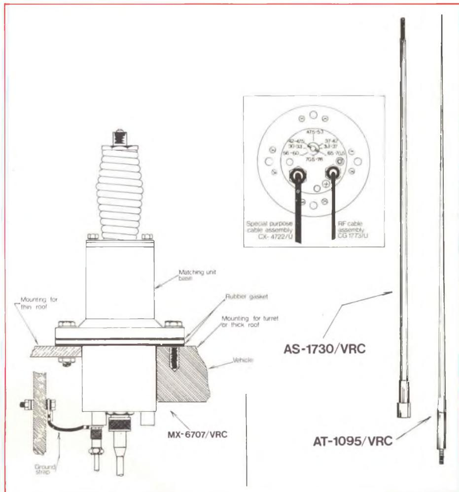
Fig. 9 - Metodo di installazione dell'antenna del tipo illustrato in figura 8.
