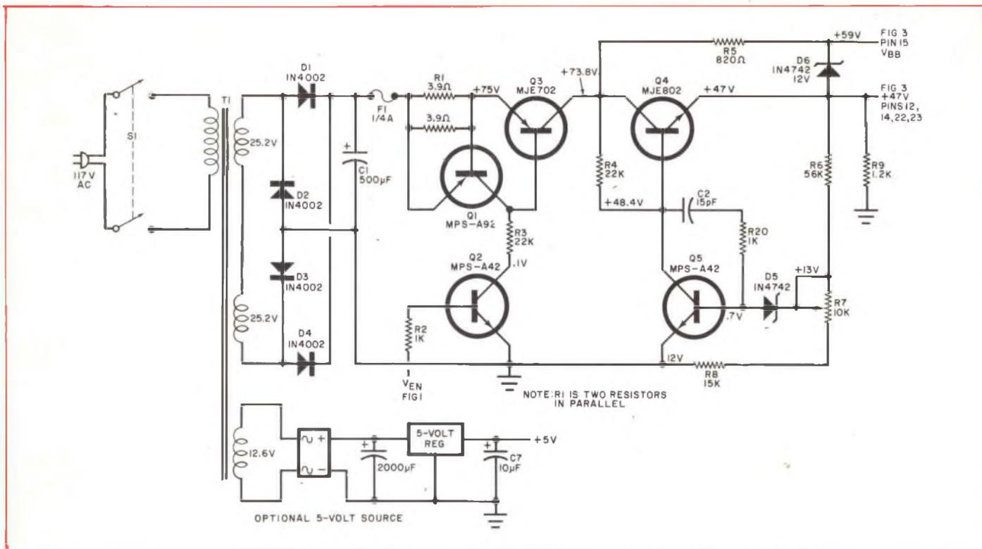
Fig. 11 - Questo è l'alimentatore che viene descritto per completare la realizzazione del programmatore «Eprom» di tipo economico: abbiamo fornito questa descrizione unicamente in quanto l'alimentatore presenta numerosi aspetti interessanti anche per altre applicazioni.
