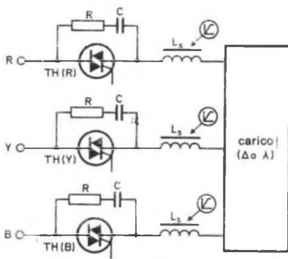
Fig. 22 - Sezione di potenza del sistema di controllo a parzialeizzazione di fase della potenza in ca.  $R = 33 \Omega$ , 2 W;  $C = 0,1 \mu F$  1600 Wcc;  $L_s = 3$  mH.
