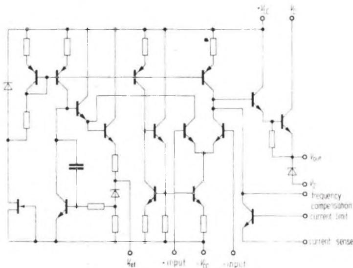
Fig. 1 - Circuito elettrico interno dell'integrato L123 (723).
