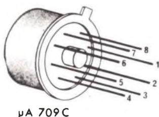
Fig. 3 - Disposizione dei terminali dei semiconduttori impiegati.
