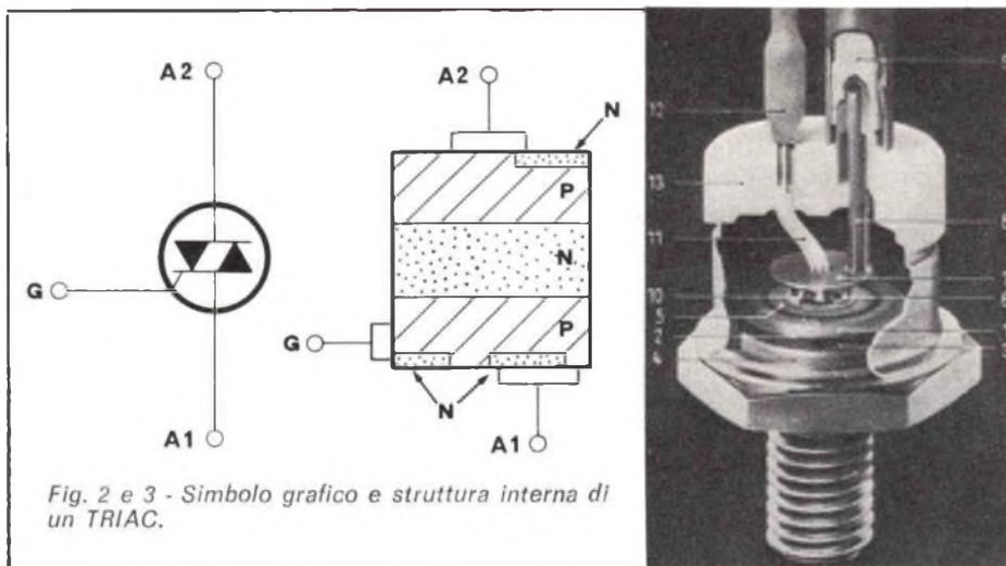
Fig. 2 e 3 - Simbolo grafico e struttura interna di un TRIAC.
