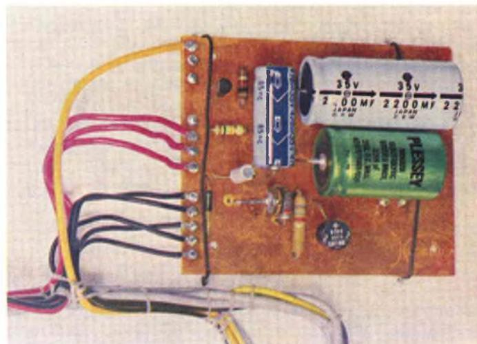
Fig. 12 - Fotografia della sezione di alimentazione, che fornisce all'intero strumento le tensioni necessarie per il loro regolare funzionamento.
