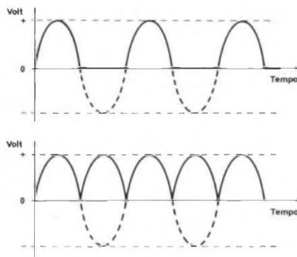
Fig. 9-A - Conduzione sincrona del Thyristore.
