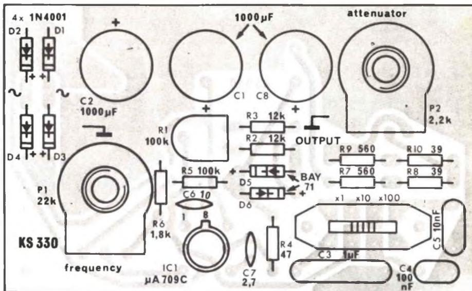
Fig. 2 - Basetta stampata e disposizione dei componenti del gener. di onde quadre.
