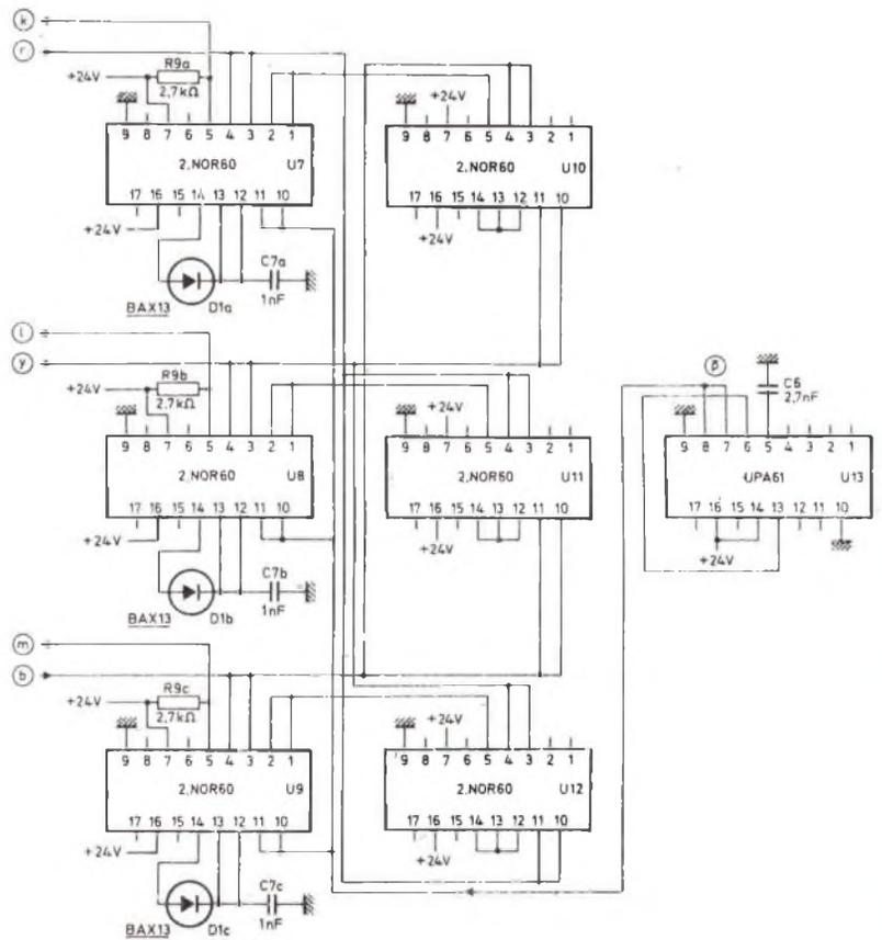
Fig. 26 - Cablaggio della sezione logica del sistema.
