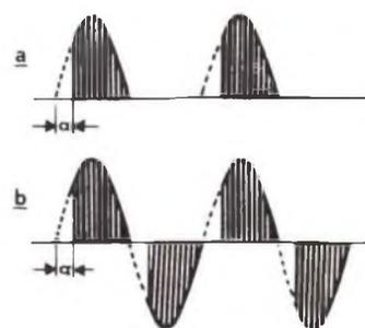
Fig. 10 - Sistema di controllo a parzializzazione di fase.
