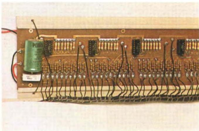
Fig. 7 - La foto rappresenta l'aspetto dei divisori di frequenza, con i quali si ottengono le ottave inferiori.
