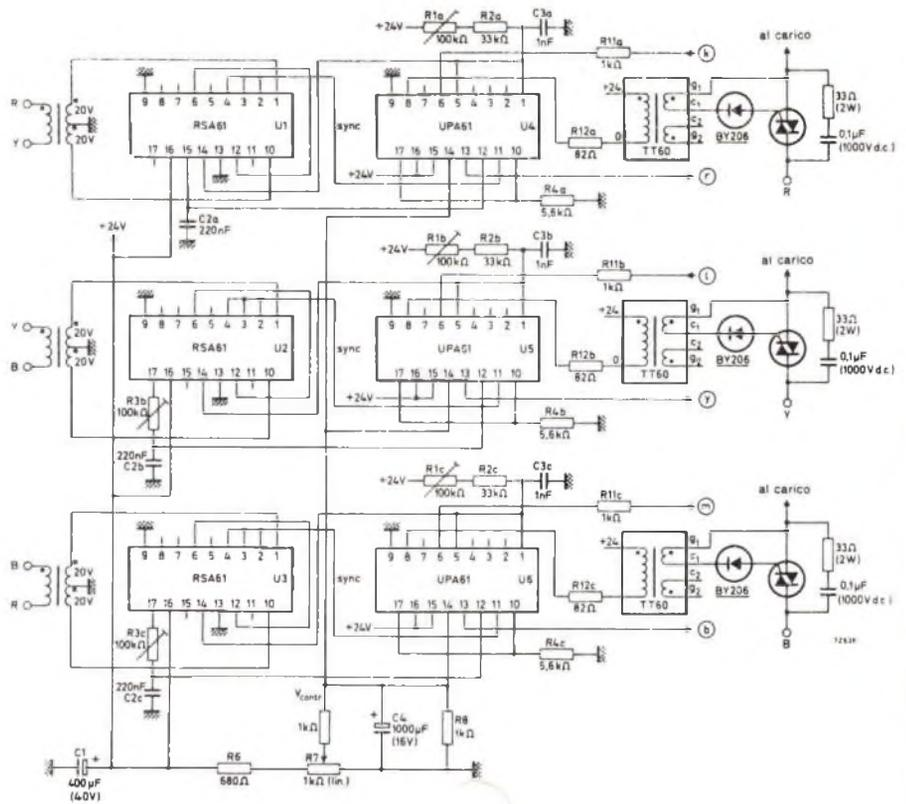
Fig. 25 - Cablaggio della sezione sfasatrice e di quella che fornisce gli impulsi di innescio ai triac. I triac impiegati possono essere il BTX 94-1200 oppure il BTW 34-1200.
