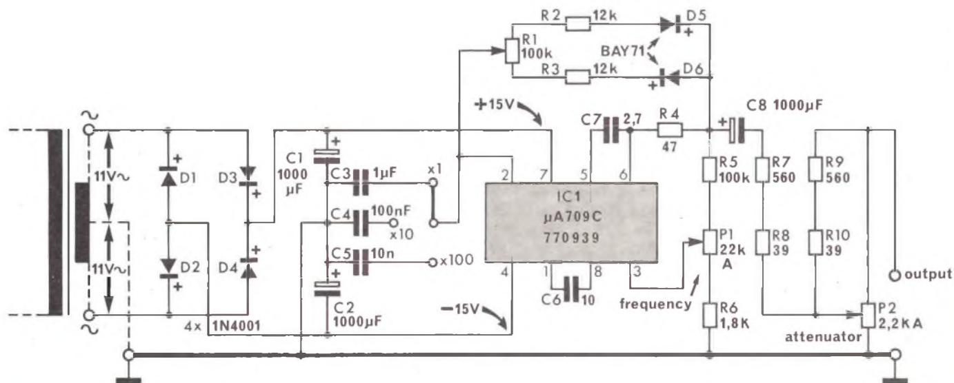
Fig. 1 - Schema elettrico del generatore di onde quadre.
