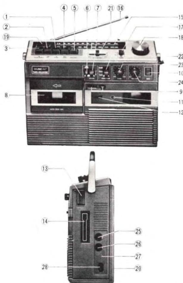
Fig. 1 - Vista frontale e laterale del radio-registratore «Music Air» Modello MCR-770, con identificazione numerica di tutti i dispositivi di comando e di controllo.
