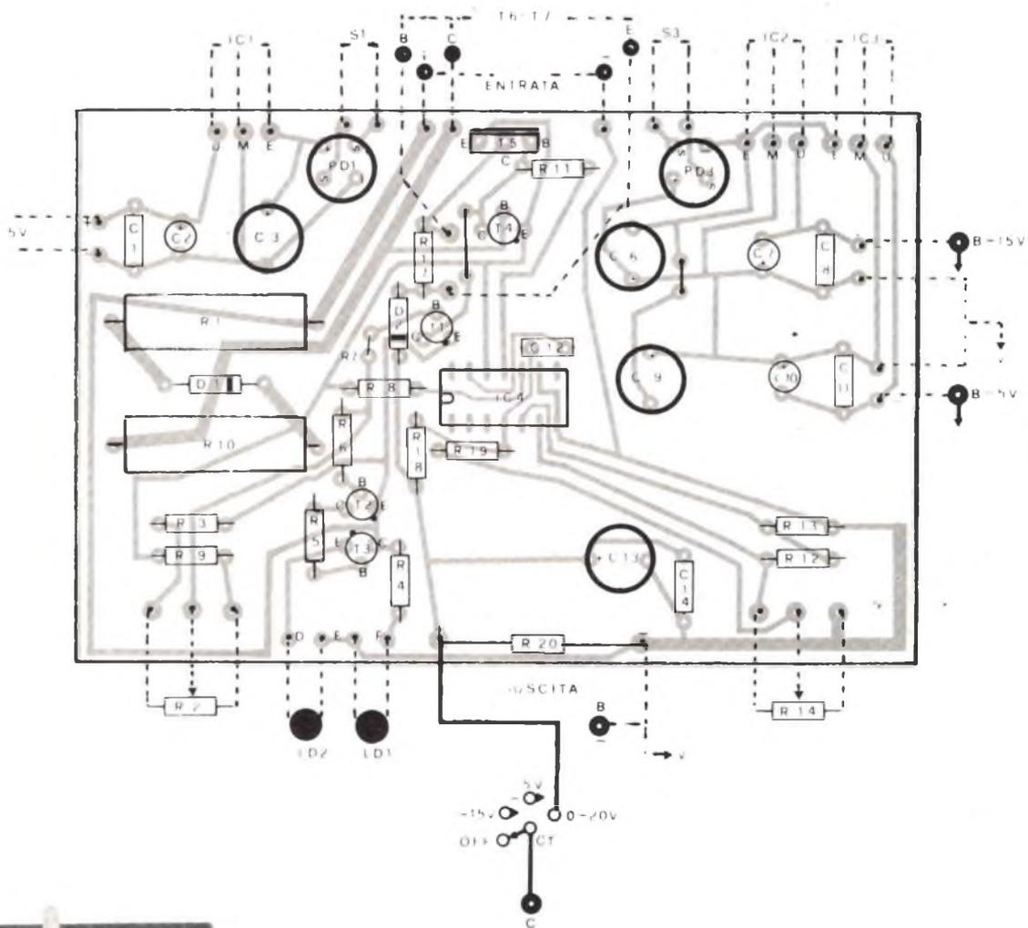
Fig. 5 - Disposizione dei componenti dell'alimentatore sulla basetta a C.S.
