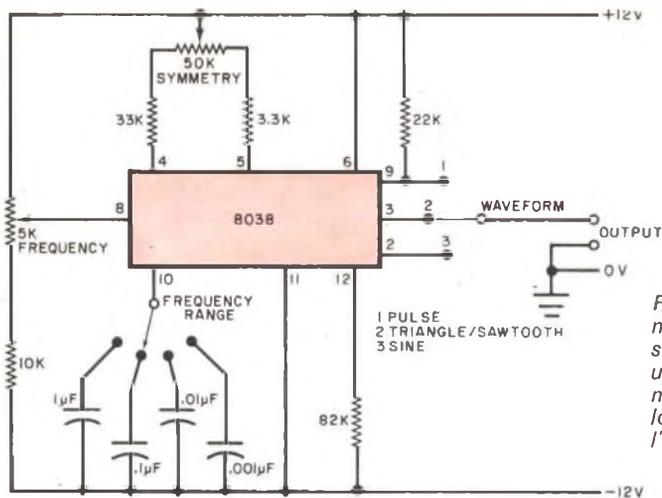
Fig. 10 - Circuito del generatore supplementare di segnali che può essere usato per ottenere le numerose riproduzioni oscillografiche riportate nell'articolo.
