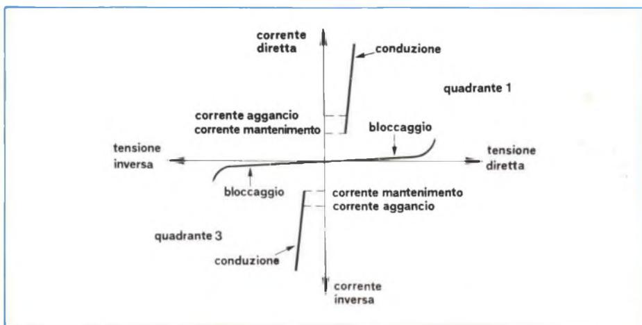
Fig. 6 - Curve caratteristiche di un TRIAC. Il funzionamento nel primo quadrante si ha quando il terminale  $A_2$  si trova a potenziale più elevato del terminale  $A_1$ ; il funzionamento nel terzo quadrante quando il terminale  $A_2$  si trova ad un potenziale più basso rispetto al terminale  $A_1$ .
