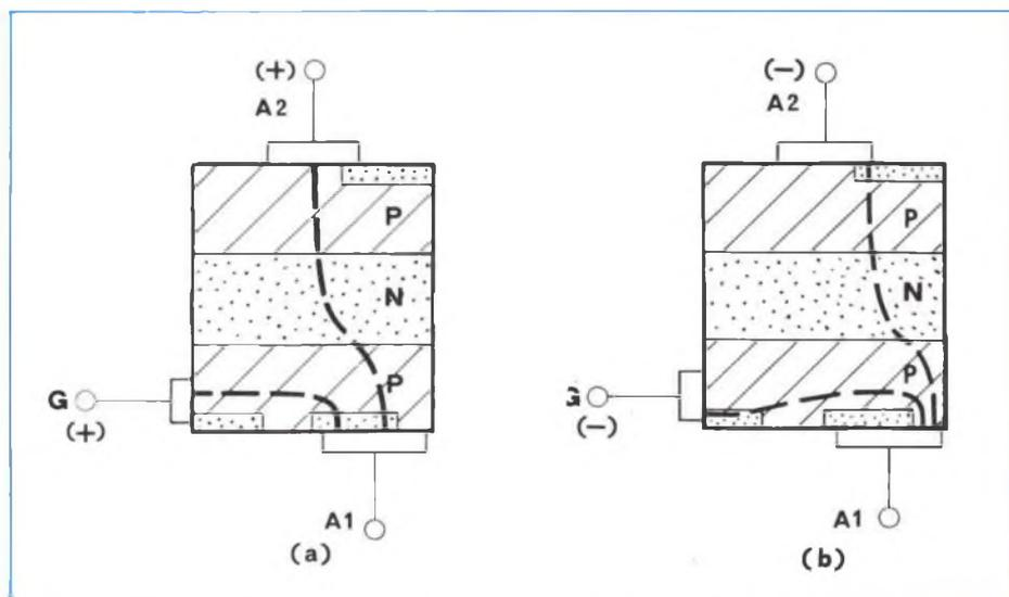
Fig. 4 - Entrata in conduzione di un TRIAC mediante applicazione di una tensione d'insieme Positiva all'elettrodo di controllo (gate); in a) la corrente di elettroni è diretta da A<sub>1</sub> ad A<sub>2</sub>; in b) da A<sub>2</sub> a A<sub>1</sub>.
