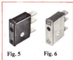
**Serie P-4.** Particolarmente impiegato nelle telecomunicazioni ed in elettronica industriale, ha 4 terminali ed il circuito principale è separato dal circuito d'allarme. Isolamento in policarbonato. Dieci valori di corrente nominale: da 0,3 A a 15 A (fig. 6). Per le due serie il potere d'interruzione a 220 Vc.a.: 2500 A, a 250 Vc.c.: 1500 A.
