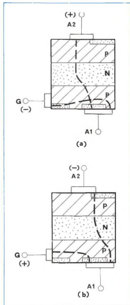
Fig. 5 - Entrata in conduzione di un TRIAC mediante applicazione di una tensione negativa all'elettrodo di controllo (gate); in a) la corrente di elettroni è diretta da A<sub>1</sub> a A<sub>2</sub>; in b) da A<sub>2</sub> a A<sub>1</sub>.
