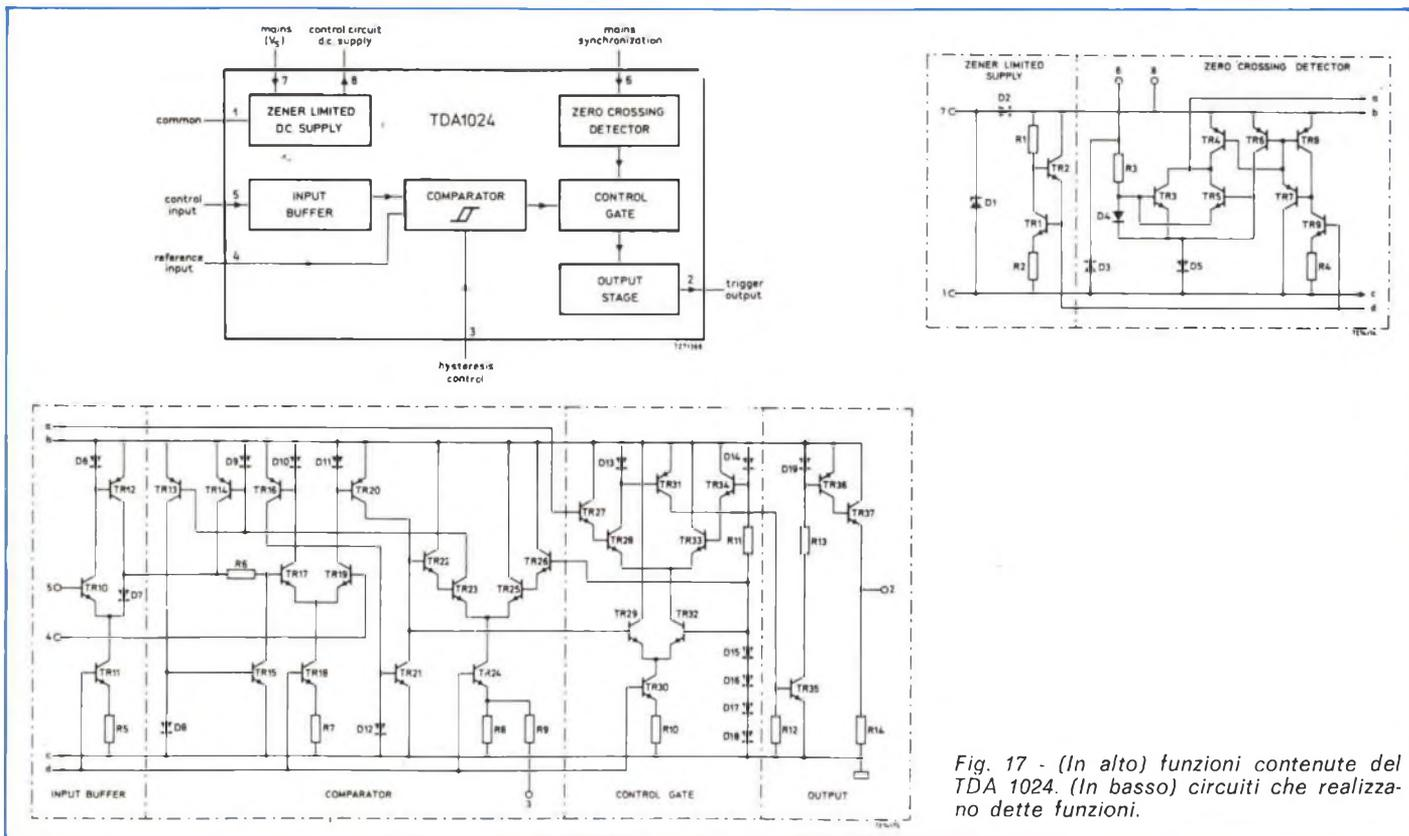
Fig. 17 - (In alto) funzioni contenute del TDA 1024. (In basso) circuiti che realizzano dette funzioni.
