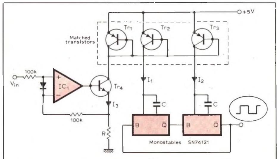
Fig. 1 - Schema elettrico dell'oscillatore lineare a controllo di tensione, in grado di funzionare con una tensione di alimentazione di soli 5 V, positivi rispetto a massa.
