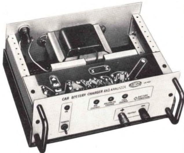
Vista interna del caricabatterie con analizzatore.
