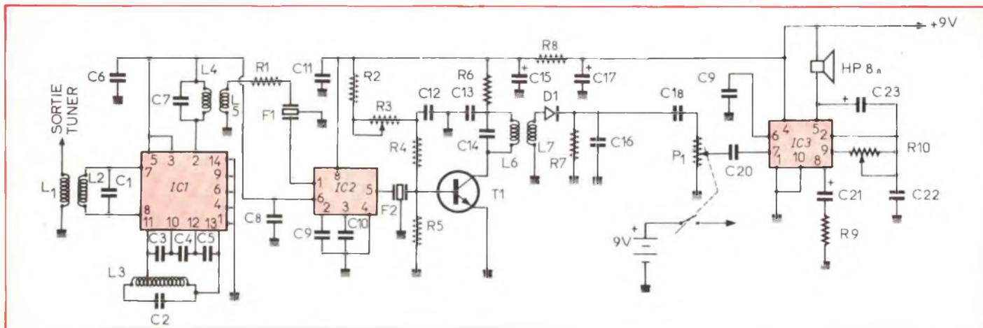
Fig. 8 - Circuito completo del ricevitore mediante il quale è possibile ascoltare il suono delle trasmissioni televisive.
