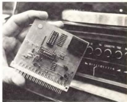
Il telecomando ad infrarossi della Siemens consente il controllo di quattro funzioni analogiche.
