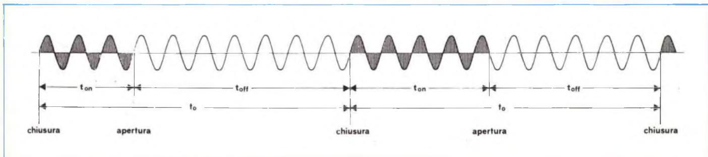
Fig. 11 - Sistema di controllo proporzionale nel tempo. Il periodo di ripetizione  $t_0$  è fisso ed è formato da  $t_{\text{on}} + t_{\text{off}}$ . Il sistema fa in maniera che  $t_{\text{on}}$  vari a seconda delle esigenze del carico.
