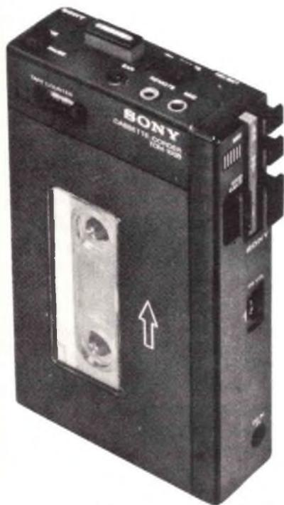
Fig. 2 - Esempio di registratori Sony di minime dimensioni, nel quale viene impiegato un motorino elettrico senza nucleo, con notevoli vantaggi agli effetti delle dimensioni, del peso e del consumo di energia.
