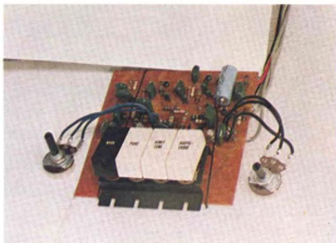
Fig. 11 - Il compito dei filtri qui illustrati consiste nel sopprimere o nell'accentuare parte delle frequenze contenute nel segnale, allo scopo di simulare in modo realistico la natura del timbro scelto attraverso i comandi di registro.
