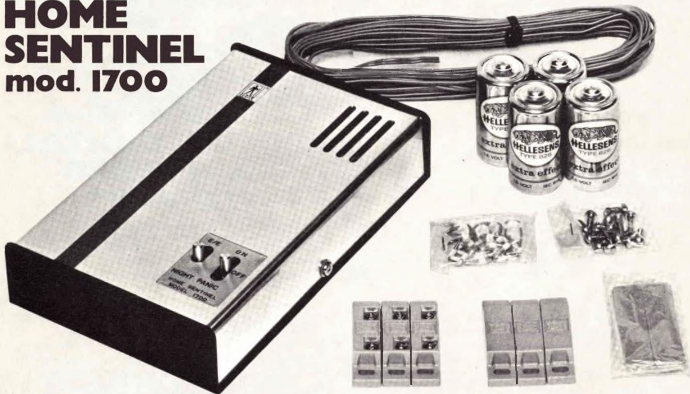
Di facile installazione, la centralina è alimentata a 6 Vc.c. con 4 pile a secco di lunga durata. Grazie all'integrato, impiegato nel suo circuito interno, essa presenta notevoli caratteristiche di sicurezza ed affidabilità. Utilizza come sensori dei contatti magnetici normalmente chiusi; l'intervento è di tipo ritardato all'ingresso ed all'uscita di 45 s.
