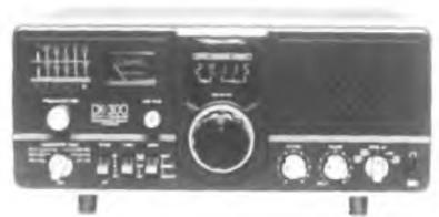
Ricevitore per le frequenze da 10 kHz a 30 MHz.
