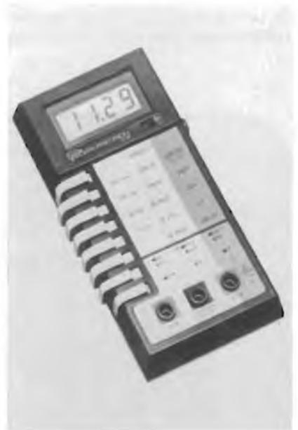
Multimetro digitale con display LCD e allarme sonoro.
