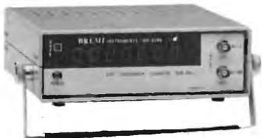
Frequenzimetro digitale per la gamma di frequenza da 1 Hz a 220 MHz.
